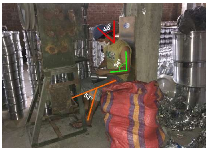
Figura 41. Puesto de remachado de base de ollas
