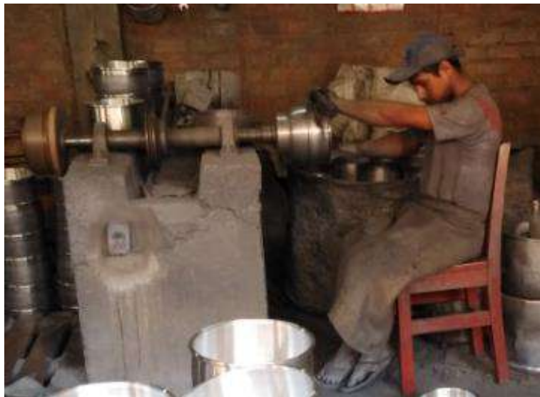
Figura 46. Diseño actual de puesto de trabajo de la Etapa de Pulido de base de ollas
