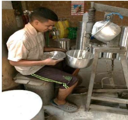
Figura 23. Etapa de Remachado de tapas
