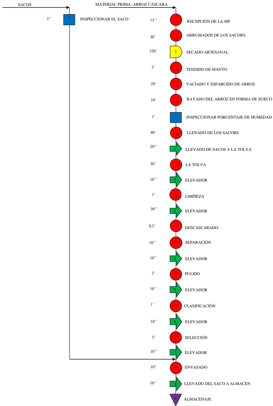
Figura N°26: Diagrama de Análisis de Proceso de pilado de arroz con la nueva máquina de secado.
