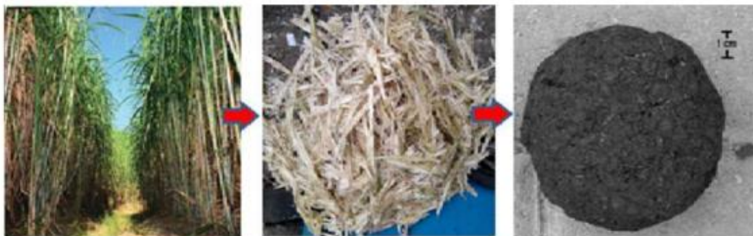
Imagen 3 Diferentes estados del material, de izquierda a derecha: caña de azúcar, bagazo de caña, ceniza [19]
