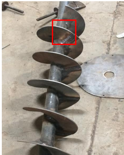
Fig. 12 Resultado del proceso de soldadura y emparejamiento
