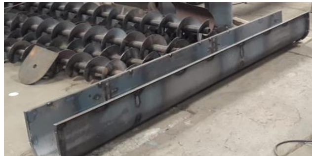
Fig. 5 Secciones del canal soldadas
