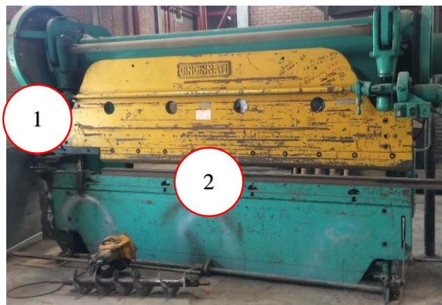
Fig. 145. Lados operables de la plegadora
