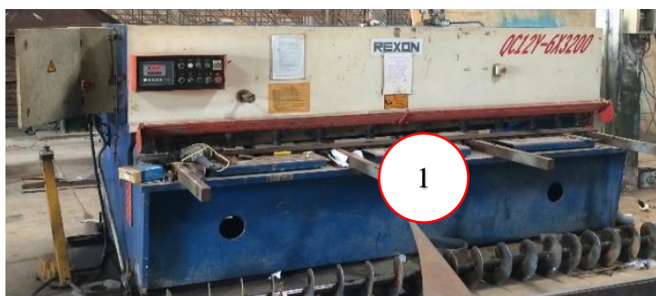
Fig. 144. Lado operable de la Guillotina
