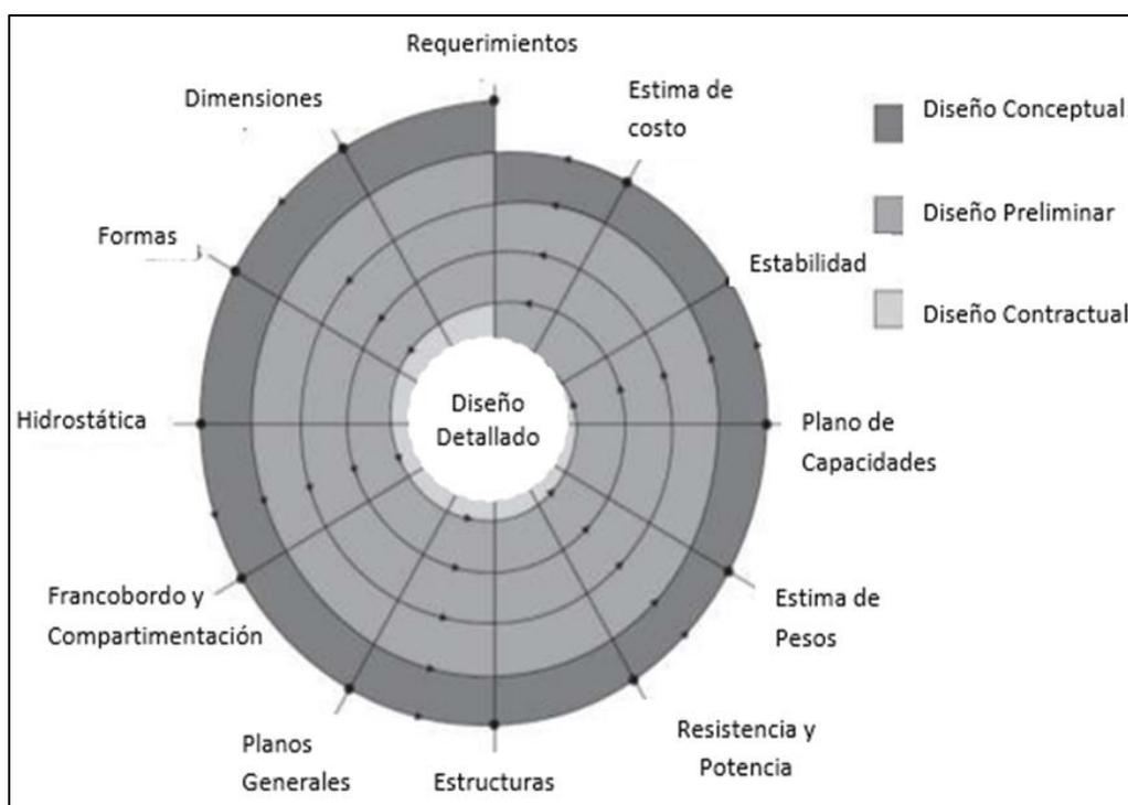
**Figura N° 4. Espiral del diseño del buque.**
