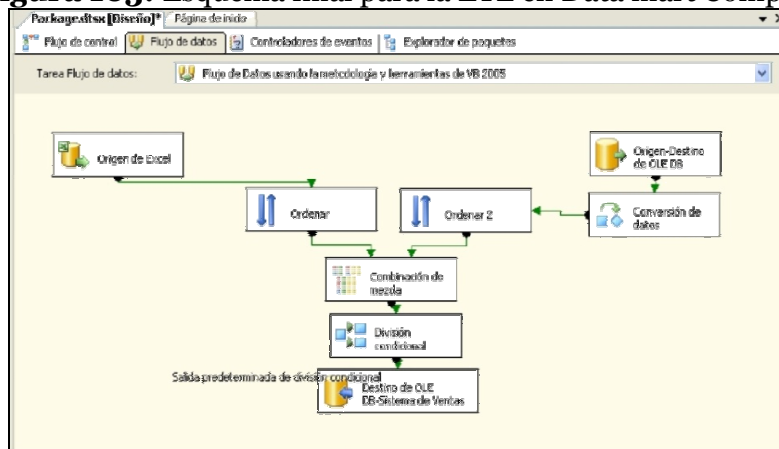
Figura 103: Esquema final para la ETL en Data mart Compras
