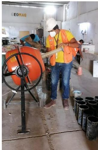
Figura N° 19: Elaboración de concreto.
