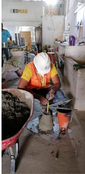
Figura N° 18: Ensayo del Cono de Abrams.
