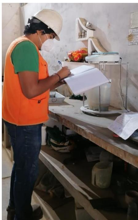
Figura N° 14: Ensayo de Gravedad Específica y Absorción del Agregado Grueso.
