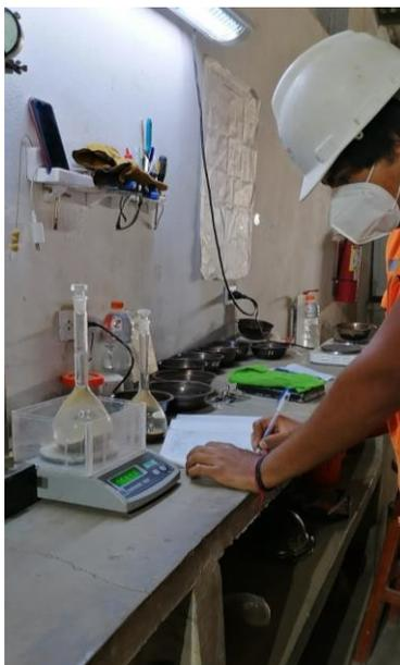
Figura N° 9: Ensayo de Gravedad Específica y Absorción del Agregado Fino.
