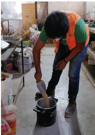
Figura N° 11: Ensayo para determinar el peso unitario del Agregado Fino.
