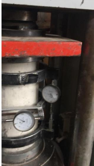
Figura N° 22: Prensa Hidráulica.
