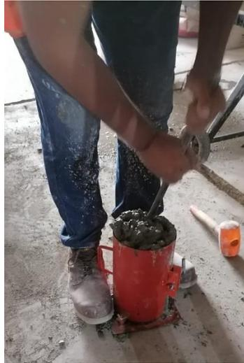
Figura N° 16: Proceso de apisonado del concreto.
