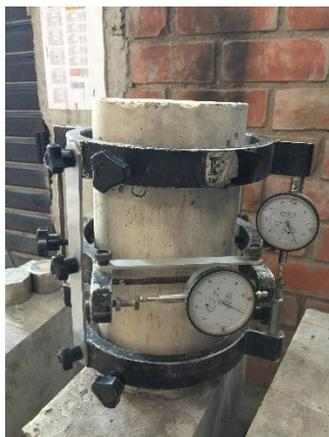
Figura N° 24: Discos y diales para medición de deformaciones.
