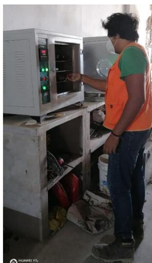
Figura N° 10: Ensayo de porcentaje de humedad del Agregado Fino.
