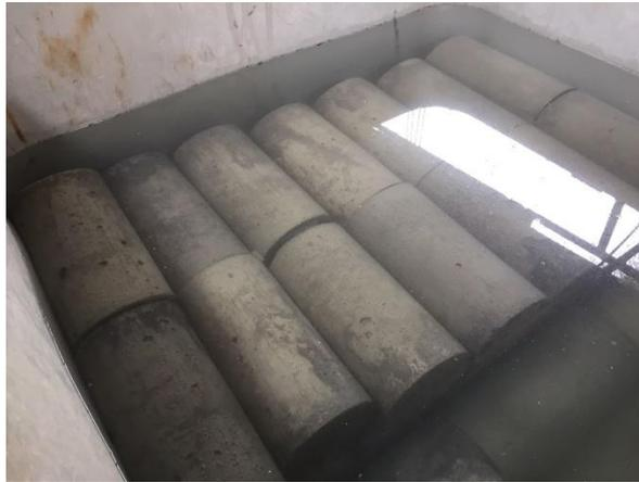
Figura N° 21: Curado de probetas de concreto.
