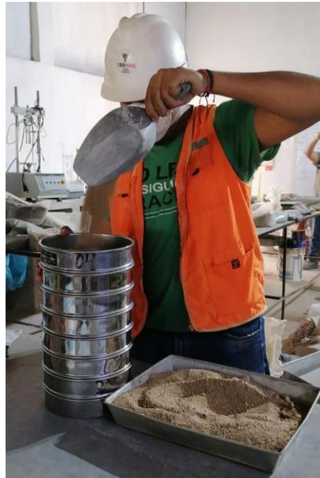
Figura N° 8: Tamizado del Agregado Fino.
