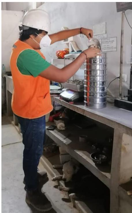
Figura N° 13: Tamizado del Agregado Grueso.
