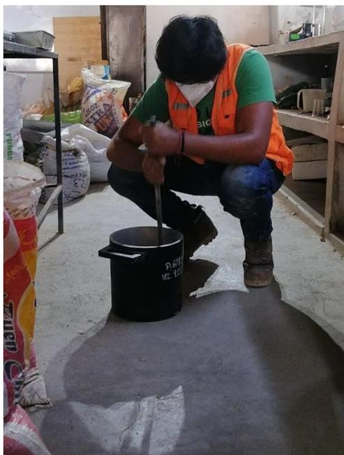
Figura N° 15: Ensayo para determinar el peso unitario del Agregado Grueso.
