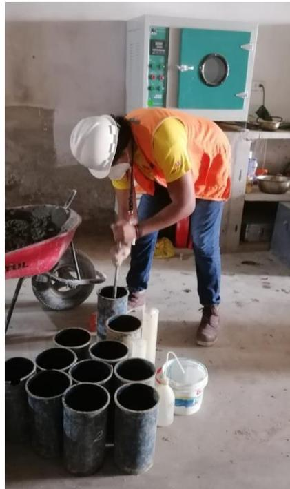
Figura N° 17: Proceso de apisonado del concreto.
