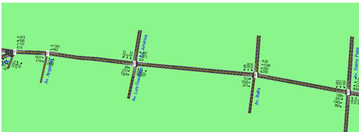
Figura 25. Resultado de los niveles de servicio de la situación actual de la avenida Leguía
