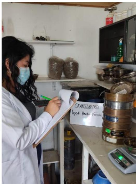
*Fotografía 23. Ensayo granulométrico*
