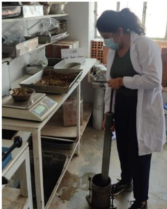
*Fotografía 27. Ensayo de CBR*
