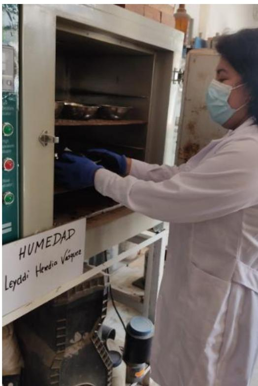
*Fotografía 26. Ensayo de contenido de humedad*
