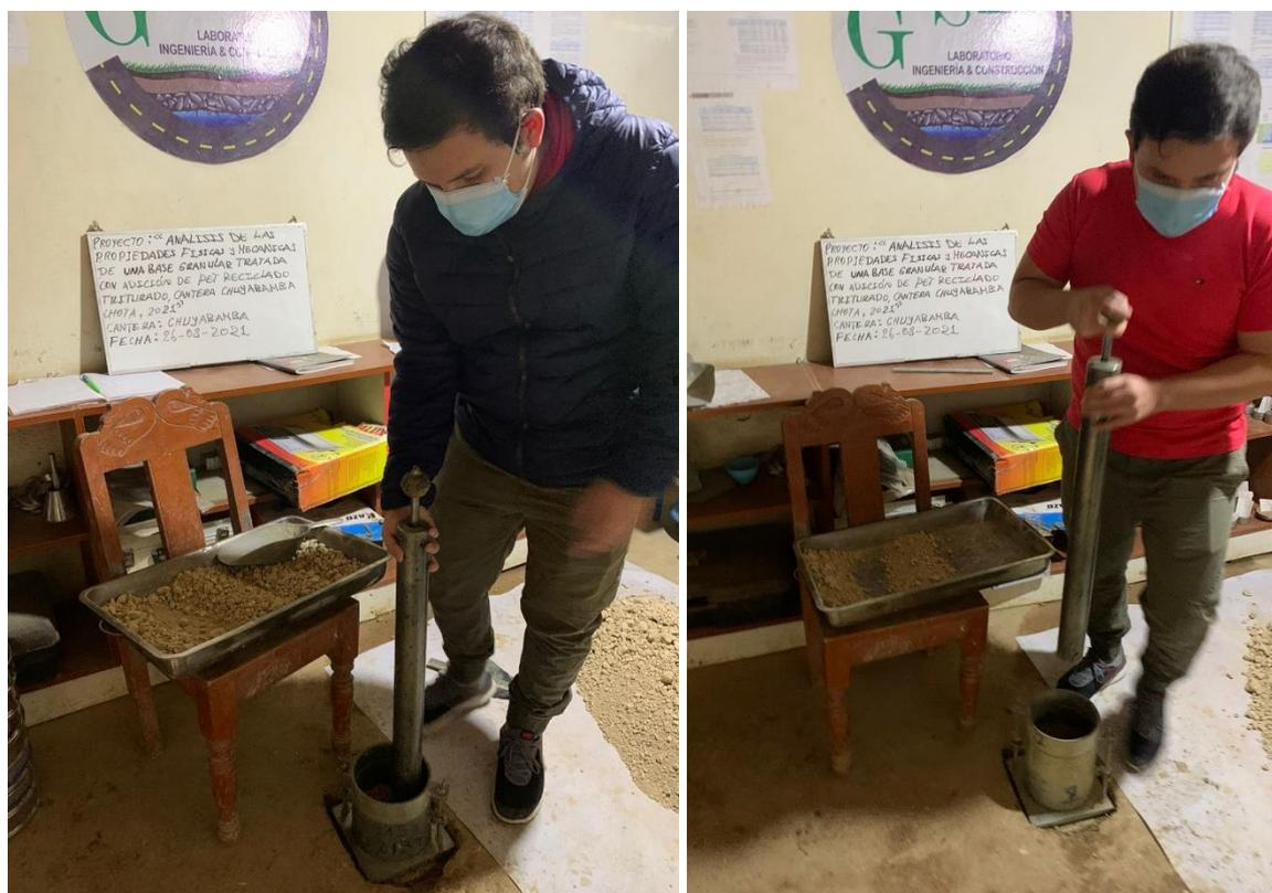
Fotografía 13. Ensayo de expansión previo al ensayo de CBR
