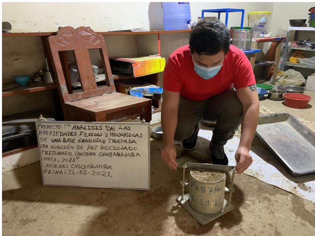
Fotografía 12. Compactación para ensayo de CBR
