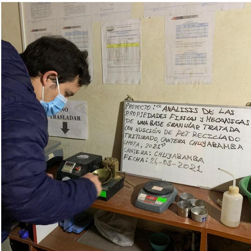
Fotografía 9. Ensayo de límite plástico
