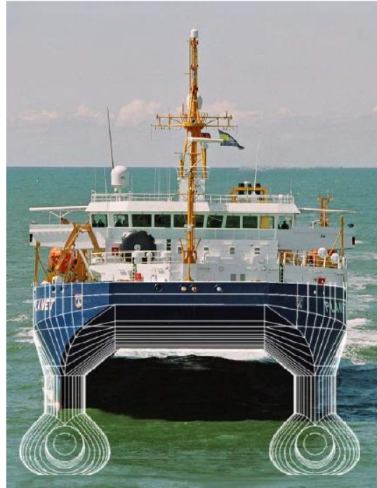
Figura 4: Catamarán de alta velocidad de tipo SWATH, “SWATCH Planet”
