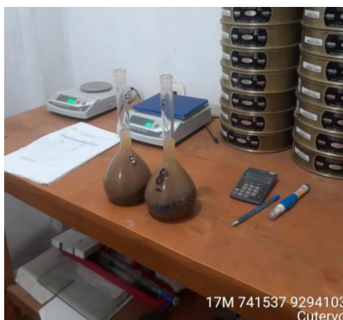
anexo 11: Ensayo De Gravedad Específica Y Absorción De Agregado Fino. Fuente: Propia
