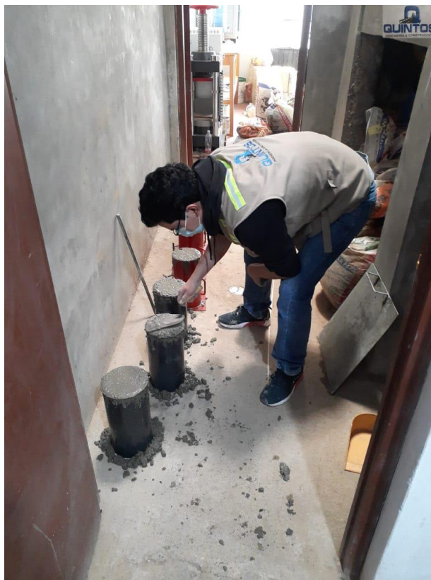
anexo 14: Enrasado de Probetas Cilíndricas de Concreto. Fuente: Propia
