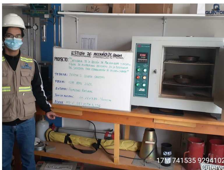
anexo 4: Secado en Horno de Agregado Fino y Grueso. Fuente: Propia
