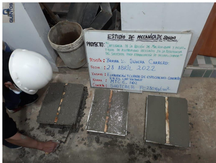
anexo 15: Varillado de Probetas Prismáticas de Concreto. Fuente: Propia
