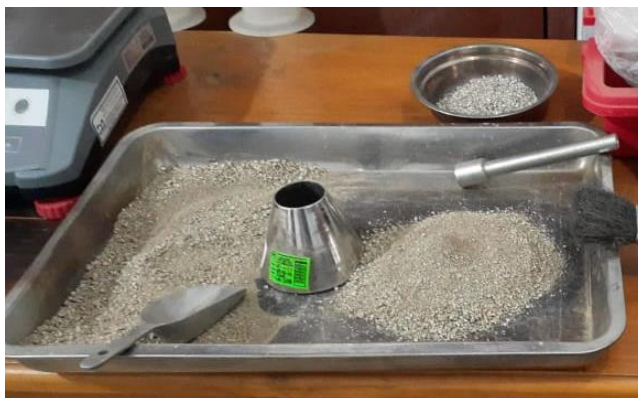
anexo 5: Ensayo de contenido de humedad superficial de agregado fino. Fuente: Propia
