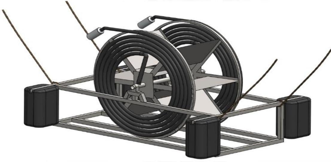
Figura N°22: Cuerdas que sujetaran la Bomba Barsha.
