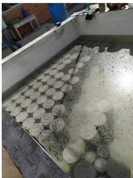
*Figura 4: Curado de probetas*
