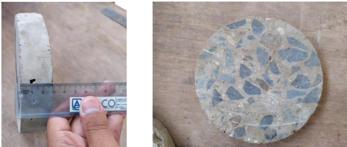
*Figura 6: Muestra para ensayo de porcentaje de vacíos*
