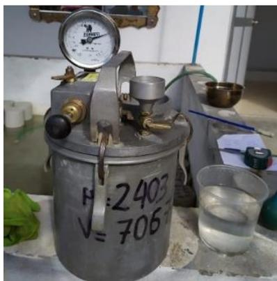
*Figura 23: Medidor tipo B (Olla Washington)*
