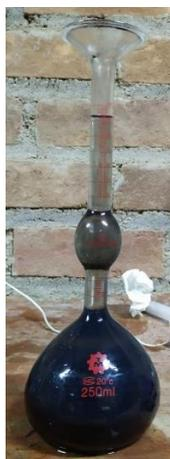
*Figura 2: Frasco de Le Chatelier con CBC y kerosene*
