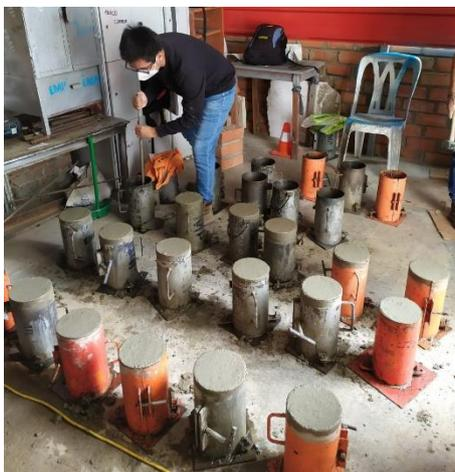
*Figura 3: Moldeo de probetas cilíndricas de concreto*
