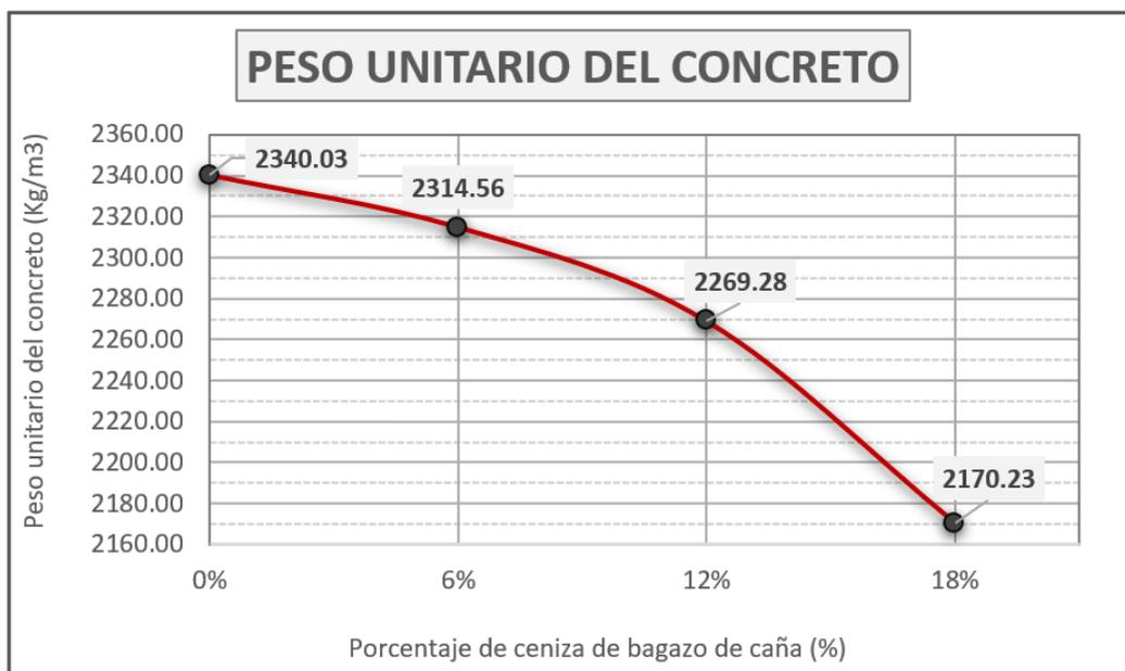
*Figura 22: Comparación del peso unitario del concreto*
