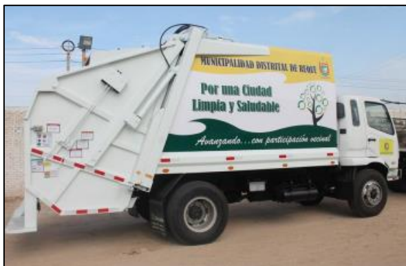
Figura 18. Camión compactador de residuos Sólidos
