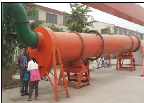
Figura 31. Máquina secadora de abono orgánico
