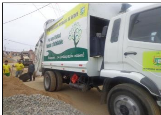
Figura 19. Camión compactador de 8m 3
