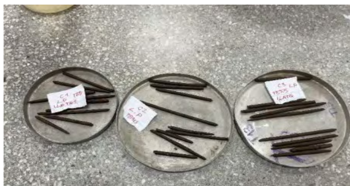
Figura 2. Barras de 3.2mm de espesor para determinar el LP de las muestras de suelo arcilloso
