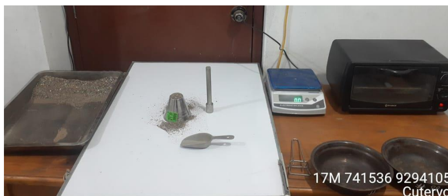
Anexo 21: 25 golpes verticales en cada una de las partes (3/3), con el piñón. Fuente: Propia
