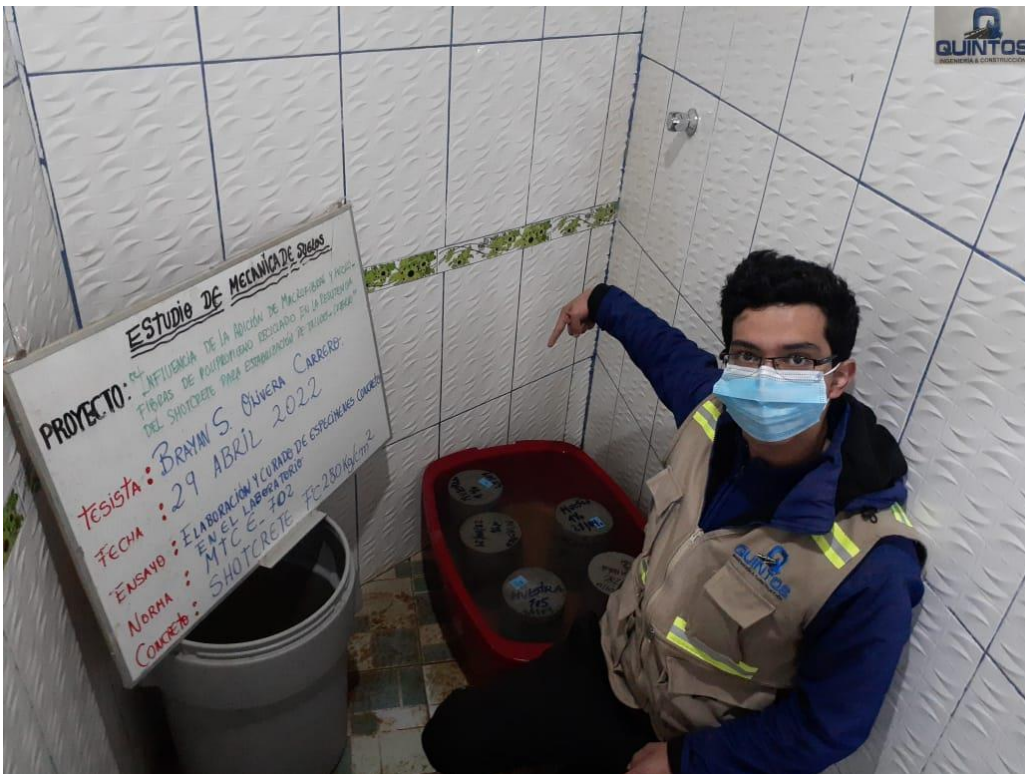
Anexo 82: Curado de Especímenes Cilíndricos de Concreto. Fuente: Propia
