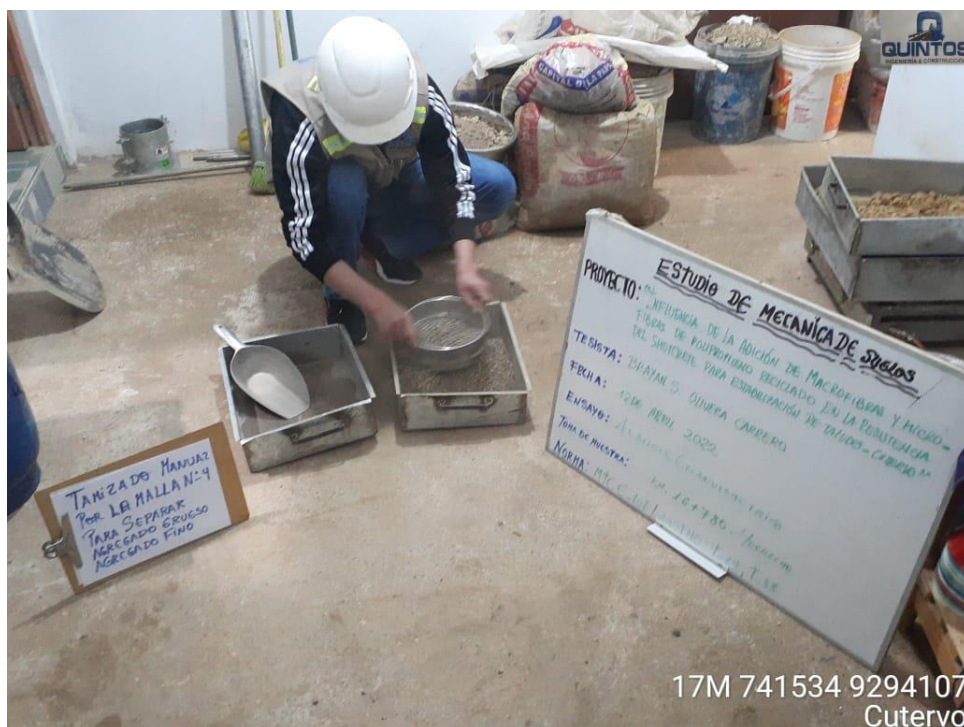
Anexo 106: Ensayo De Análisis Granulométrico Por Tamizado De Muestra De Suelo De Talud En Estudio. Fuente: Propia
