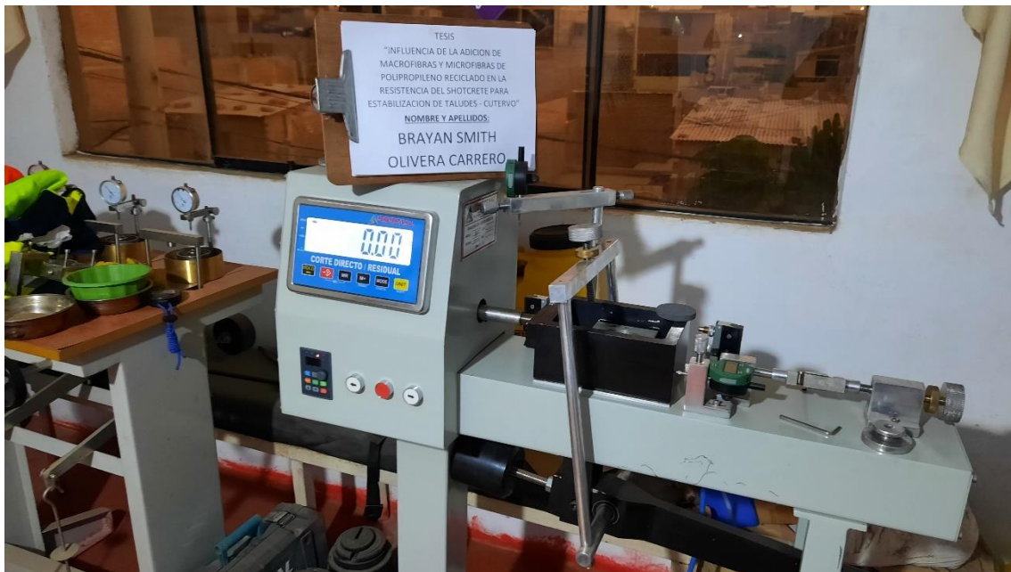
Anexo 127: Máquina empleada en Corte Directo en Muestra de Suelo de Talud. Fuente: Propia
