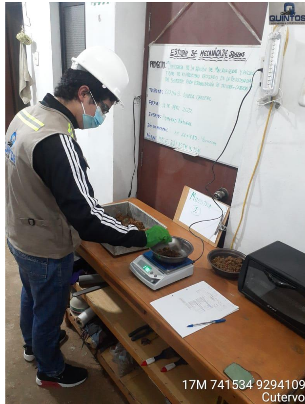
Anexo 110: Peso de Muestra de Suelo de Talud para Ensayo de Contenido de Humedad. Fuente: Propia
