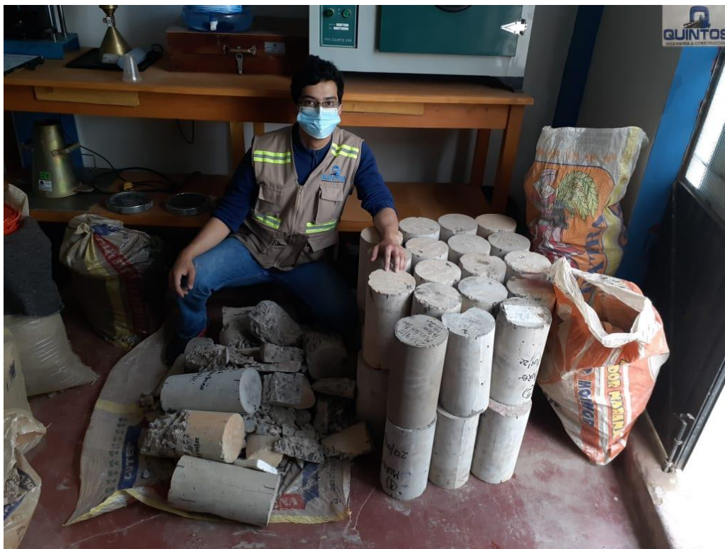
Anexo 101: Ensayo De Testigos Cilíndricos De Concreto (Ensayo De Tracción Indirecta). Fuente: Propia
