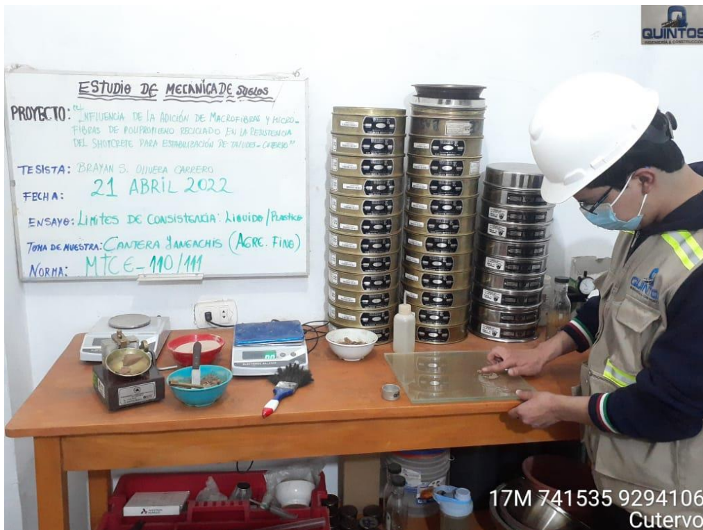
Anexo 116: Toma de Muestra de Suelo de Talud para Límite de Consistencia Plástico. Fuente: Propia
