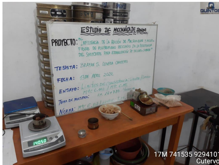
Anexo 115: Ensayo De Límites De Consistencia De Muestra De Suelo De Talud En Estudio (Límite Líquido De Suelo). Fuente: Propia
