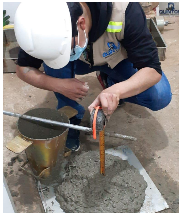
Anexo 91: Medición de Slump en Concreto. Fuente: Propia
