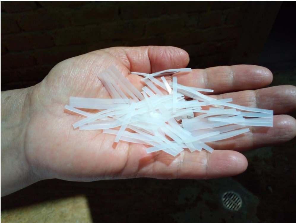
Anexo 5: Macrofibras de Polipropileno Reciclado. Fuente Propia
