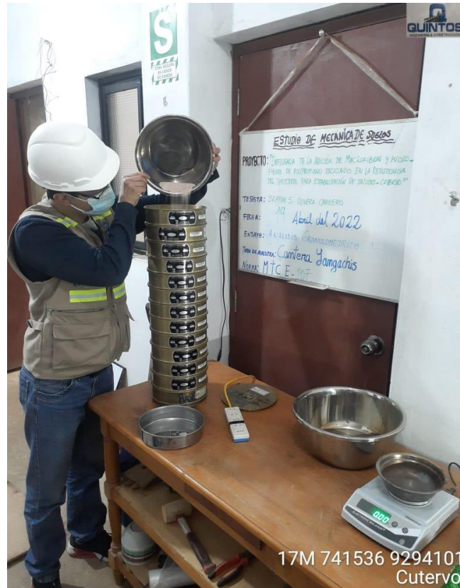
Ilustración 12: Granulometría Por Tamizado De Agregado Fino y Grueso. Fuente: Propia
