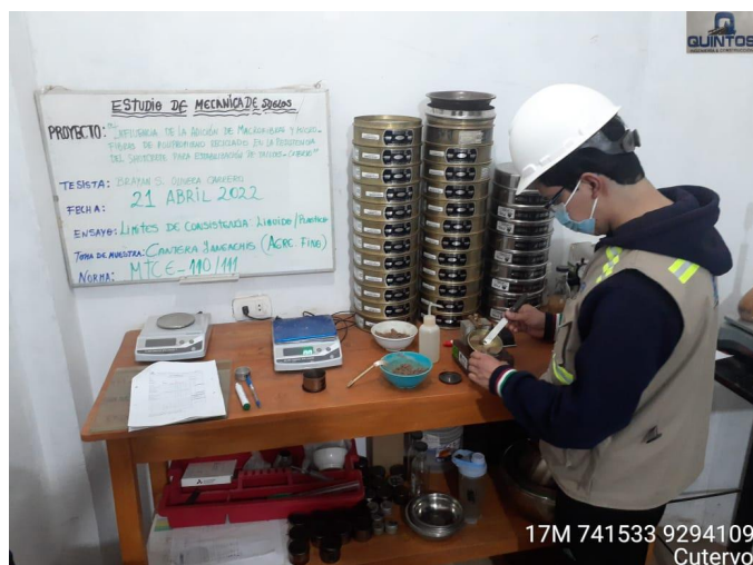
Ilustración 17: Ensayo De Límite De Consistencia De Agregado Fino. Fuente: Propia
