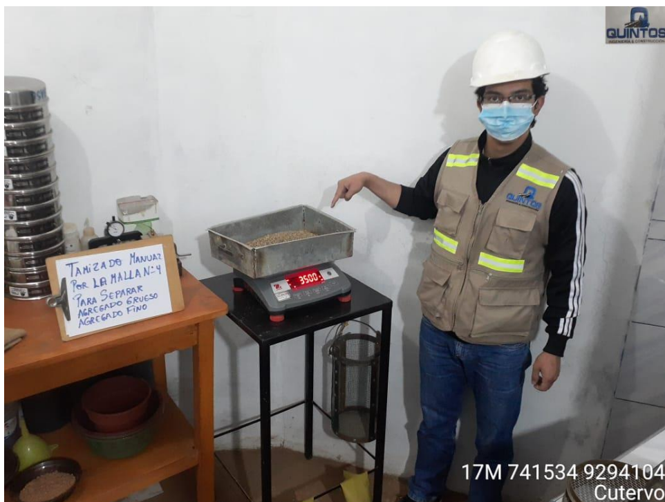
Anexo 7: Peso de Agregado para Ensayo Granulométrico. Fuente: Propia
