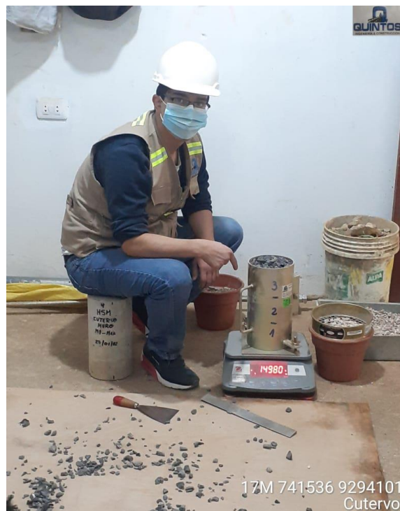
Anexo 40: Peso de Muestra de Agregado Fino. Fuente: Propia
