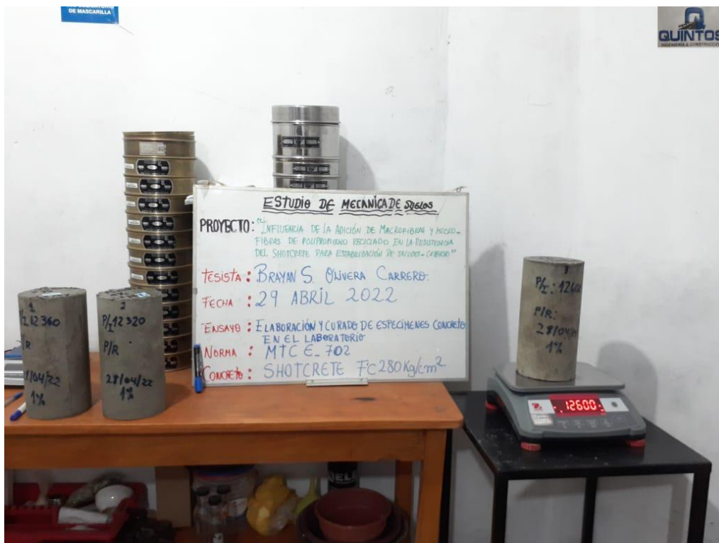
Anexo 80: Peso Unitario de Especímenes de Concreto en Estado Endurecido. Fuente: Propia
