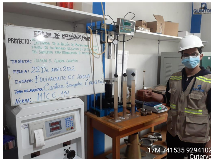
Ilustración 19: Ensayo De Equivalente De Arena De Agregado Fino. Fuente: Propia
