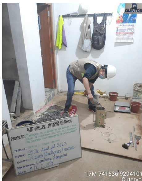
Ilustración 22: Peso Unitario Suelto De Agregado Grueso. Fuente: Propia
