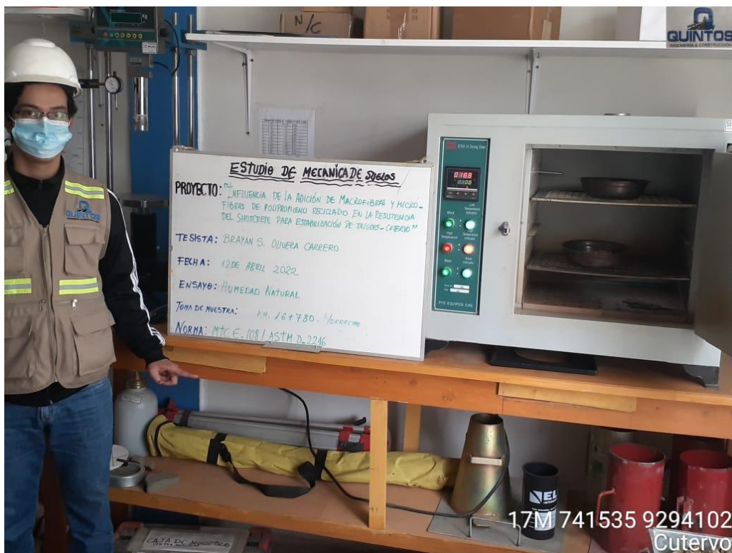
Anexo 15: Secado en Horno de Agregado Fino. Fuente: Propia
