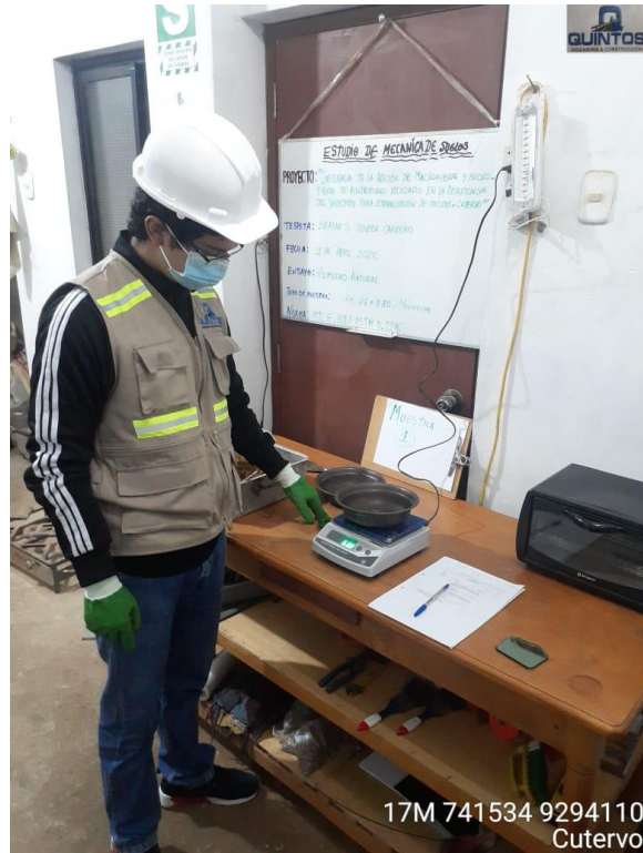
Anexo 108: Muestra de Suelo de Talud para Ensayo de Contenido de Humedad. Fuente: Propia
