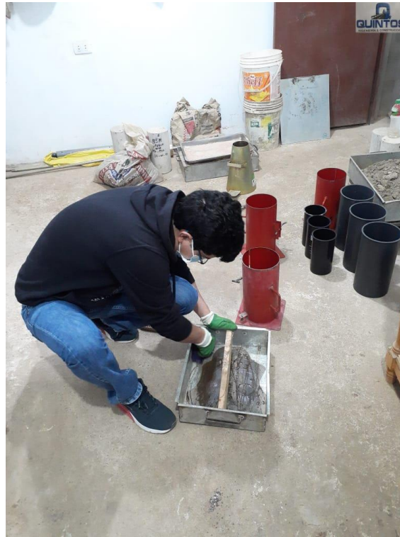
Anexo 63: Engrasado de Probetas para Elaboración de Especímenes Cilíndricos. Fuente: Propia
