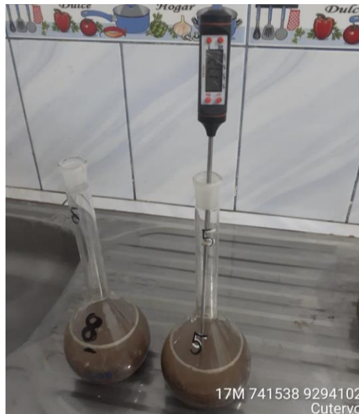
Anexo 50: Temperatura en Ensayo Gravedad Específica Y Absorción De Agregado Fino. Fuente: Propia
