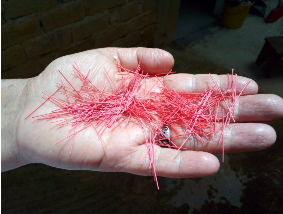
Anexo 6: Microfibras de Polipropileno Reciclado. Fuente Propia
