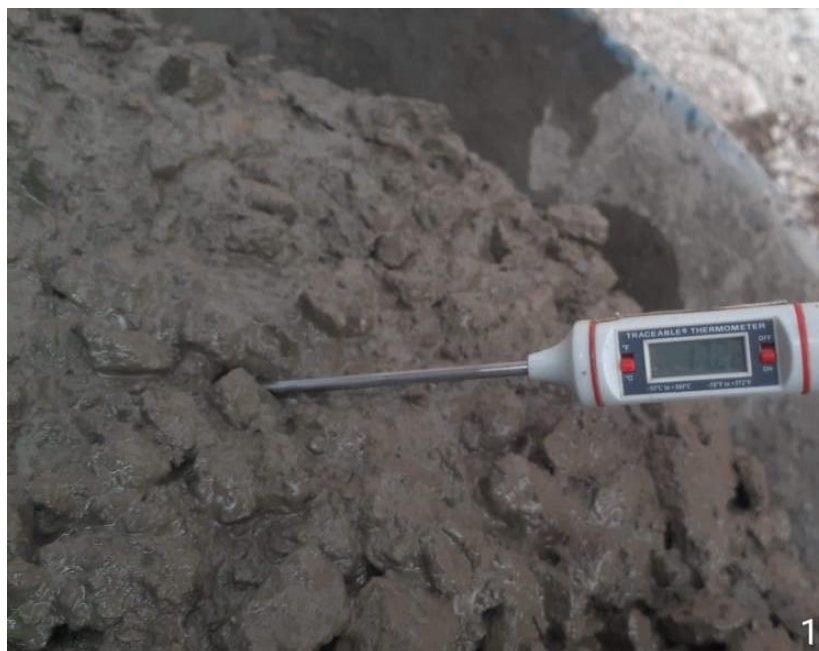
Anexo 96: Temperatura de Concreto en Estado Fresco. Fuente: Propia
