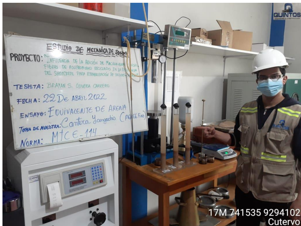
Anexo 30: 3 Ensayos de Equivalente de Arena. Fuente: Propia
