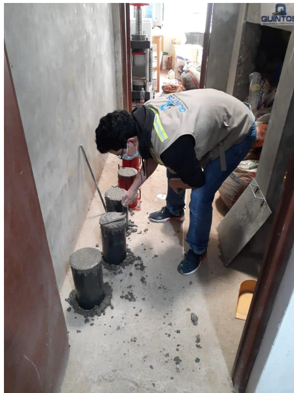
Anexo 76: Enrasado de Probetas Cilíndricas de Concreto. Fuente: Propia
