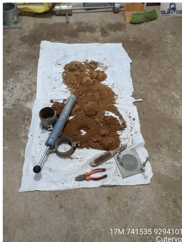
Anexo 122: Toma de Muestra de Suelo de Talud para Ensayo de Proctor. Fuente: Propia
