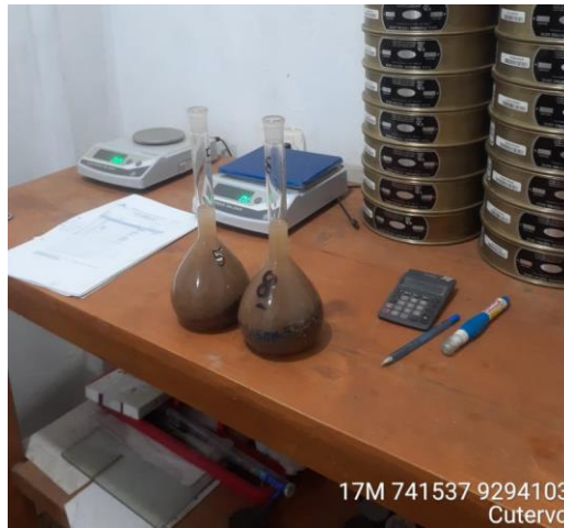
Anexo 49: Ensayo De Gravedad Específica Y Absorción De Agregado Fino. Fuente: Propia
