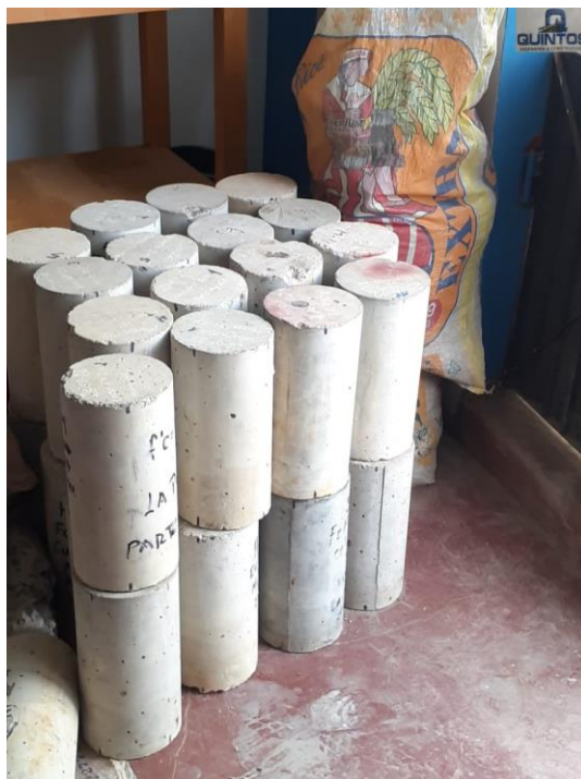
Anexo 93: Elaboración Y Curado De Probetas Cilíndricas De Concreto (Ensayo De Tracción Indirecta). Fuente: Propia
