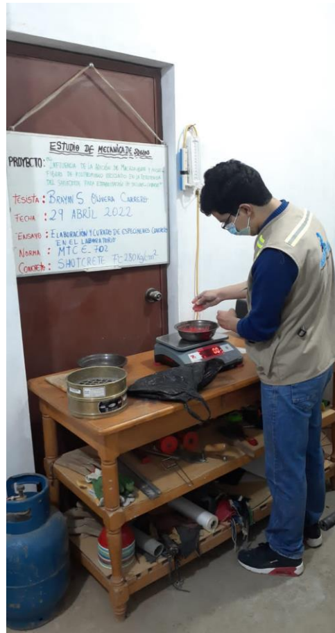
Anexo 71: Peso de Microfibras de Polipropileno Reciclado de acuerdo con Diseño de Mezcla. Fuente: Propia
