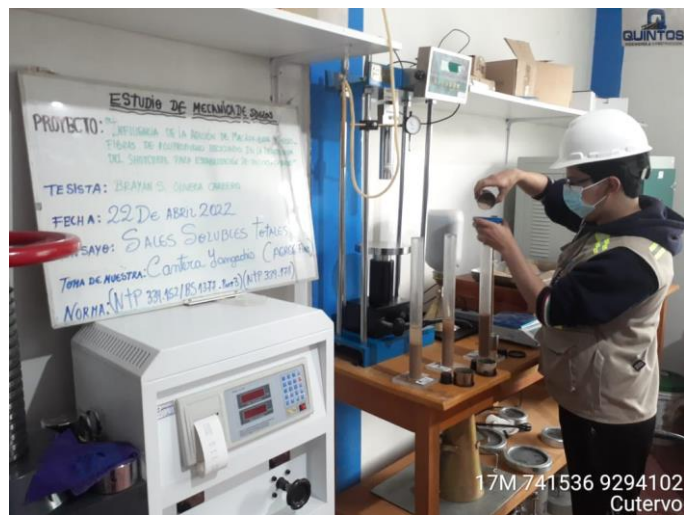
Anexo 120: Ensayo De Sales Solubles Totales En Muestra De Suelo De Talud En Estudio. Fuente: Propia
