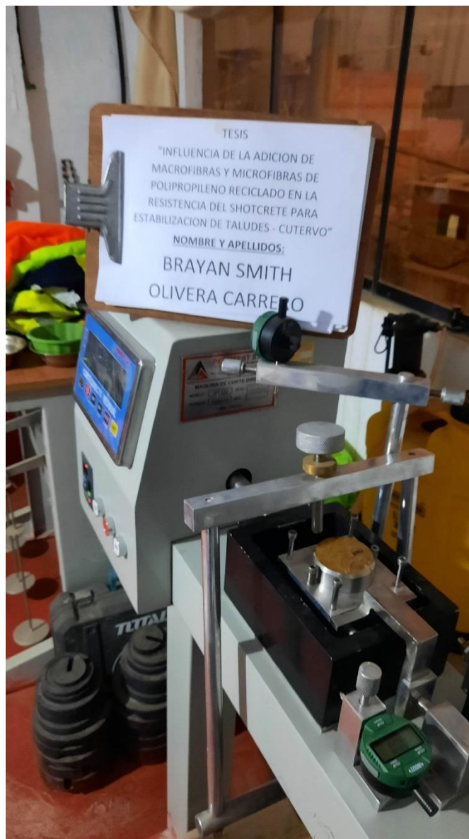
Anexo 135: Ensayo De Corte Directo En Muestra De Suelo De Talud En Estudio. Fuente: Propia
