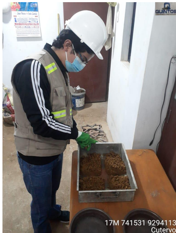
Anexo 109: Cuarteo de Muestra de Suelo de Talud para Ensayo de Contenido de Humedad. Fuente: Propia
