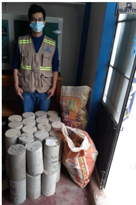
Anexo 92: Elaboración Y Curado De Probetas Cilíndricas De Concreto (Ensayo De Compresión). Fuente: Propia
