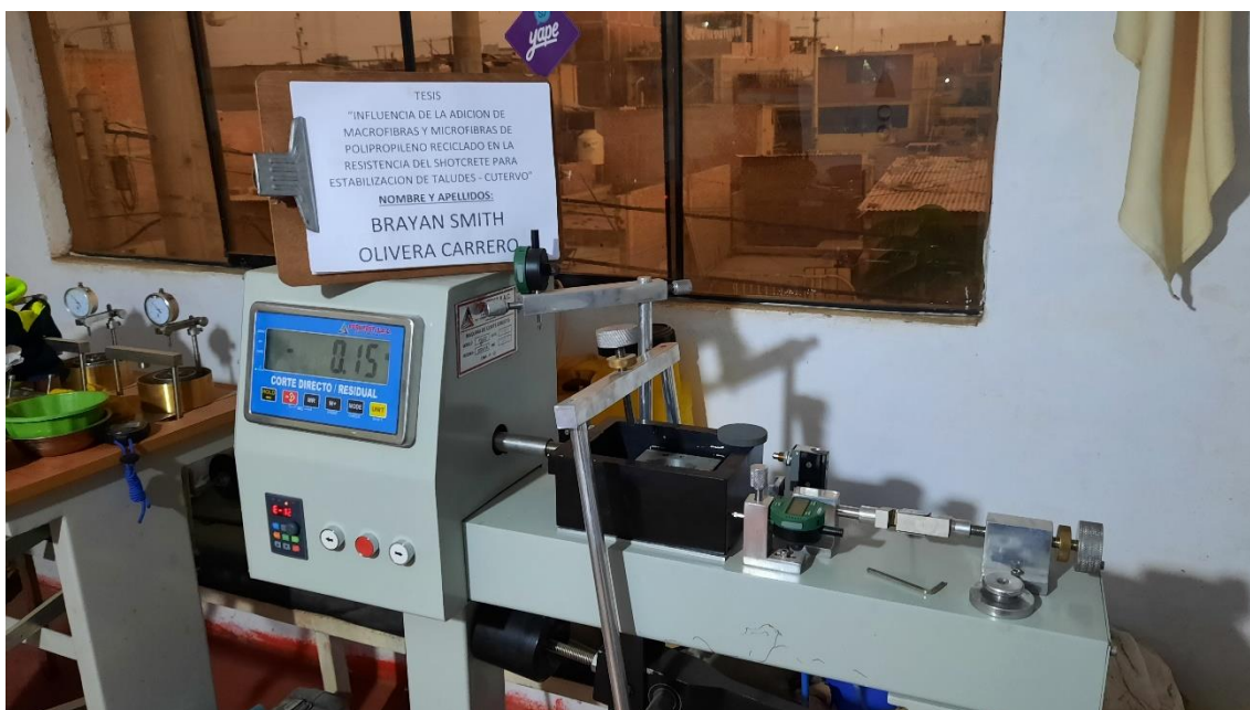
Anexo 129: Aplicación de Fuerza Cortante en Corte Directo. Fuente: Propia
