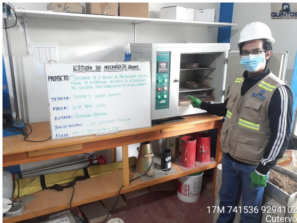
Anexo 111: Sometimiento a Horno de Muestra de Suelo de Talud para Ensayo de Contenido de Humedad. Fuente: Propia
