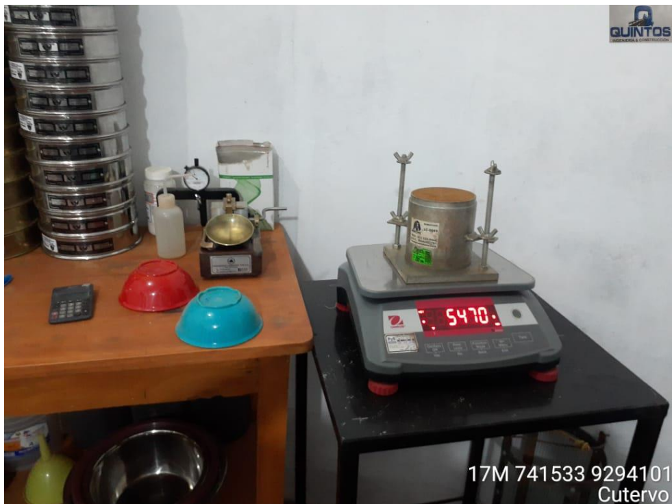
Anexo 124: Registro de Peso en Proctor de Muestra de Suelo de Talud. Fuente: Propia
