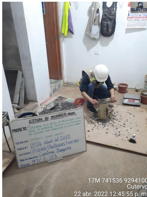
Anexo 44: Enrasado de Agregado Grueso en Probeta Cilíndrica. Fuente: Propia
