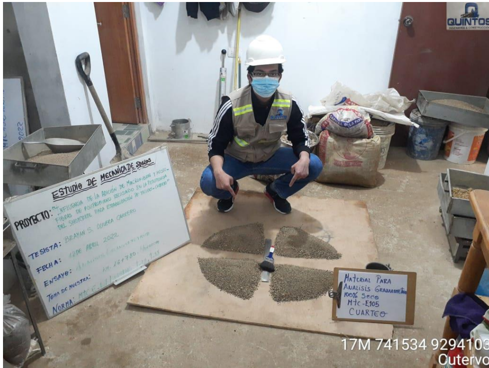
Anexo 8: Cuarteo de Agregado para Ensayo de Granulometría. Fuente: Propia
