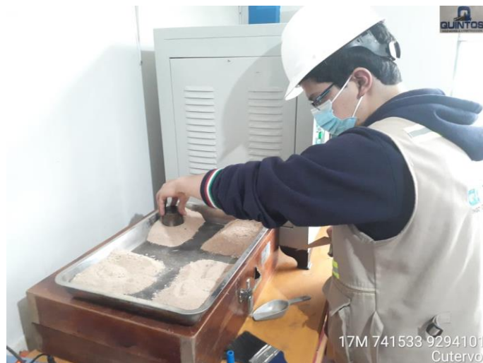
Anexo 120: Ensayo De Sales Solubles Totales En Muestra De Suelo De Talud En Estudio. Fuente: Propia
