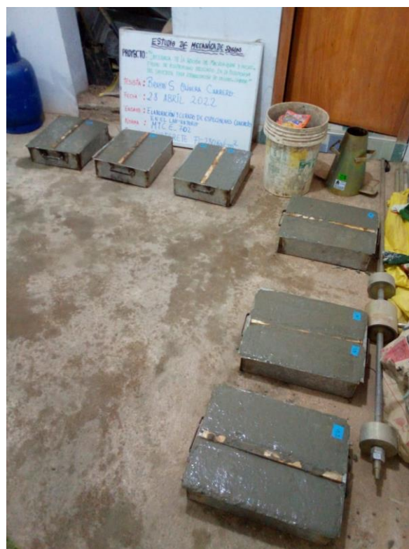
Anexo 94: Elaboración Y Curado De Vigas Prismáticas De Concreto (Ensayo De Flexión A Vigas Simplemente Apoyadas Con Cargas A Los Tercios Del Tramo). Fuente: Propia
