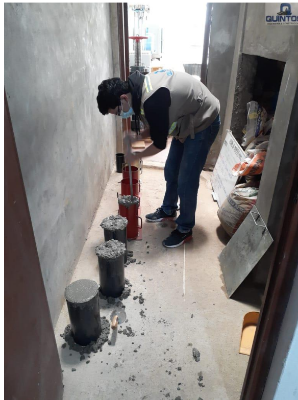
Anexo 74: Varillado de Probetas Cilíndricas de Concreto. Fuente: Propia
