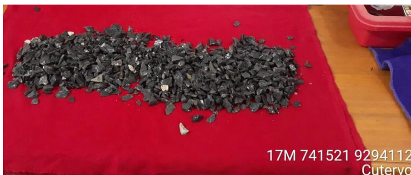
Anexo 51: Lavado de Agregado. Ensayo De Gravedad Específica Y Absorción De Agregado Grueso. Fuente: Propia
