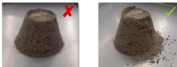
Ilustración 16: Condición SSS para arena con poco material grueso. Fuente: [33]
