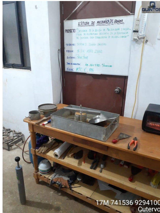
Anexo 123: Compactación de Suelo de Talud en Ensayo Proctor. Fuente: Propia
