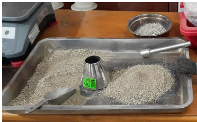
Anexo 20: Cono de Absorción colocado cada 3 partes. Fuente: Propia
