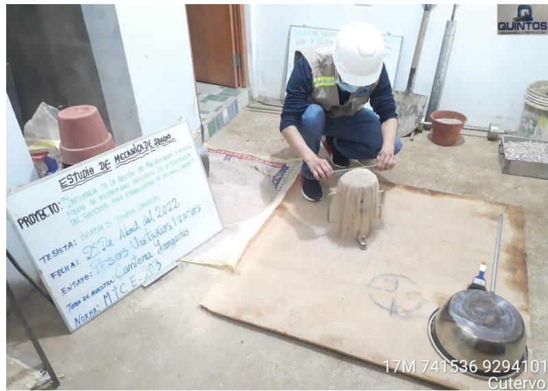
Anexo 41: Enrasado de Agregado Fino en Probeta Cilíndrica. Fuente: Propia
