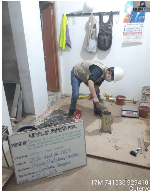
Anexo 39: Vaciado de Agregado Fino. Fuente: Propia
