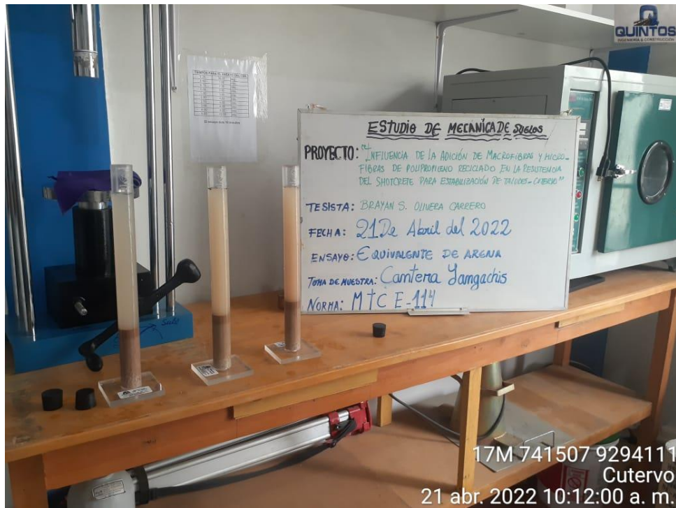
Anexo 29: Equivalente de Arena, ensayo de Laboratorio. Fuente: Propia
