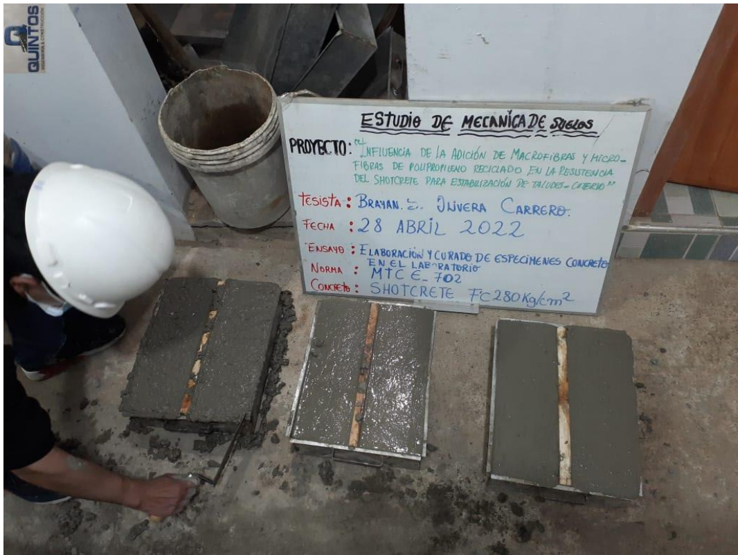
Anexo 77: Varillado de Probetas Prismáticas de Concreto. Fuente: Propia
