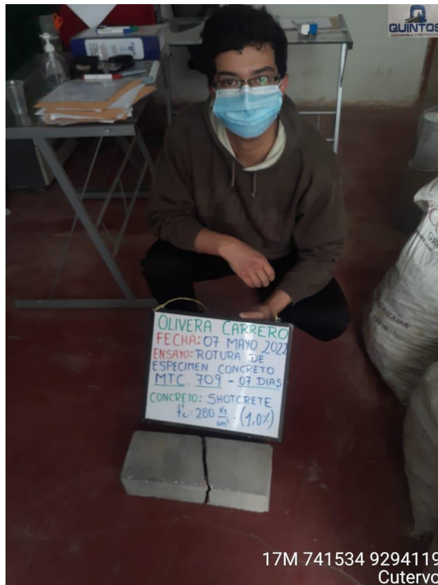
Ilustración 24: Ensayo De Flexión A Vigas Simplemente Apoyadas Con Cargas A Los Tercios Del Tramo. Fuente: Propia
