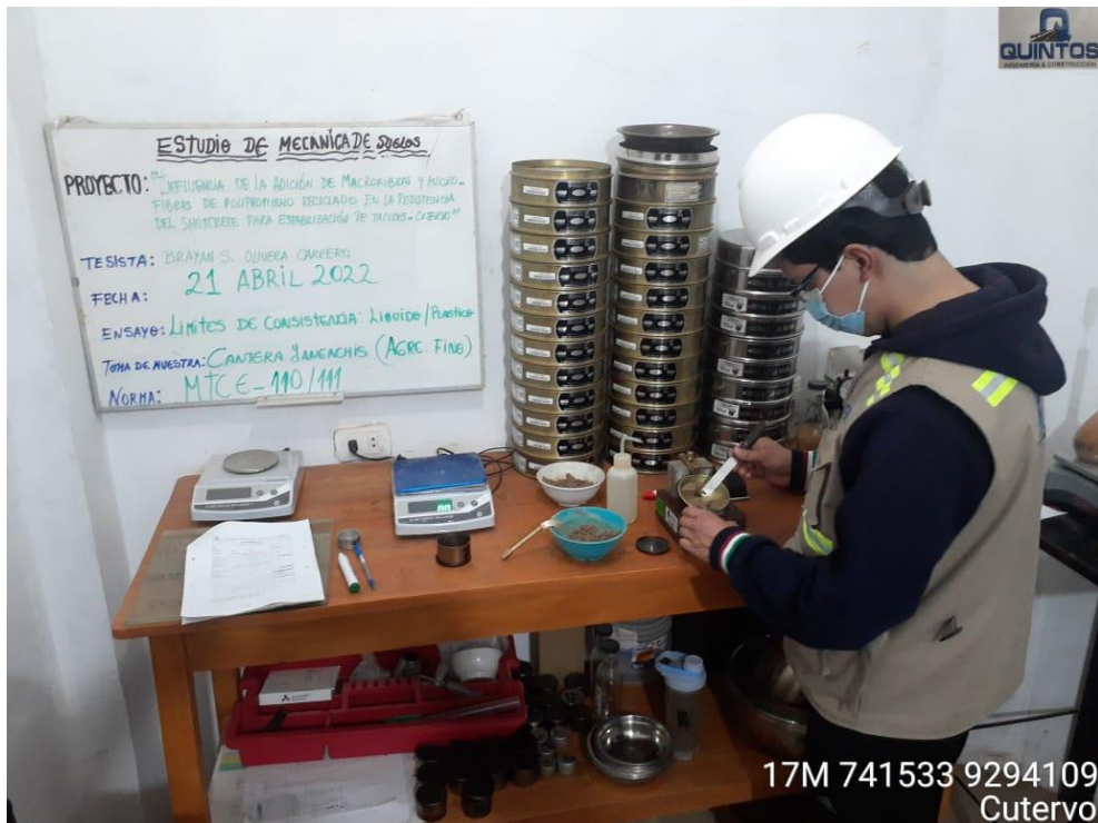
Anexo 113: Toma de Muestra de Suelo de Talud para Límite de Consistencia Líquido. Fuente: Propia
