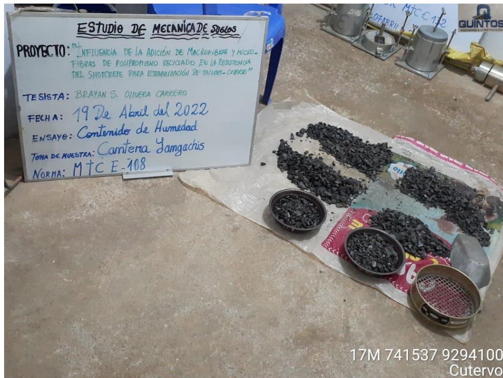
Anexo 14: Cuarteo de Agregado para Contenido de Humedad. Fuente: Propia
