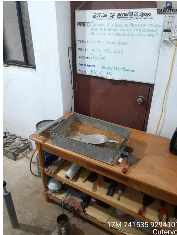
Anexo 122: Toma de Muestra de Suelo de Talud para Ensayo de Proctor. Fuente: Propia
