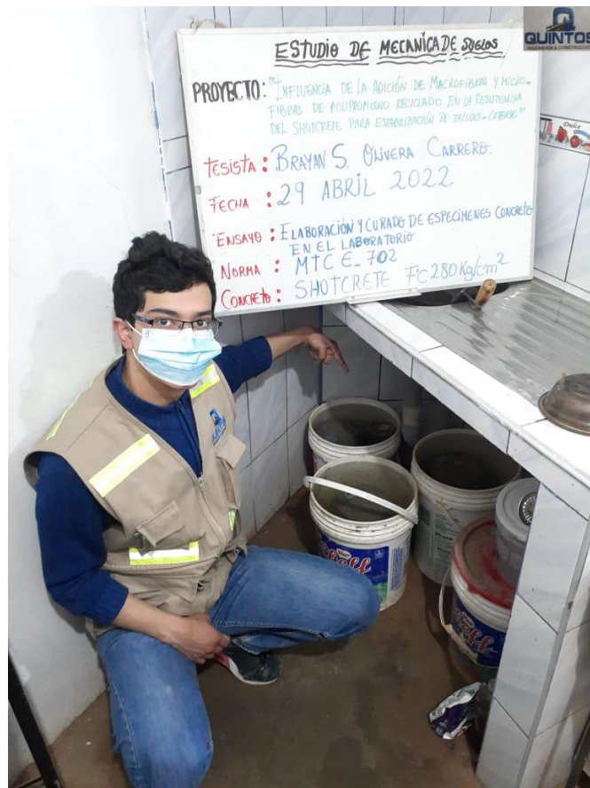
Anexo 83: Curado de Especímenes Prismáticos de Concreto. Fuente: Propia
