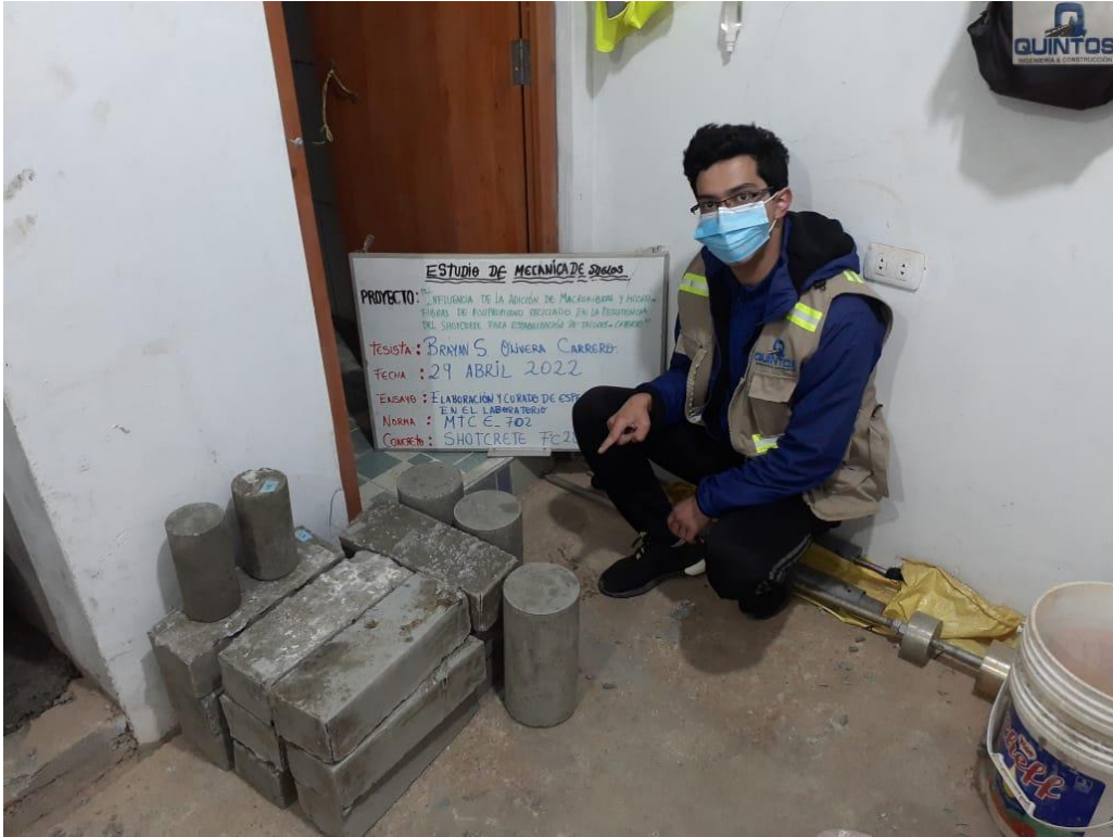
Anexo 81: Especimenes de concreto para Curado en Días. Fuente: Propia}
