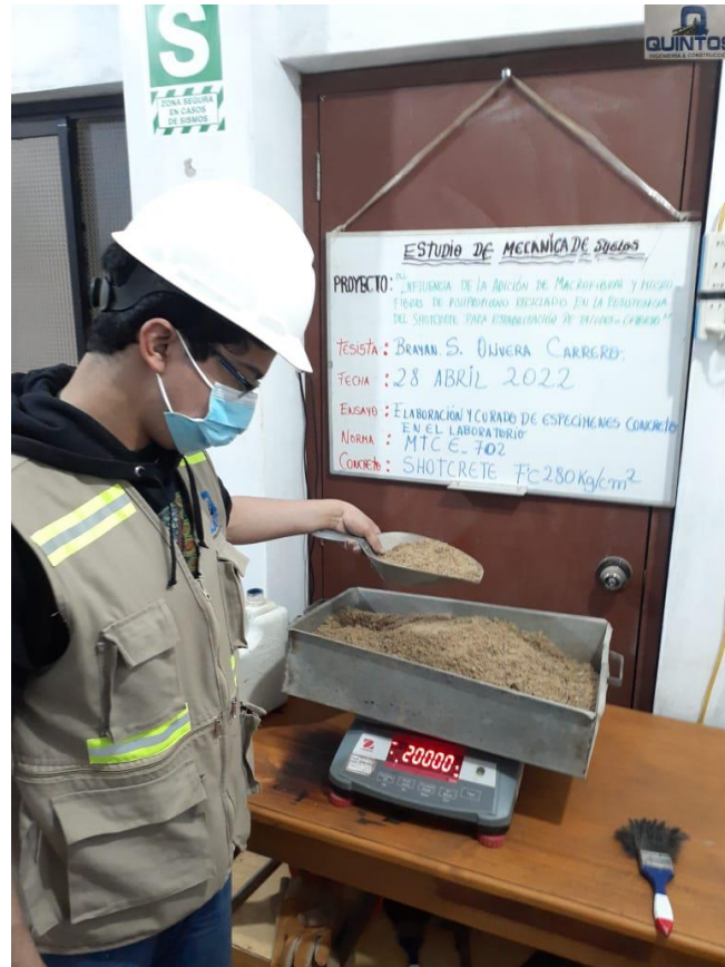
Anexo 67: Peso de Agregado Fino de acuerdo con Diseño de Mezcla. Fuente: Propia
