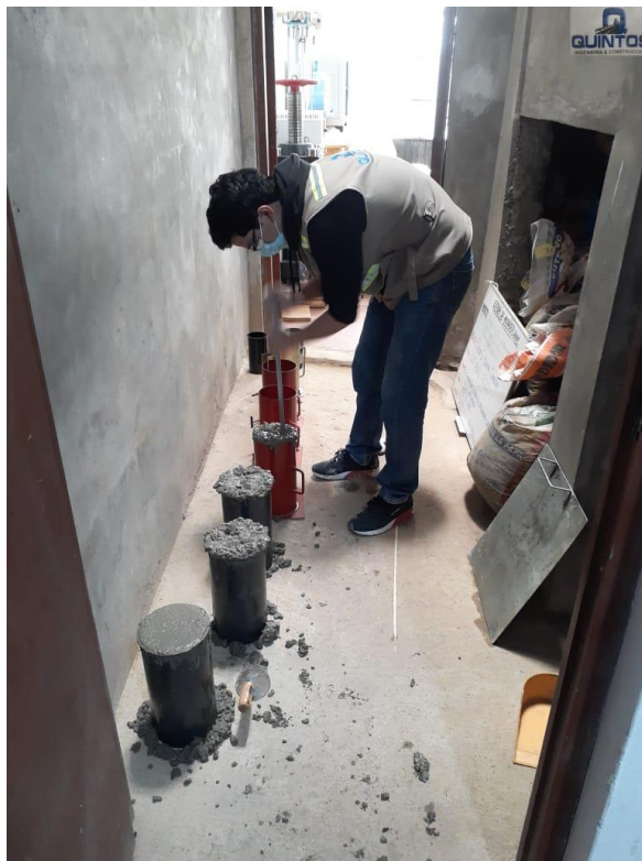
Anexo 93: Elaboración Y Curado De Probetas Cilíndricas De Concreto (Ensayo De Tracción Indirecta). Fuente: Propia
