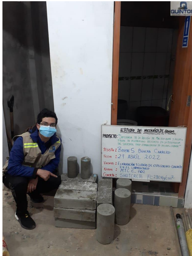
Anexo 79: Especímenes Cilíndricos y Prismáticos de Concreto. Fuente: Propia
