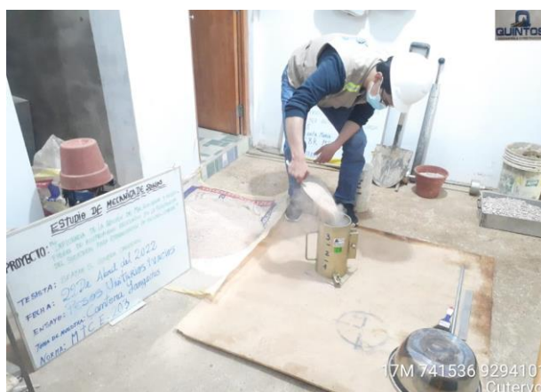
Ilustración 23: Peso Unitario Suelto De Agregado Fino. Fuente: Propia
