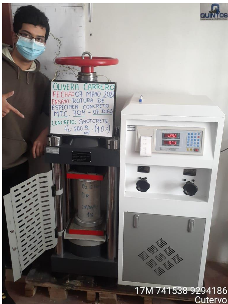
Anexo 99: Ensayo De Testigos Cilíndricos De Concreto (Ensayo De Compresión). Fuente: Propia
