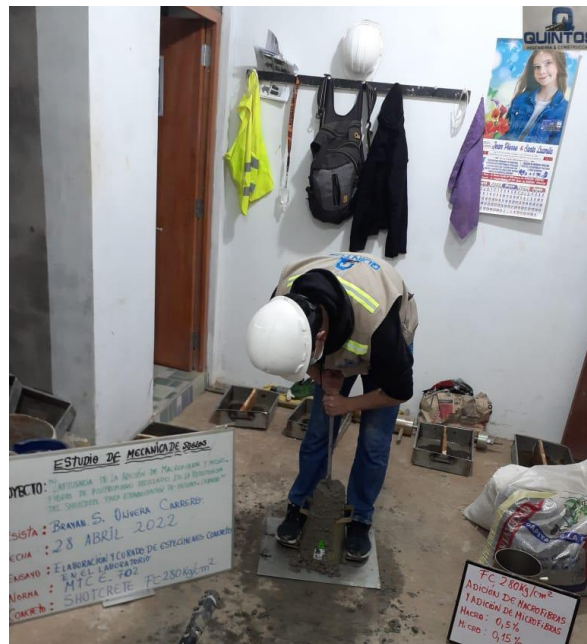
Anexo 89: Varillado en Cono de Abrams para ensayo de Slump. Fuente: Propia
