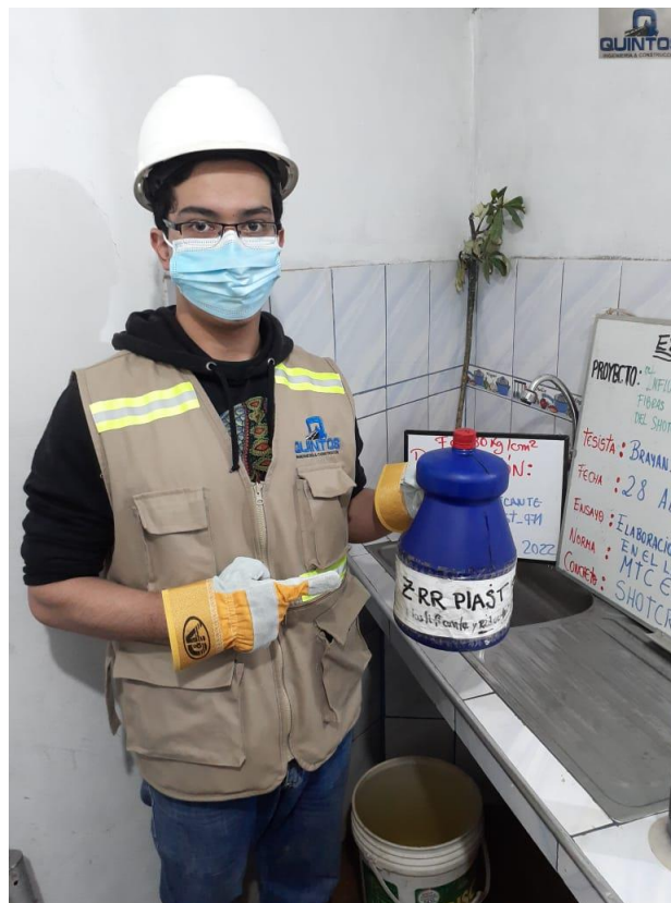
Anexo 64: Aditivo: ZRR-Plast para mejorar la trabajabilidad. Fuente: Propia
