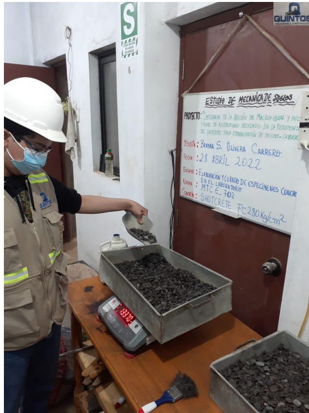
Anexo 65: Peso de Agregado Grueso de acuerdo con Diseño de Mezcla. Fuente: Propia
