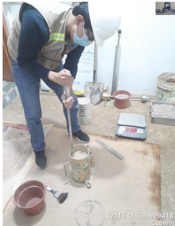
Anexo 45: Varillado de Agregado Fino. Fuente: Propia
