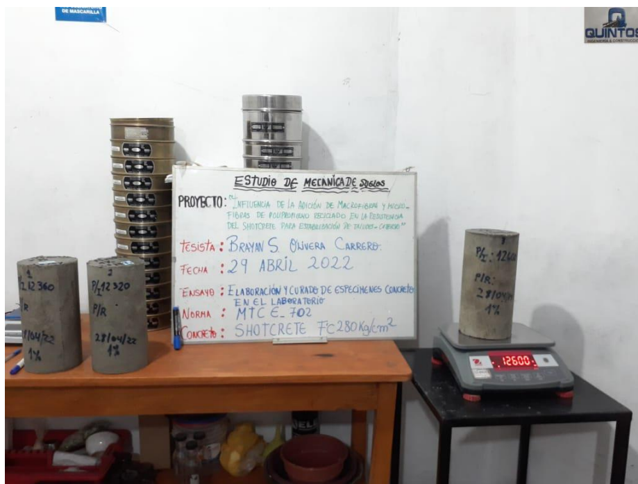
Anexo 98: Peso Unitario En La Mezcla De Concreto. Fuente: Propia
