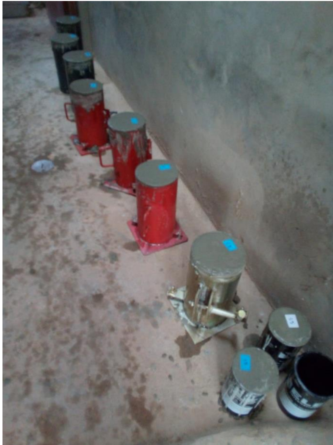
Anexo 92: Elaboración Y Curado De Probetas Cilíndricas De Concreto (Ensayo De Compresión). Fuente: Propia
