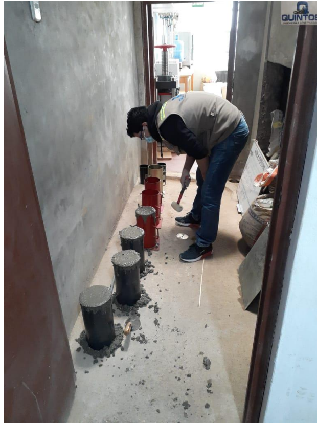
Anexo 75: Golpeo de Probetas Cilíndricas de Concreto. Fuente: Propia
