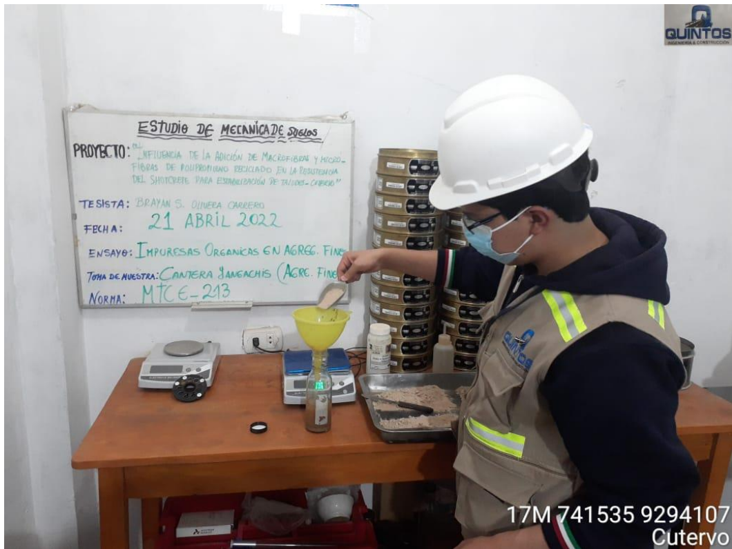
Anexo 60: Vaciado de Agregado Fino para ensayo de Impurezas Orgánicas. Fuente: Propia
