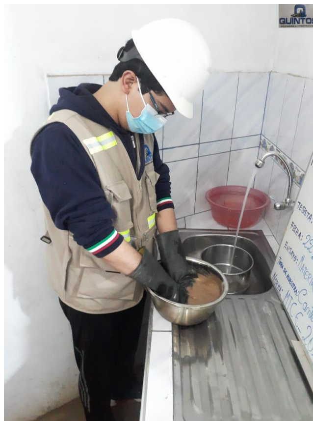
Anexo 33: Lavado de Agregado Fino que pasa por tamiz N° 200. Fuente: Propia
