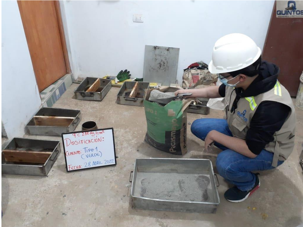
Anexo 66: Peso de Cemento de acuerdo con Diseño de Mezcla. Fuente: Propia
