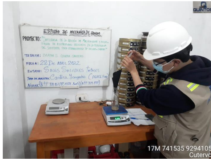
Anexo 119: Toma de Muestra de Suelo para ensayo de Sales Solubles en Suelo de Talud. Fuente: Propia
