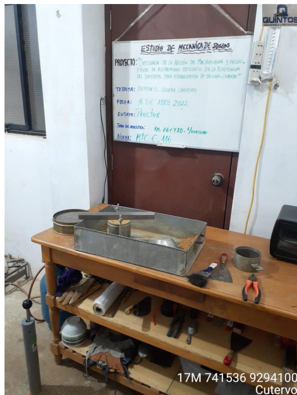
Anexo 125: Ensayo De Relación Densidad/Humedad (Proctor) En Muestra De Suelo De Talud En Estudio. Fuente: Propia
