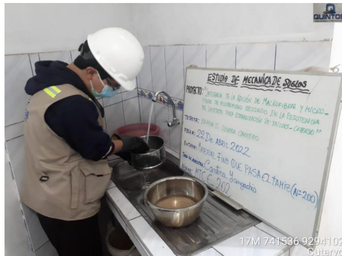
Ilustración 20: Ensayo De Material Fino Que Pasa Por El Tamiz N° 200. Fuente: Propia
