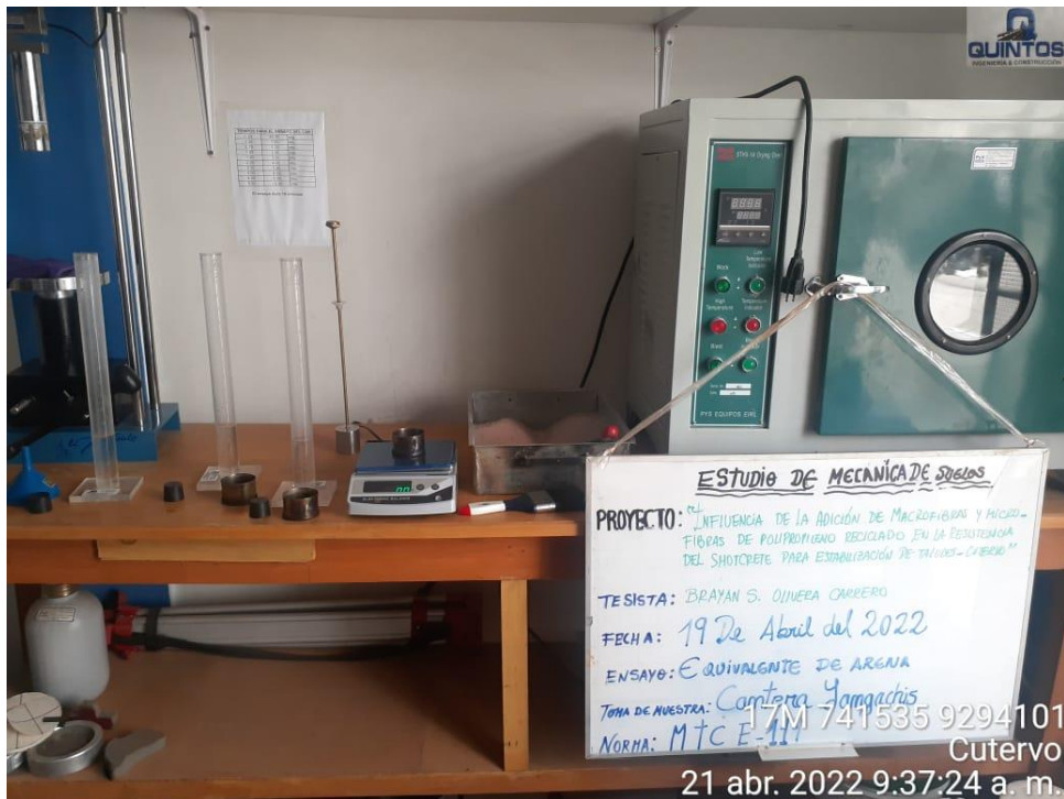
Anexo 28: Toma de Muestra de Ensayo de Equivalente de Arena. Fuente: Propia
