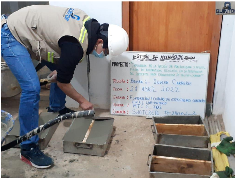
Anexo 78: Enrasado de Probetas Prismáticas de Concreto. Fuente: Propia
