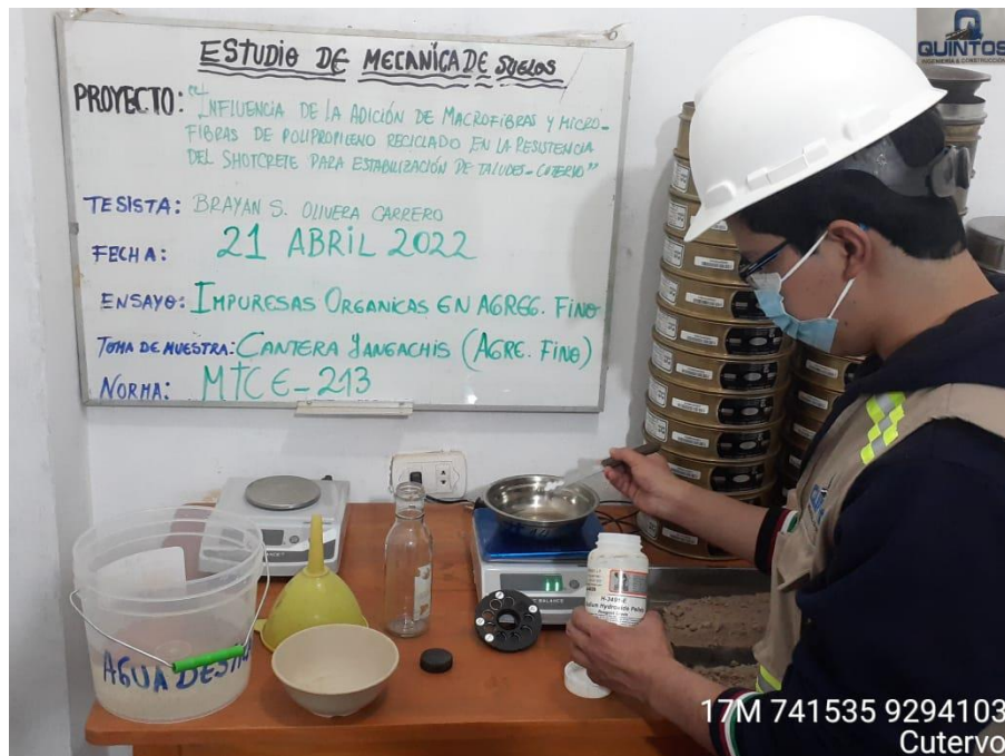
Anexo 58: Ensayo de Impurezas Orgánicas en Agregado Fino. Fuente: Propia
