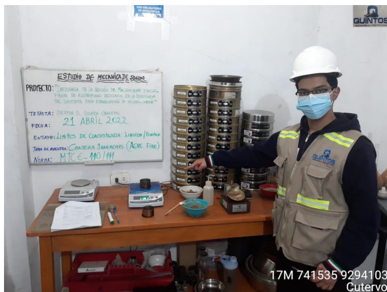
Anexo 115: Ensayo De Límites De Consistencia De Muestra De Suelo De Talud En Estudio (Límite Líquido De Suelo). Fuente: Propia
