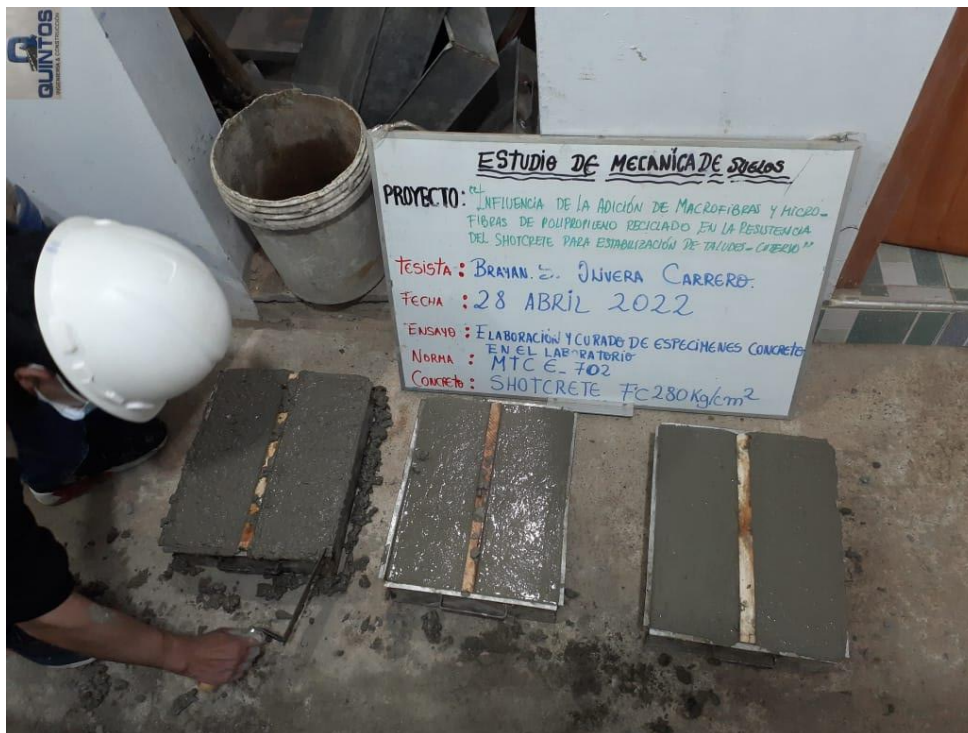
Anexo 94: Elaboración Y Curado De Vigas Prismáticas De Concreto (Ensayo De Flexión A Vigas Simplemente Apoyadas Con Cargas A Los Tercios Del Tramo). Fuente: Propia
