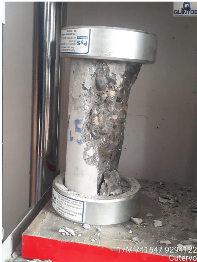
Anexo 104: Ensayo De Segregación En El Concreto Endurecido. Fuente: Propia
