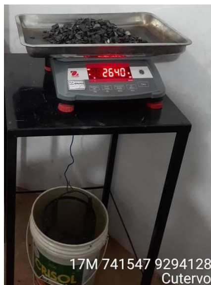
Anexo 54: Ensayo De Gravedad Específica Y Absorción De Agregado Grueso. Fuente: Propia
