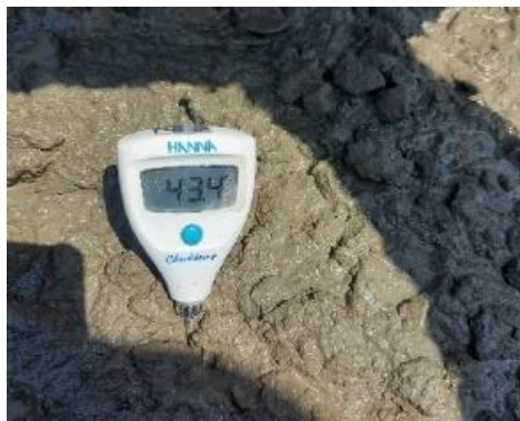
Figura 5. Medición de la temperatura.
