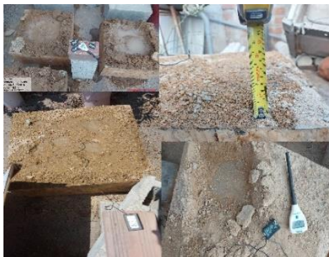
Figura 8. Curado con recubrimiento de 3cm de arena fina.
