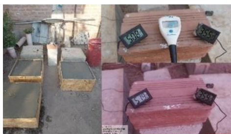
Figura 7. Medición de la temperatura en el tiempo, centro del bloque.
