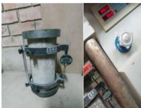
Figura 5. Ensayo a compresión y módulo de elasticidad con dial.
