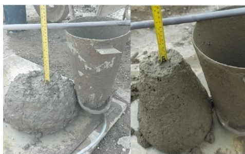
Figura 4. Ensayo con el cono de abrams, tipo de falla normal.
