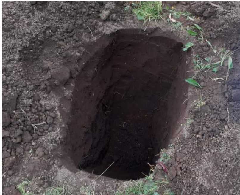
FOTOGRAFÍA N° 4. Vista de Perfil Estratigráfico de la Calicata C-02.
