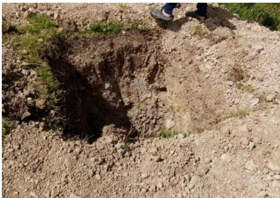
FOTOGRAFÍA N° 8. Vista de Perfil Estratigráfico de la Calicata C-04.
