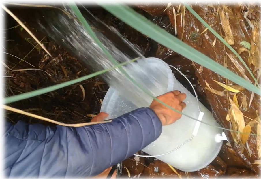
Ilustración 6: Medida de flujo haciendo uso recipiente de 20litros.
