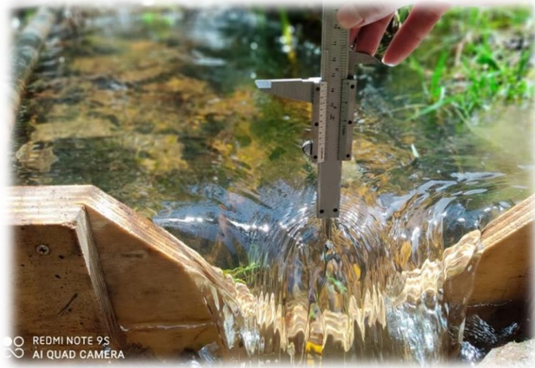
Ilustración 9: Medición de la altura del agua en el vertedor de tipo triangular.
