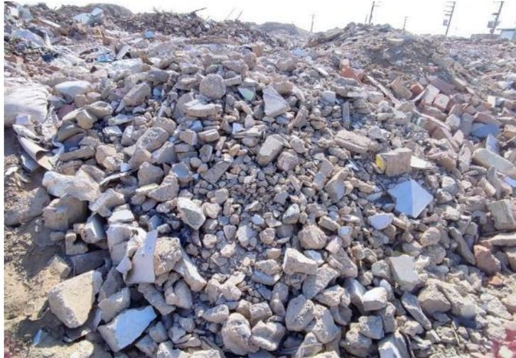
Para la obtención de la muestra de RCD-C se tuvo en consideración un tamaño promedio no inferior de 10 cm a fin de evitar que se encuentren contaminado con otro tipo de residuos, de igual manera la muestra recolectada pasará por un tratamiento.
