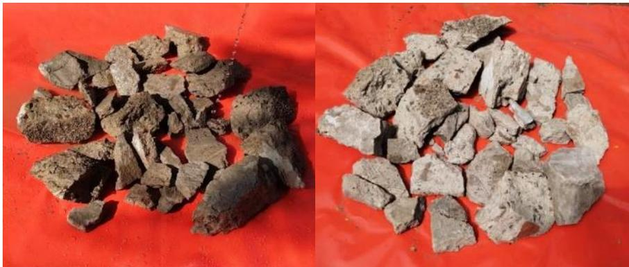
Después se procedió a triturar manual la muestra de RCD-C.
