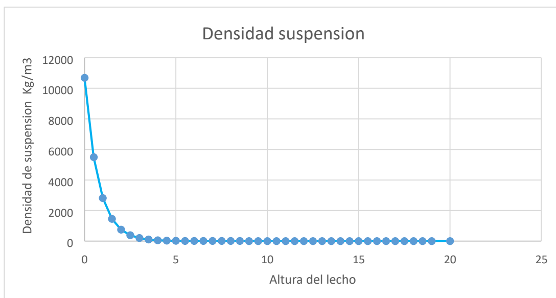
Figura 107 Densidad de suspensión dentro de una caldera de lecho fluidizado circulante. Fuente: Elaboración propia
