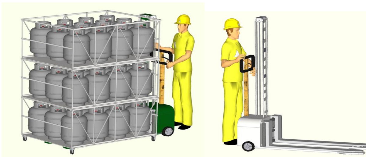
Figura 17A: Diseño 3D de la descarga con apilador semielectrico.
