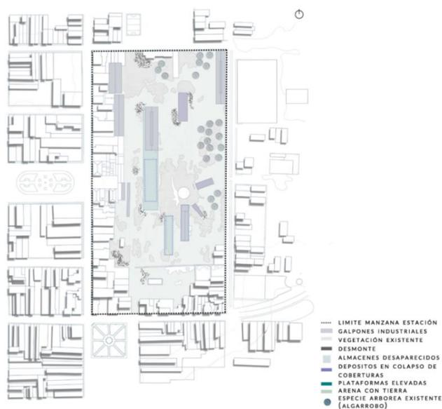
*Figura 16 Identificación de los elementos que componen la estación actualmente. Fuente: Elaboración propia.*
