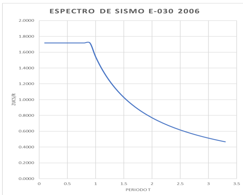
Figura 30: Gráfica de espectros de diseño, del modelo sin muros estructurales (E030 2006)
