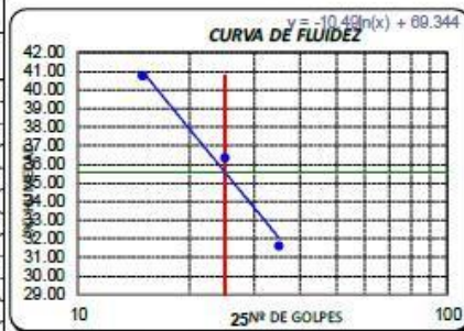
Ensayo de Límite de Atterberg
