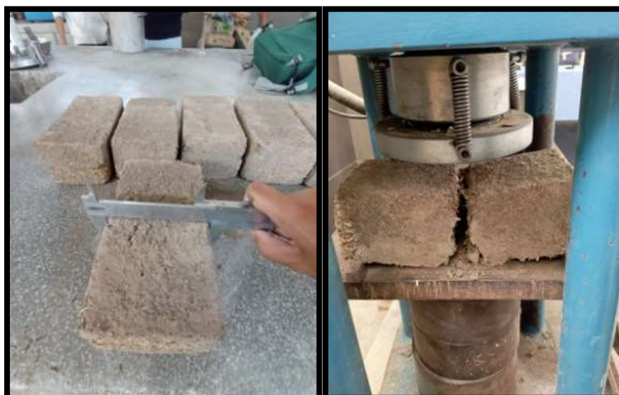
Fig. 70 De izquierda a derecha: Toma de medidas de ancho y espesor de bloques de adobe a ensayar. Adobe ensayado a flexión (módulo de rotura)
