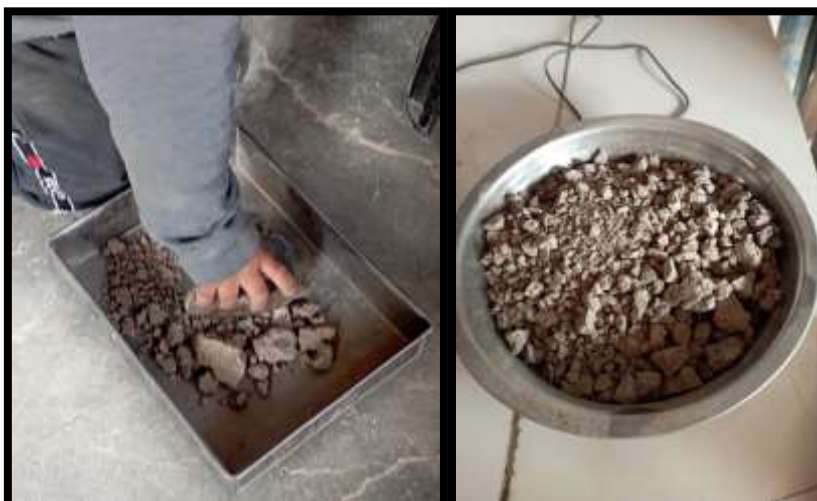
Fig. 33 Preparación de la muestra para la elaboración del ensayo de granulometría
