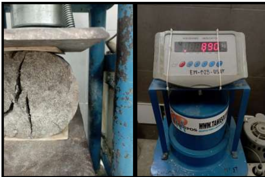
Fig. 46 Ensayo brasileño de tracción a probetas de tierra
