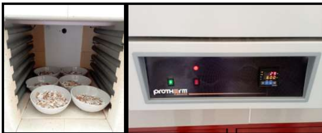
Fig. 64 De izquierda a derecha: Colocación de muestras dentro del horno mufla. Primera combustión por 4 horas a 600° C
