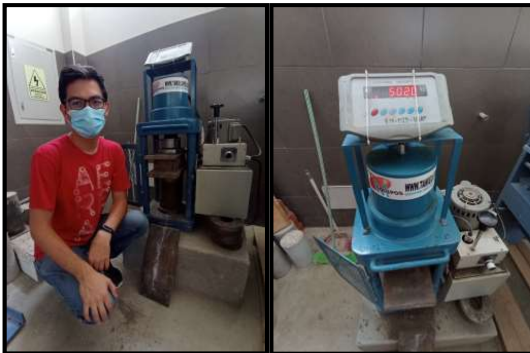
Fig. 62 Aplicación de fuerza compresora a bloques de adobe estabilizados con Consolid 444 y Solidry (Sistema Consolid)
