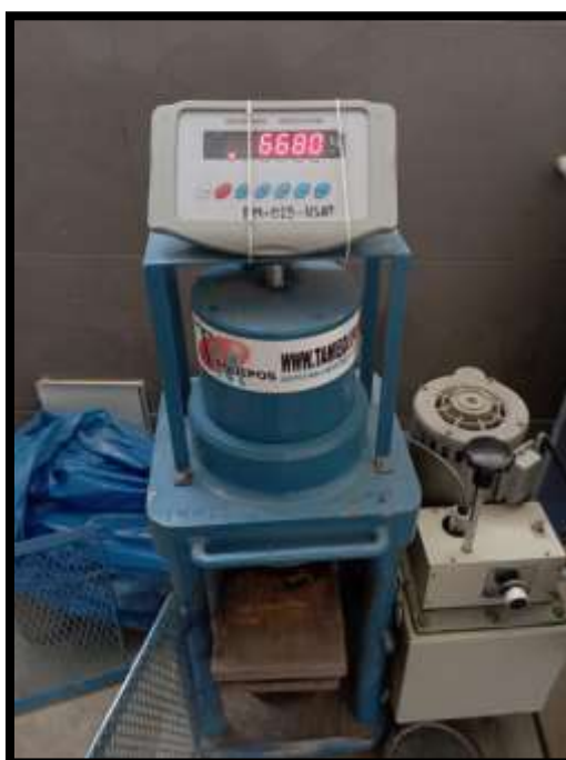
Fig. 69 Aplicación de fuerza compresora a bloques de adobe estabilizados con Consolid 444 y Solidry (Sistema Consolid), y óxido de calcio
