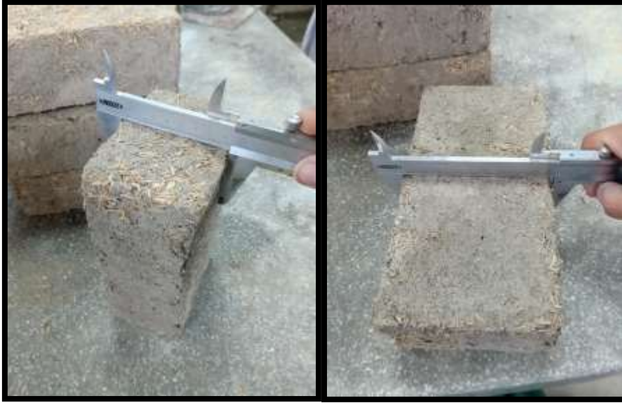
Fig. 80 Medición de la altura y ancho del bloque de adobe
