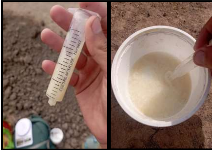
Fig. 53 De izquierda a derecha: Medición de la cantidad de concentrado de aditivo Consolid 444 requerido. Mezclado del concretado en 3 partes de agua
