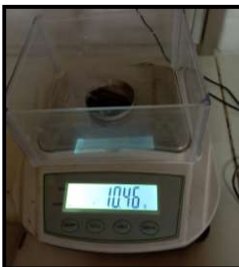
Fig. 38 Pesado de la muestra de bastones realizados para contenido de humedad
