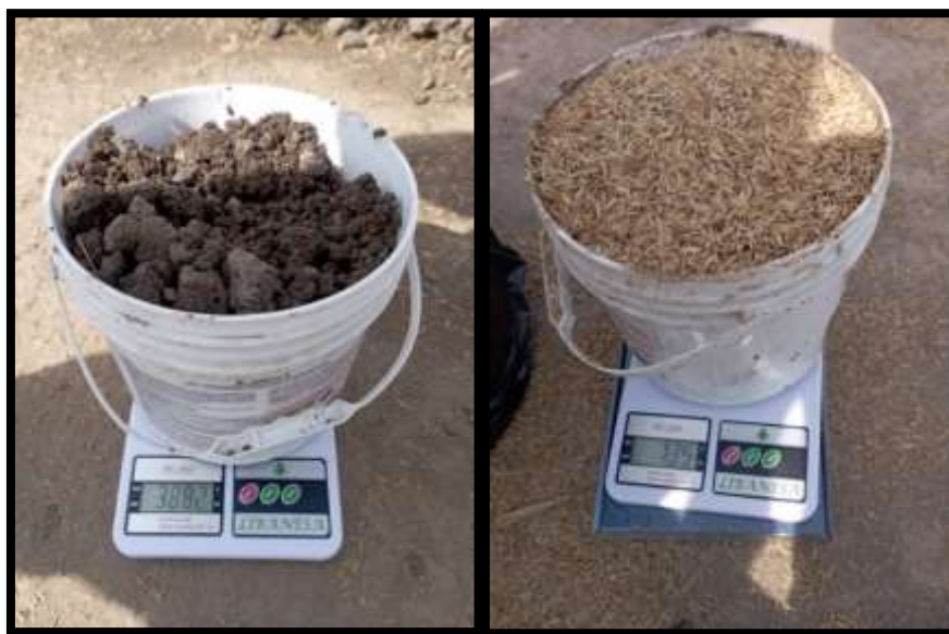
Fig. 47 Pesado de los materiales por balde para la dosificación de bloques de adobe
