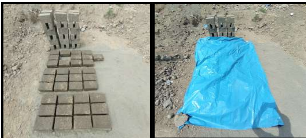
Fig. 55 De izquierda a derecha: Elaboración de los adobes correspondientes para cada dosificación de aditivo Consolid 444. Protección de los adobes frescos con cubierta plástica
