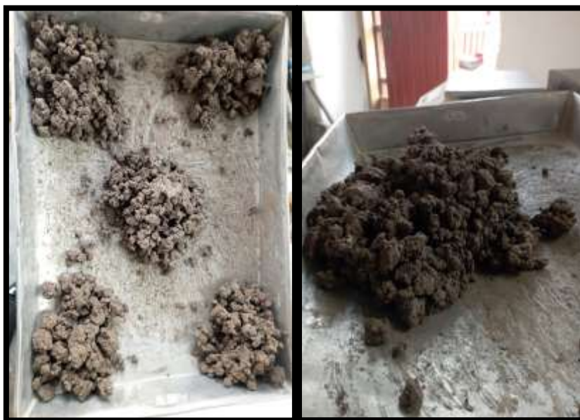
Fig. 40 De izquierda a derecha: Separación de la muestra para incorporar el agua designada progresivamente. Mezclado total de la muestra
