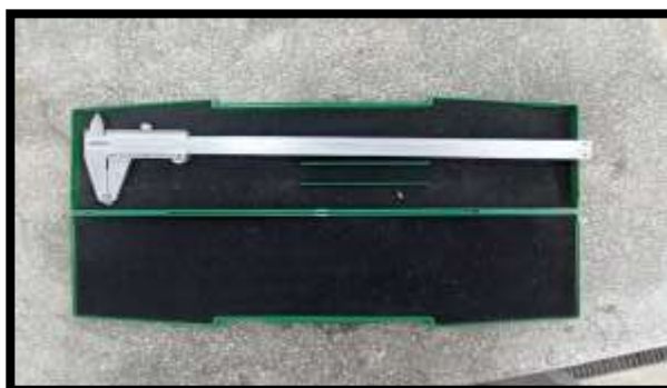
Fig. 79 Vernier utilizado para desarrollar el ensayo de variación dimensional tanto a adobes convencionales como a los estabilizados
