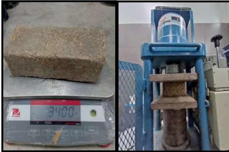
Fig. 51 De izquierda a derecha: Pesado de bloques de adobe previo al ensayo. Aplicación de fuerza de compresión a bloque de adobe convencional
