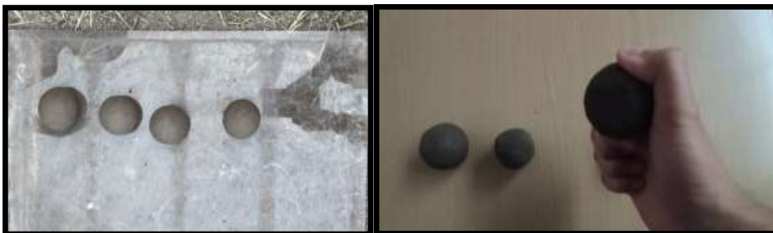
Fig. 30 De izquierda a derecha: Bolitas de barro elaboradas y dejadas a secar para ensayo de presencia de arcilla. Presión aplicada a las bolitas de barro luego de 48 horas de secado para determinar la presencia o no de arcilla en el suelo
