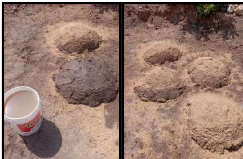
Fig. 67 De izquierda a derecha: Morro de mezcla preparada. Cuatro morros de mezcla correspondiente a cada una de las dosificaciones propuestas del óxido de calcio
