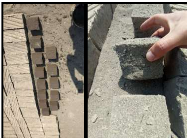
Fig. 42 De izquierda a derecha: Elaboración de cubos de tierra para ensayo de resistencia. Cubos de tierra secos.
