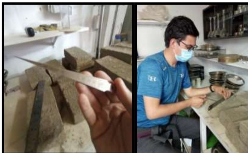
Fig. 71 De izquierda a derecha: Instrumentos de medición empleados para ensayo de alabeo. Toma de medidas de concavidad y convexidad de los bloques de adobe a ensayar
