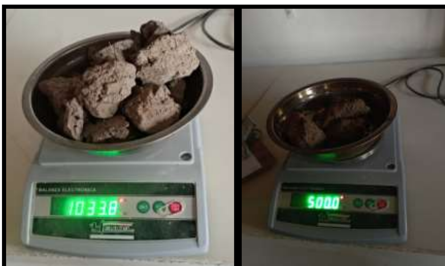
Fig. 32 Muestra pesada, sin considerar la tara del recipiente, pasadas las 24 horas de secado en horno a 110° C
