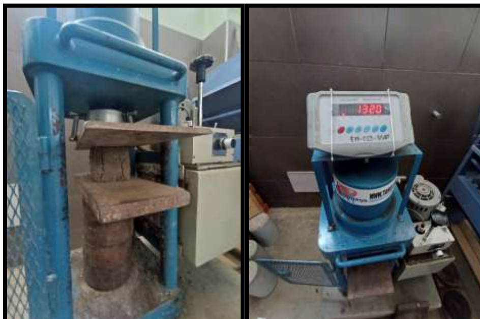
Fig. 43 Ensayo de resistencia frente a la compresión en cubos de tierra
