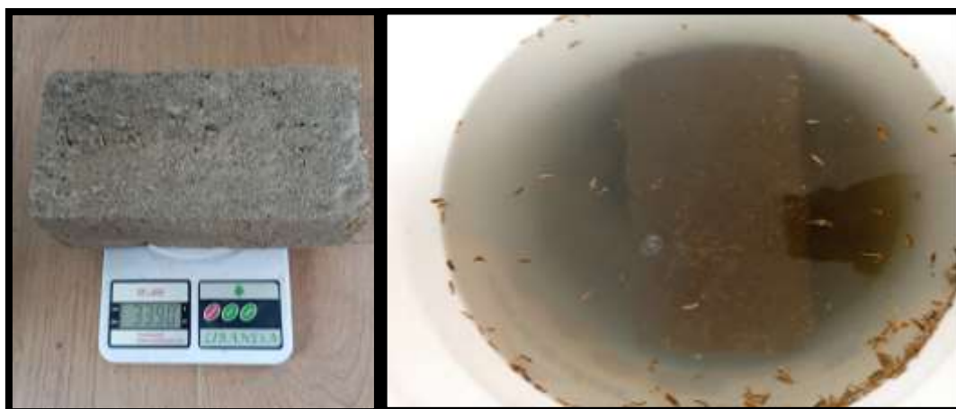
Fig. 72 De izquierda a derecha: Pesado de bloque de adobe completamente seco previo al ensayo de absorción. Sumergido del bloque de adobe en agua limpia por el tiempo destinado para el ensayo
