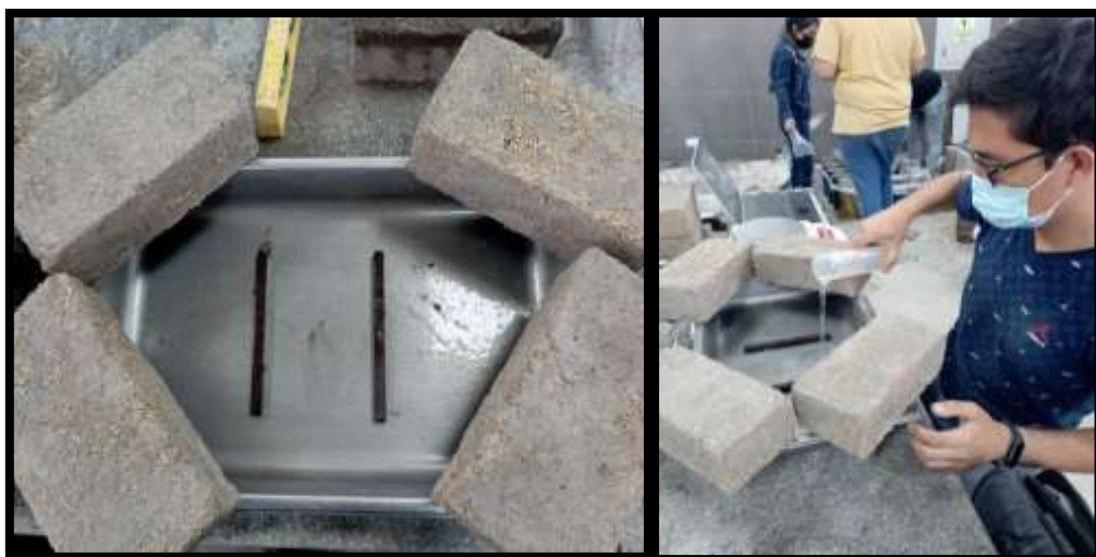
Fig. 75 De izquierda a derecha: Separación de los apoyos a 130 mm. Llenado de la bandeja de agua al nivel de los apoyos y luego a 3 mm por encima de este nivel
