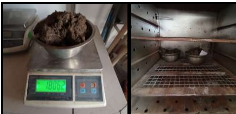
Fig. 31 De izquierda a derecha: Muestra seleccionada y pesada, previo secado, en recipiente sin considerar la tara del recipiente. Muestra llevada a secar por 24 horas en horno a 110° C
