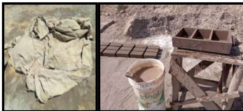
Fig. 60 De izquierda a derecha: Cubierta de la mezcla de adobe por 24 horas previo a en moldado. Elaboración de adobes estabilizados con Sistema Consolid
