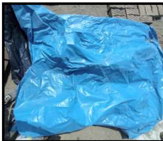
Fig. 61 Cubierta de bloques de adobe estabilizados con Sistema Consolid por 28 días
