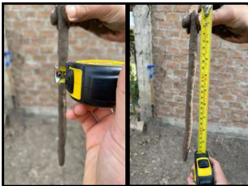
Fig. 28 De izquierda a derecha: Medición del espesor de la tira de barro. Medición de la longitud alcanzada por la tira de barro sin romperse
