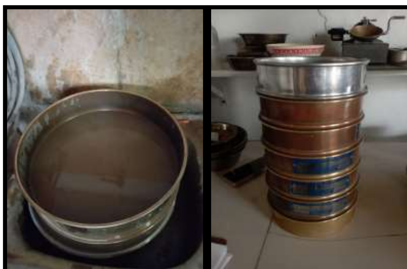
Fig. 34 De izquierda a derecha: Lavado de la muestra y secado por 24 horas en horno a 110° C. Tamizado de la muestra luego del tiempo de secado y registro de pesos retenidos
