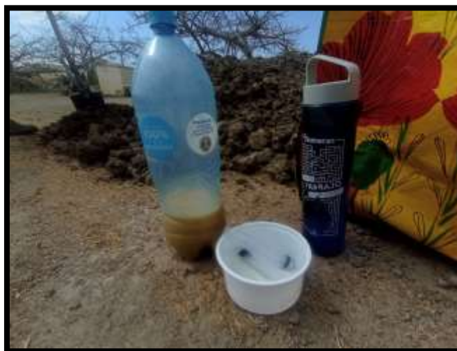
Fig. 52 Materiales empleados para la preparación del aditivo Consolid 444: Concentrado de Consolid 444, agua potable, deposito para realizar el mezclado y jeringas
