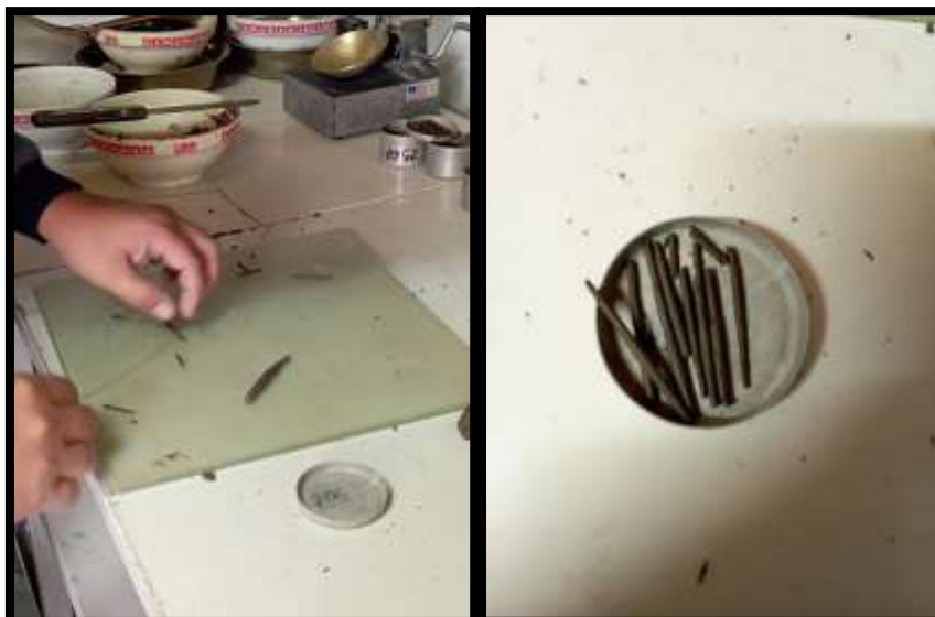
Fig. 37 De izquierda a derecha: Elaboración de bastones con pasante del tamiz N°40. Bastones listos para ser pesados y realizar contenido de humedad
