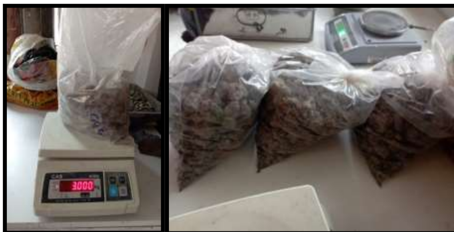
Fig. 39 De izquierda a derecha: Peso de muestra para ensayo Proctor modificado - método "A"
