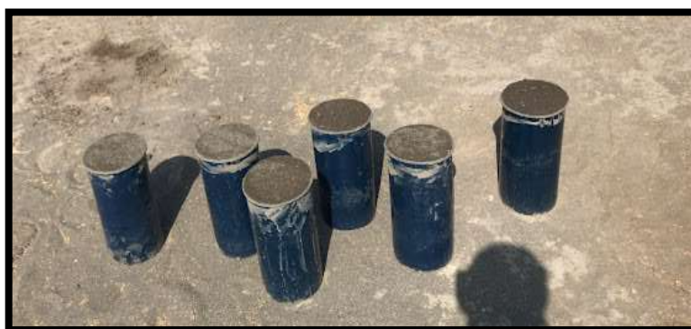
Fig. 44 Elaboración de probetas de barro para ensayo brasileño de tracción
