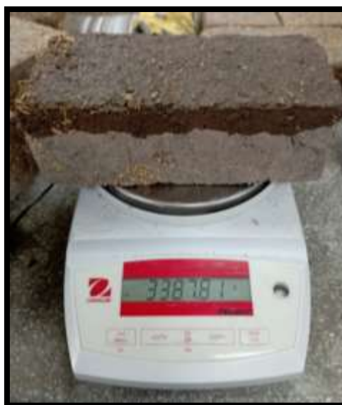
Fig. 77 Pesado del bloque de adobe posterior al ensayo
