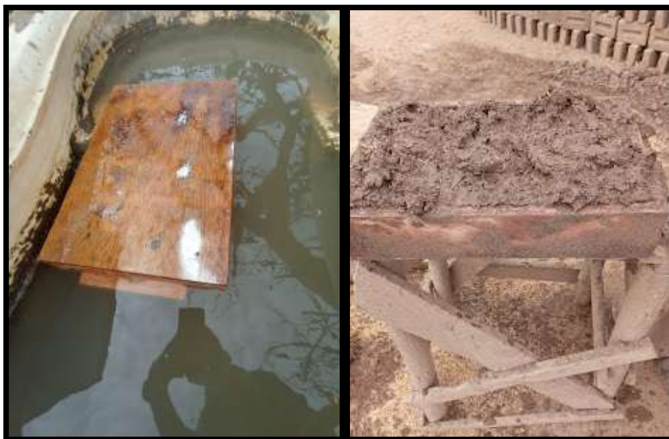
Fig. 49 De izquierda a derecha: Completo humedecimiento del molde de madera previo a moldado. Colocación y enrazado de la mezcla en el molde de madera
