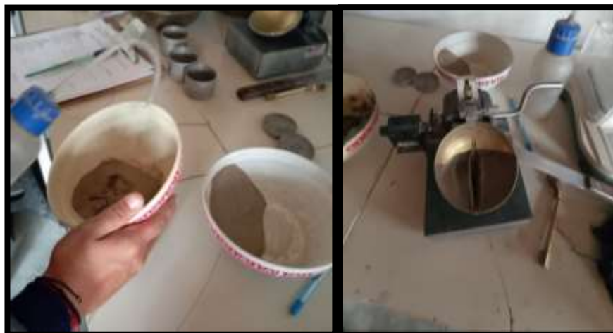
Fig. 35 De izquierda a derecha: Formación de pasta añadiéndole diversas cantidades de agua a la muestra pasante del tamiz N°40. Colocación de la muestra en la copa de Casagrande y realización de ranura central
