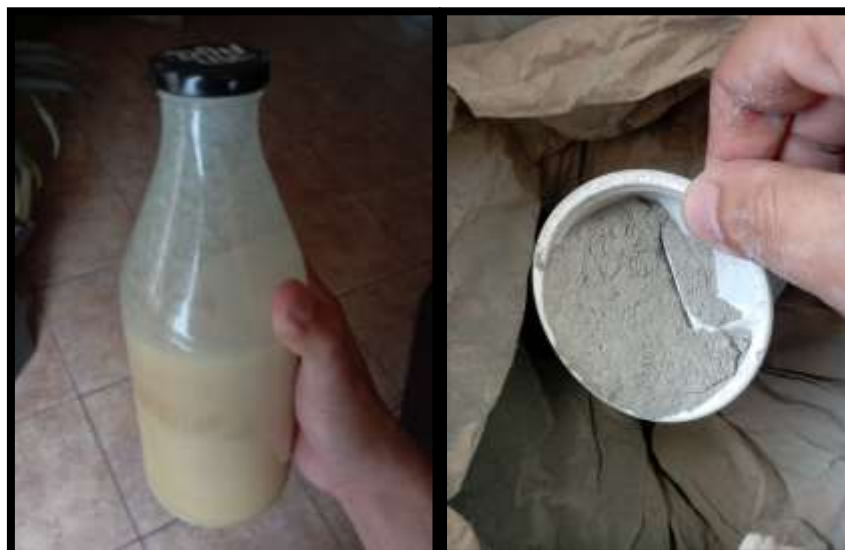
Fig. 25 De izquierda a derecha: Formulación líquida (NLF - Consolid 444). Formulación sólida (NSF - Solidry)
