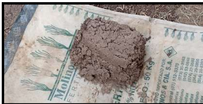
Fig. 27 Humedecimiento de la muestra para elaboración de cilindros de 12 mm de diámetro
