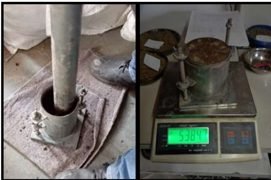
Fig. 41 De izquierda a derecha: Compactación por capas de la muestra en molde (25 golpes por cada capa, un total de 3 capas). Pesado de la muestra para contenido de humedad
