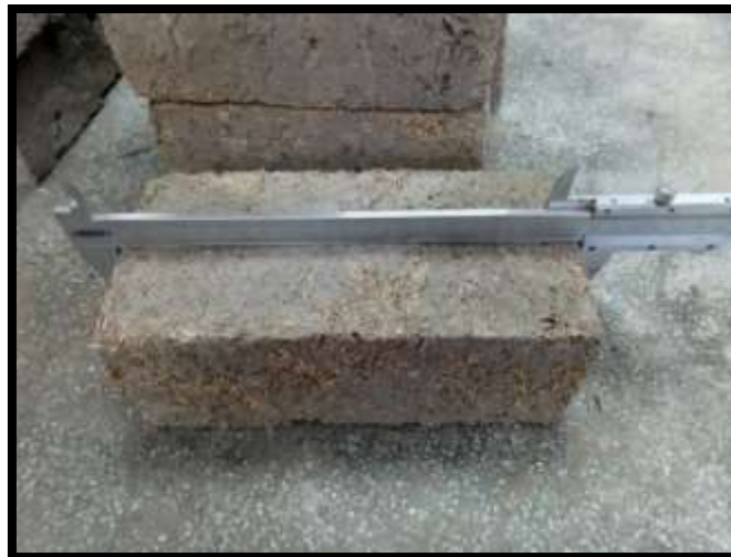
Fig. 81 Medición de la longitud del bloque de adobe
