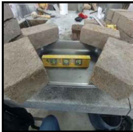
Fig. 74 Nivelación de bandeja metálica con ayuda de 4 bloques de adobe y un nivel de mano
