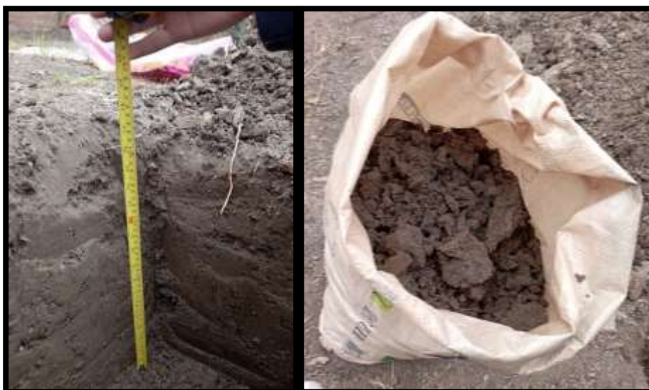
Fig. 23 De izquierda a derecha: Medición de los 30 cm considerados para empezar a extraer la muestra de suelo de interés. Extracción de muestra de suelo para ensayos de laboratorio
