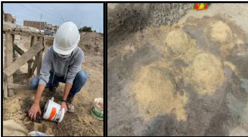
Fig. 54 De izquierda a derecha: Separación de la cantidad de material necesario para la elaboración de los adobes. Morros de mezcla hechos para las 4 dosificaciones del aditivo empleado
