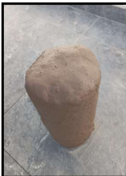
Fig. 45 Probeta de tierra desmoldada a espera de secado
