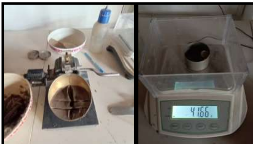
Fig. 36 De izquierda a derecha: Extracción de muestra para contenido de humedad, anotando debidamente los pesos y número de golpes. Pesado de cada muestra correspondiente para contenido de humedad
