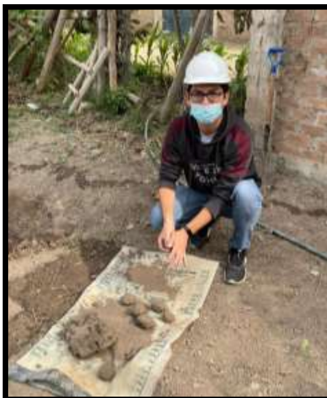
Fig. 29 Elaboración de la mezcla y bolitas de barro para el ensayo de contenido de arcilla
