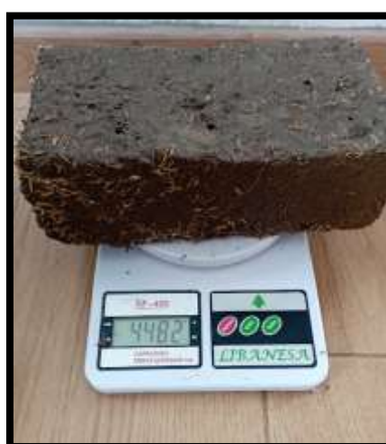
Fig. 73 Pesado de bloque de adobe sumergido completamente en agua posterior al ensayo de absorción
