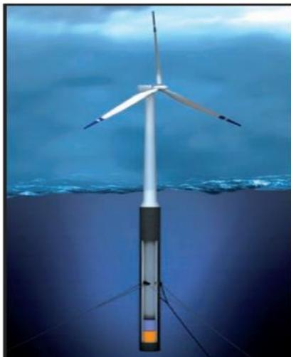
**Gráfico N. °12: Turbina eólica flotante. Fuente: Prospectiva del Sector Eléctrico 2009 – 2018, OSINERGMIN.**
