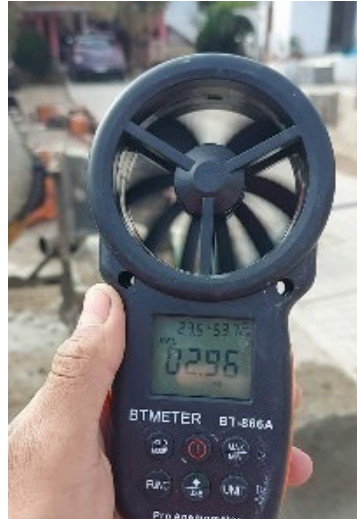
Ilustración 8: Medición de la velocidad del viento con Anemómetro
