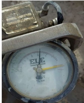
Ilustración 12: Medición del contenido de aire en la olla de Washington
