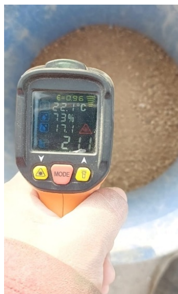
Ilustración 9: Medición de la temperatura con el termómetro infrarrojo
