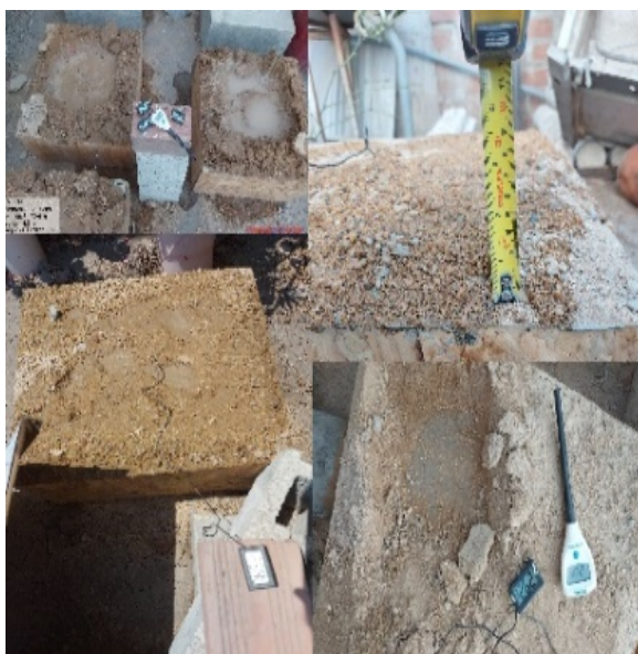
Ilustración 18: Curado con recubrimiento de 3cm de arena fina
