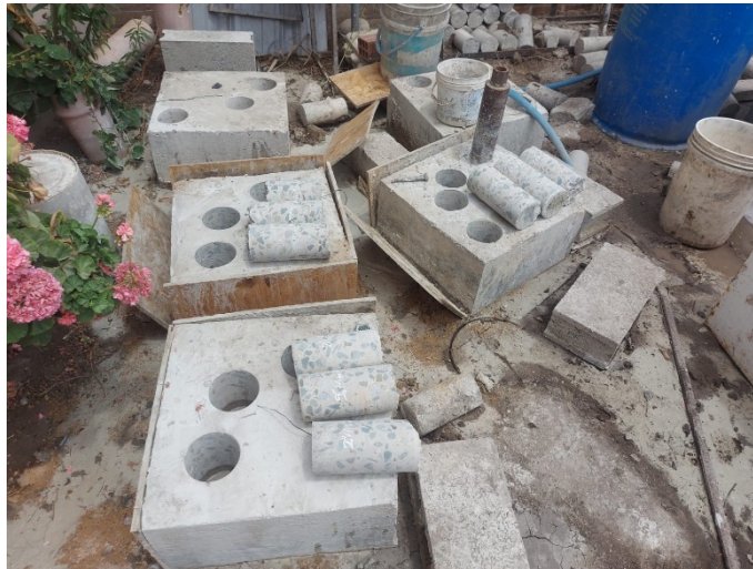
Ilustración 21: Extracción de diamantinas de 4" a los 28 días
