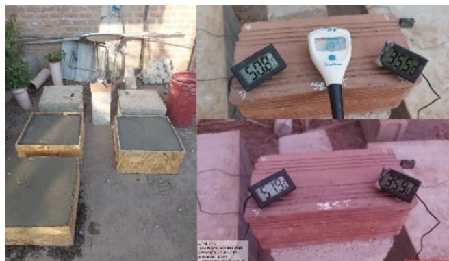
Ilustración 17: Muestras de 0.5 x 0.5 x 0.25, con agua 50°C a 60°C y con a/c=0.5
