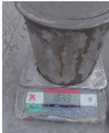
Ilustración 13: Peso unitario del concreto fresco, sin el peso del recipiente
