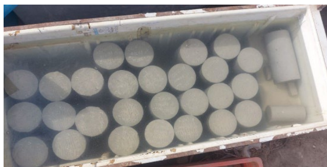
Ilustración 14: Curado de las probetas sumergidas en el agua
