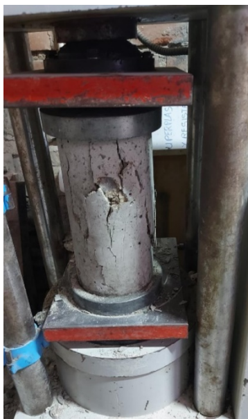
Ilustración 15: Ensayo a compresión de 6" x 12"
