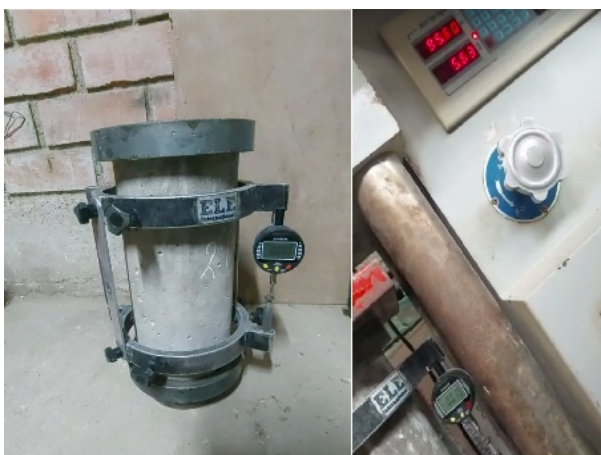
Ilustración 16: Ensayo de módulo de elasticidad de las probetas a 28 días
