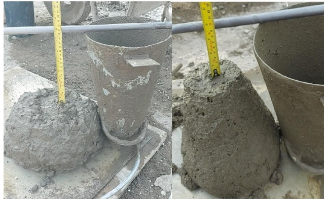
Ilustración 10: Falla de tipo normal en el ensayo de Slump
