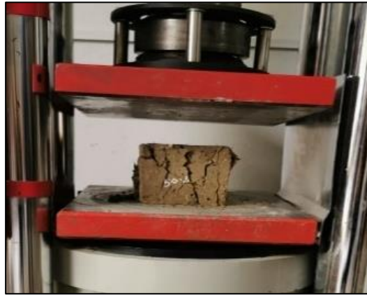
Imagen 19: Adobe con 0.50% de acículas de pino, sometido al ensayo a compresión. Fuente: Propia.
