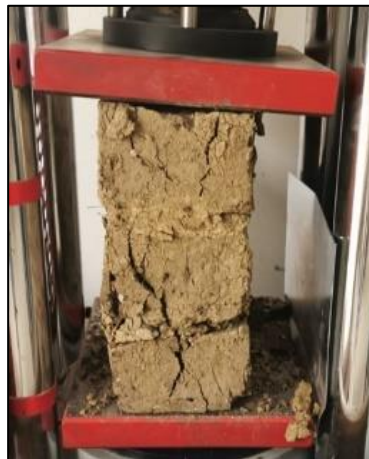
Imagen 28: Adobe con 0.75% de acículas de pino, sometido al ensayo de murete a la compresión. Fuente: Propia.
