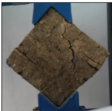
Imagen 32: Adobe con 0.75% de acículas de pino, sometido al ensayo de murete a la tracción indirecta.
