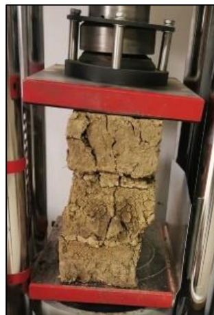
Imagen 29: Adobe con 1.00% de acículas de pino, sometido al ensayo de murete a la compresión. Fuente: Propia.
