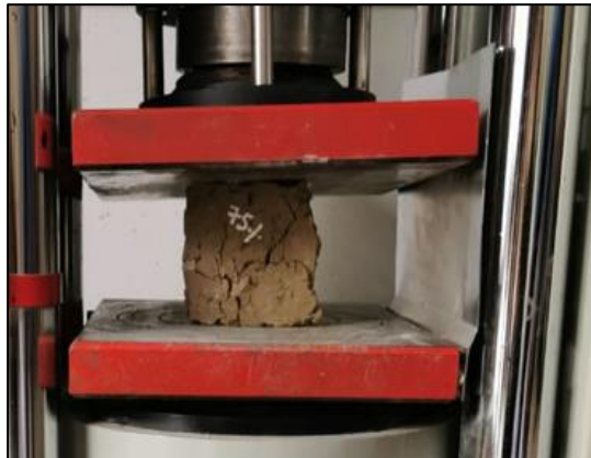
Imagen 20: Adobe con 0.75% de acículas de pino, sometido al ensayo a compresión. Fuente: Propia.
