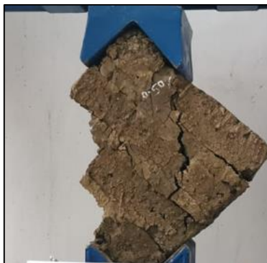
Imagen 31: Adobe con 0.50% de acículas de pino, sometido al ensayo de murete a la tracción indirecta.
