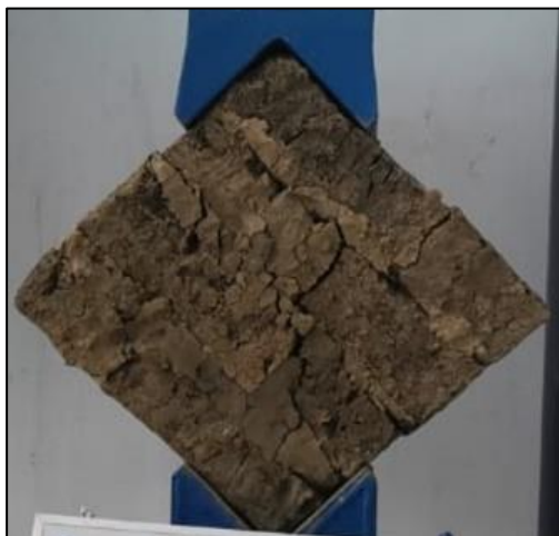
Imagen 30: Adobe tradicional, sometido al ensayo de murete a la tracción indirecta.
