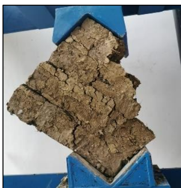
Imagen 33: Adobe con 1.00% de acículas de pino, sometido al ensayo de murete a la tracción indirecta.
