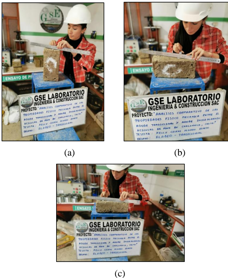
Imagen 10: Ensayo de Alabeo. (a) Medición del alabeo en la altura del adobe. (b) Medición del alabeo en el borde. (c) Medición del alabeo en la cara superior. Fuente: Propia.
