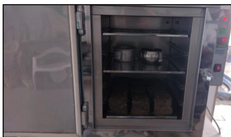
Imagen 11: Secado del adobe en el horno eléctrico. Fuente: Propia.
