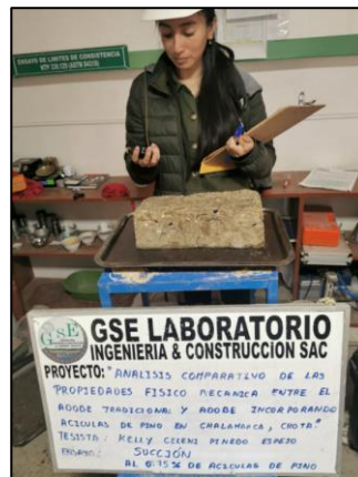
Imagen 13: Toma del tiempo para succión del agua del adobe. Fuente: Propia.
