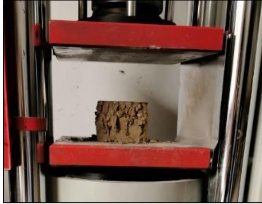
Imagen 18: Adobe tradicional, sometido al ensayo a compresión. Fuente: Propia.
