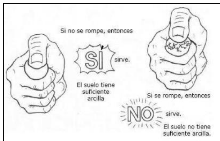
Ilustración 15: Prueba de la Resistencia Seca.
