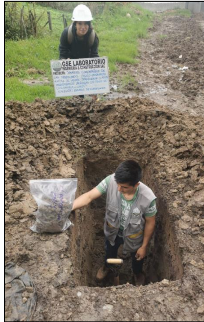
Imagen 1: Calicata para el Ensayo de Mecánica de Suelos. Fuente: Propia.
