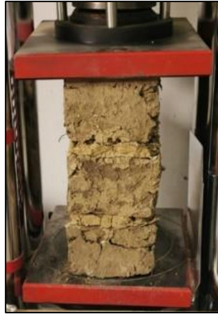
Imagen 27: Adobe con 0.50% de acículas de pino, sometido al ensayo de murete a la compresión. Fuente: Propia.
