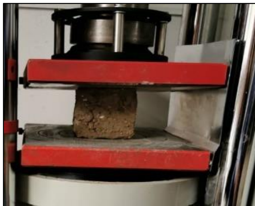
Imagen 21: Adobe con 1.00% de acículas de pino, sometido al ensayo a compresión. Fuente: Propia.
