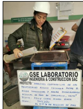
Imagen 12: Vaciado de agua en la bandeja para realizar el ensayo. Fuente: Propia.
