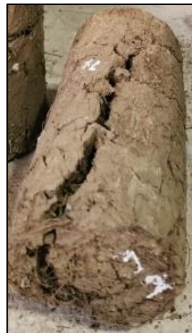
Imagen 25: Adobe con 1.00% de acículas de pino, sometido al ensayo a tracción. Fuente: Propia.
