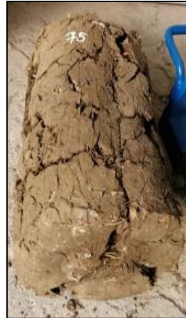
Imagen 24: Adobe con 0.75% de acículas de pino, sometido al ensayo a tracción. Fuente: Propia.
