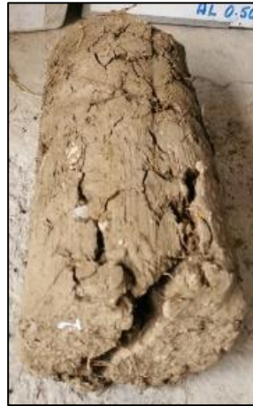
Imagen 23: Adobe con 0.50% de acículas de pino, sometido al ensayo a tracción. Fuente: Propia.
