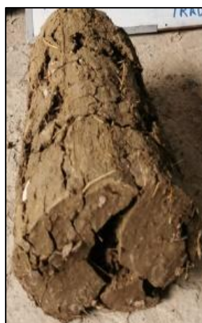
Imagen 22: Adobe tradicional, sometido al ensayo a tracción. Fuente: Propia.
