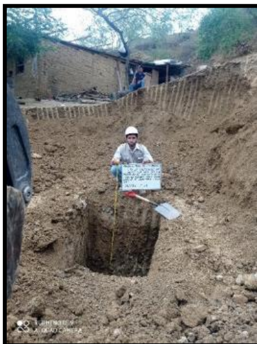
Ilustración 29: Tesista-Calicata 01-Profundidad 1.5 m
