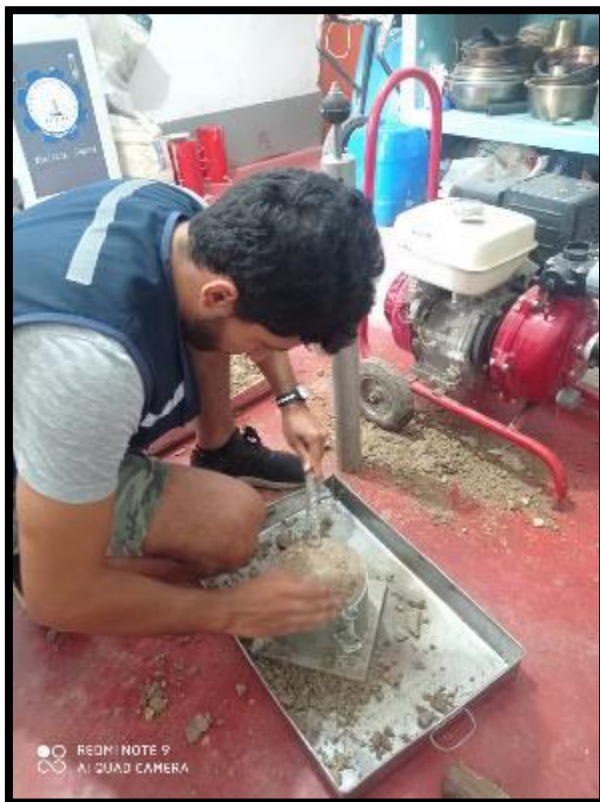
Ilustración 16: RETIRANDO LA MUESTRA DEL MOLDE CON UN CINSEL
