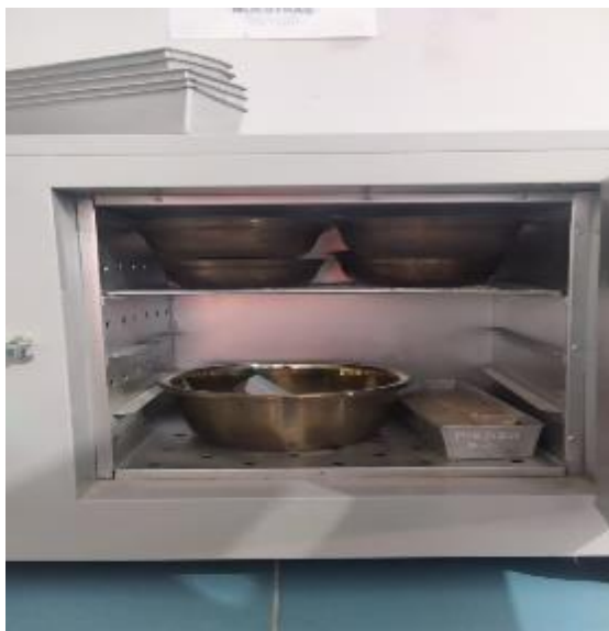
Ilustración 8: MUESTRA DE SUELO AL HORNO A 110°C, PARA POSTERIORMENTE SACAR EL CONTENIDO DE HUMEDAD
