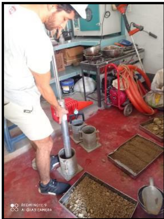
Ilustración 25: REALIZANDO ENSAYOS DE CBR.
