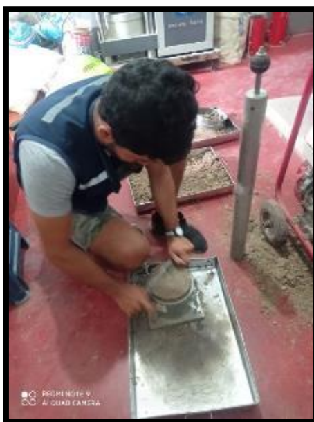
Ilustración 15: RETIRANDO LA MUESTRA DEL MOLDE, DESPUÉS DE LA COMPACTACIÓN
