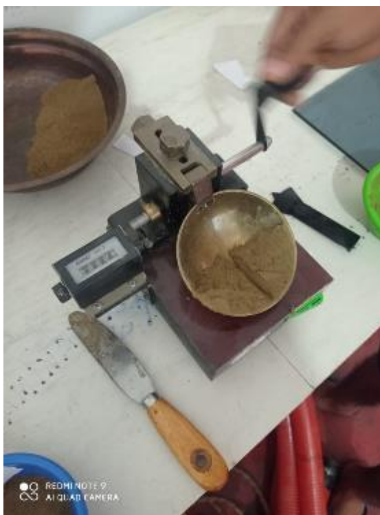
Ilustración 10: LÍMITE LÍQUIDO POR NÚMERO DE GOLPES
