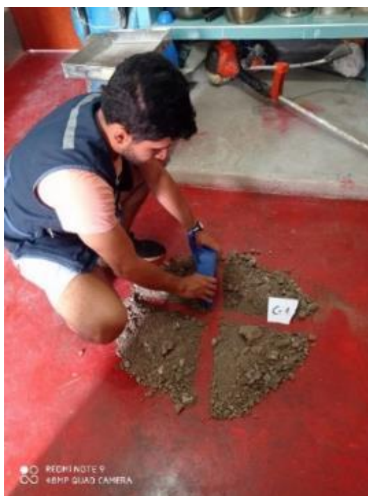
Ilustración 5: CUARTEO DE LAS MUESTRAS
