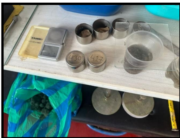
Figura 109. Materiales para ensayo de sulfatos
