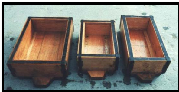
Figura 3. Molde de adobe con fondo, medidas internas 30x30x8cm
