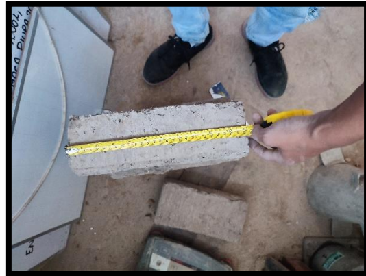
Figura 138. Unidades de albañilería – medida de la longitud
