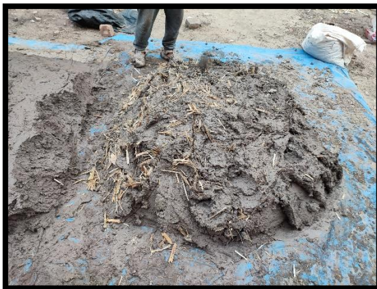
Figura 38. Dormido totalmente saturado
