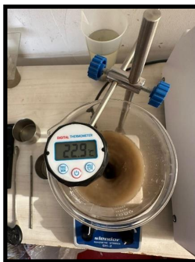
Figura 110. Ensayo de sulfatos al agua
