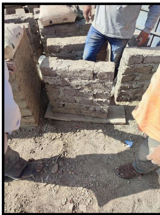
Figura 158. Izaje parte 2 – Ensayo de resistencia a la tracción indirecta
