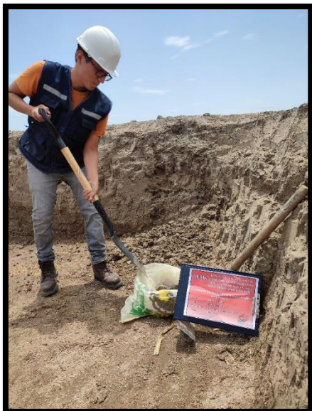
Figura 12. Extracción de suelo para ensayar en la cantera "Buenos Aires"
