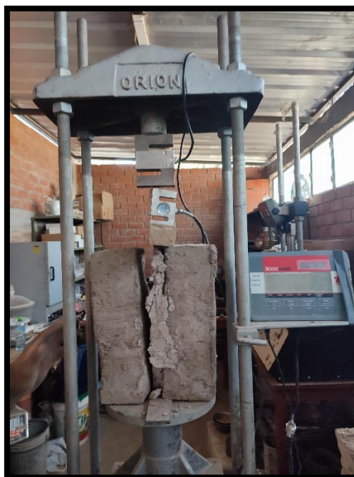
Figura 164. Espécimen después del ensayo de resistencia del mortero a tracción indirecta
