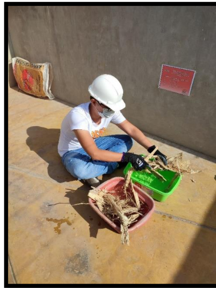
Figura 100. Remoje y lavado del material “bagazo de caña de azúcar”
