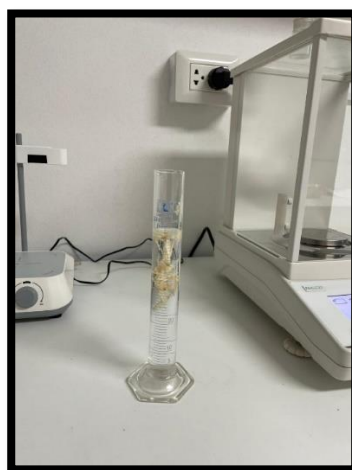
Figura 132. Registro de densidad utilizando gravimetría -Rivelab laboratorio
