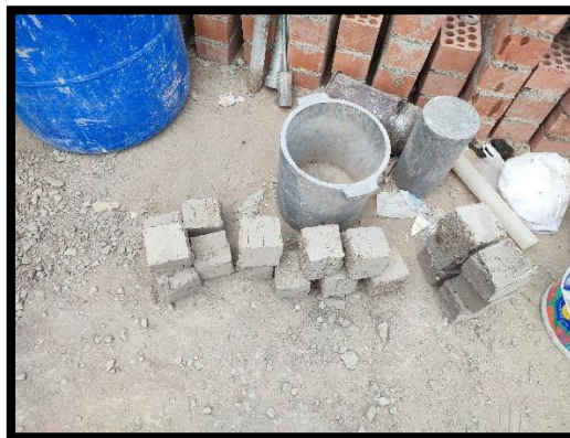
Figura 148. Unidades cúbicas después el ensayo de compresión
