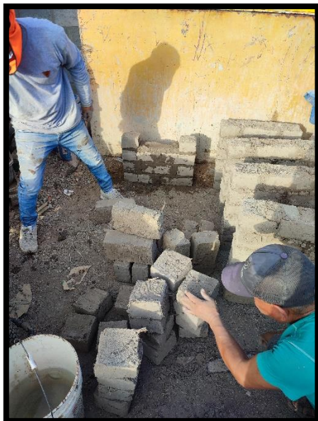
Figura 155. Perfilando las mitades de los adobes – Ensayo de resistencia a la tracción indirecta
