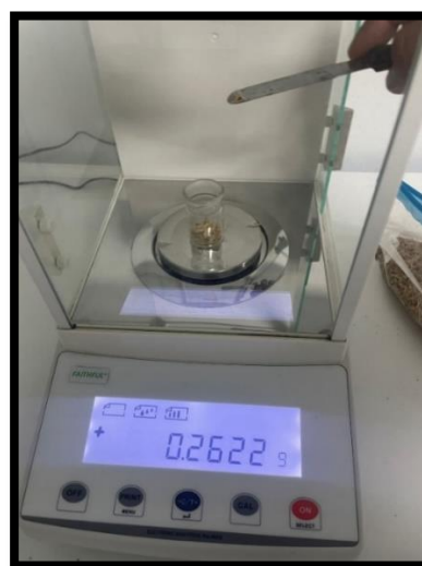
Figura 131. Registro de densidad del bagazo de caña de azúcar incinerado -Rivelab laboratorio
