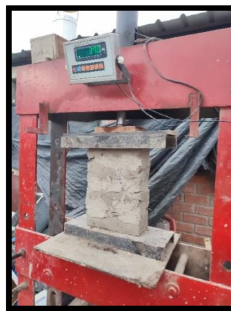
Figura 154. Pila de adobe sobre la maquina compresora
