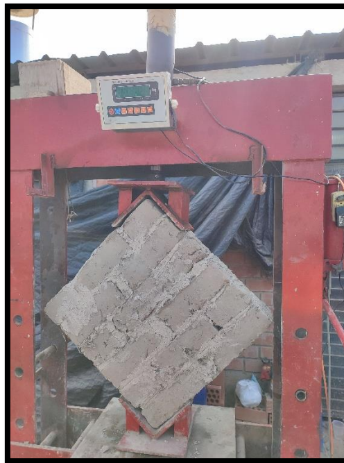
Figura 160. Espécimen en la maquina listo para ensayar – Ensayo de resistencia a la tracción indirecta
