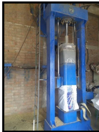
Figura 66. Máquina de compresión de pilas de cáscara de arroz en el molino "MOLINOR"
