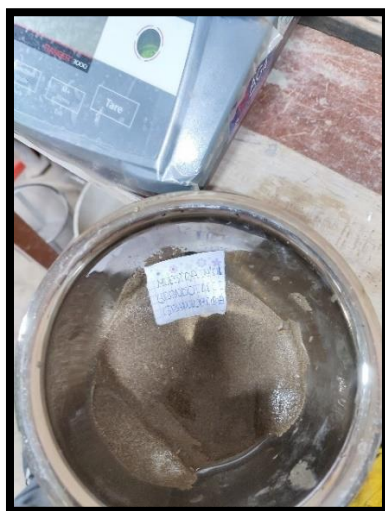
Figura 117. Recipiente con muestra lavada lista para el horno
