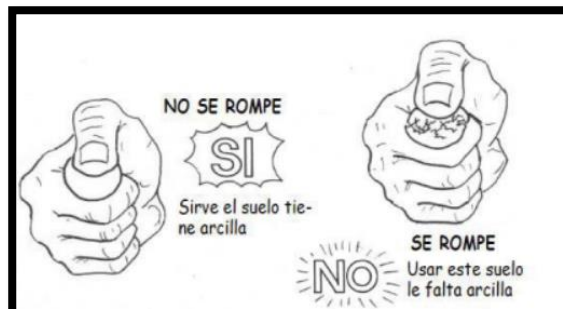
Figura 106. Resultados de la prueba “presencia de arcilla”
