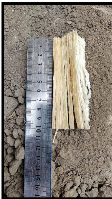
Figura 94. Longitud empleada para la fibra vegetal "bagazo de caña de azúcar"
