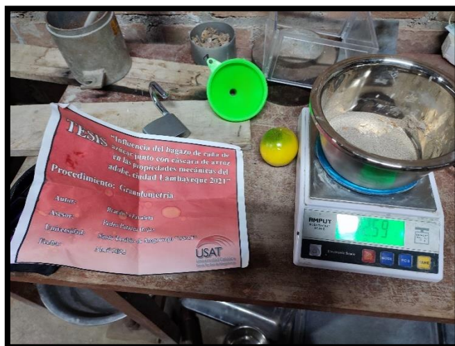
Figura 118. Registro del peso del material suelo seco lavada
