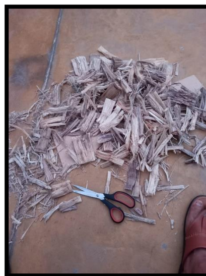
Figura 102. Recortando la fibra vegetal a una longitud de 10cm
