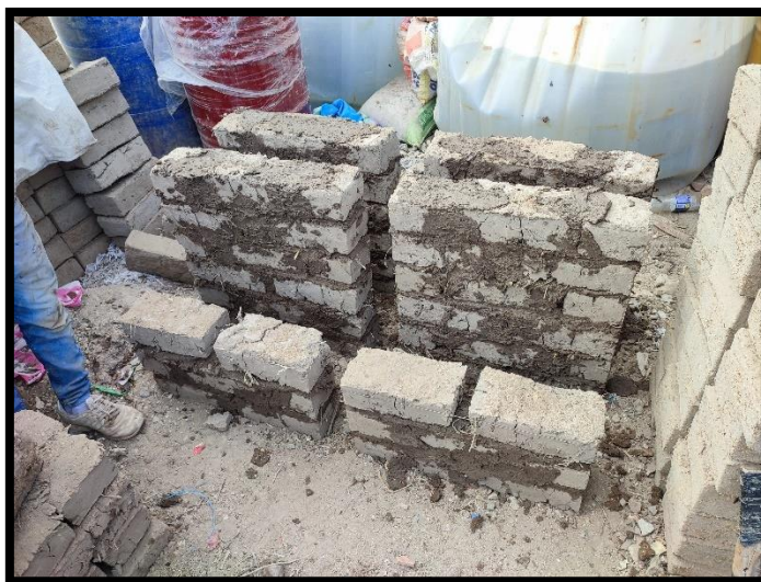
Figura 156. Construcción de muretes – Ensayo de resistencia a la tracción indirecta
