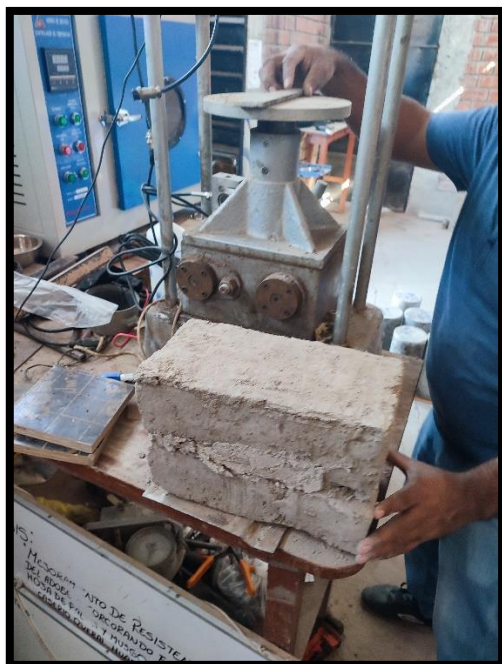
Figura 163. Espécimen para ensayo de resistencia del mortero a tracción indirecta
