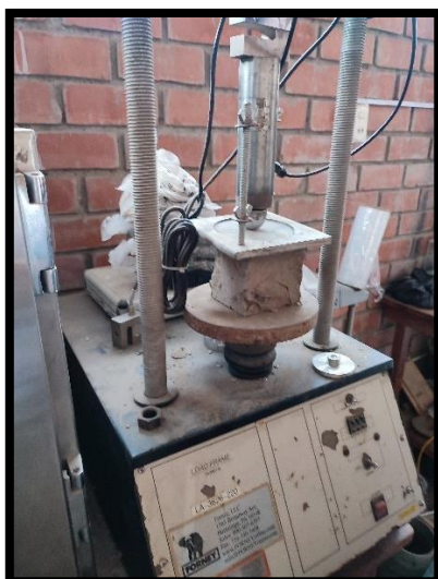
Figura 145. Unidad cúbica instalada para realizar el ensayo de compresión
