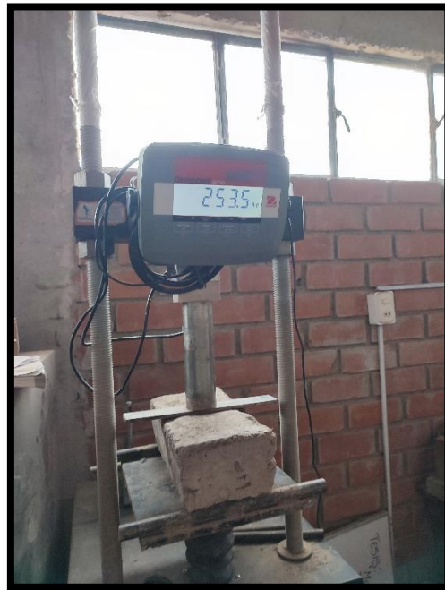
Figura 150. Máquina compresora en medio de un ensayo de flexión
