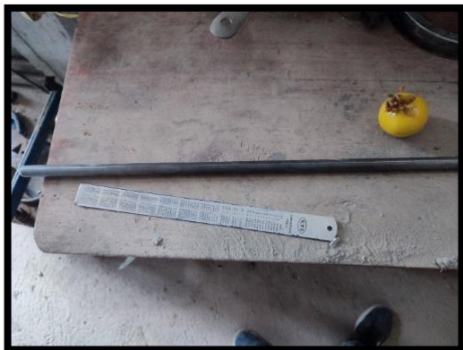
Figura 141. Regla metálica y varilla con punta redondeada – “ensayo de alabeo”
