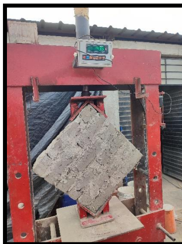
Figura 56. Ejemplo real de muretes para calcular el esfuerzo de rotura a compresión diagonal
