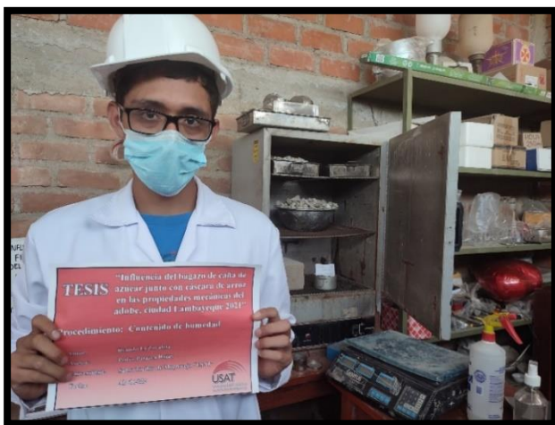
Figura 126. Muestra en el horno para ensayo de contenido de humedad
