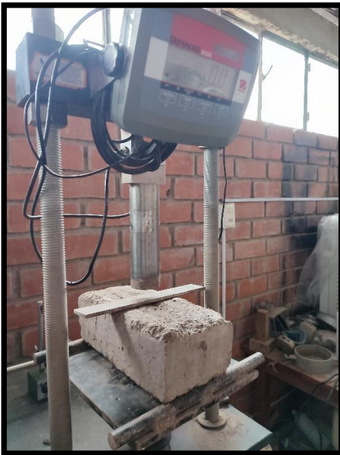
Figura 149. Unidad de albañilería instalada para realizar el ensayo de flexión
