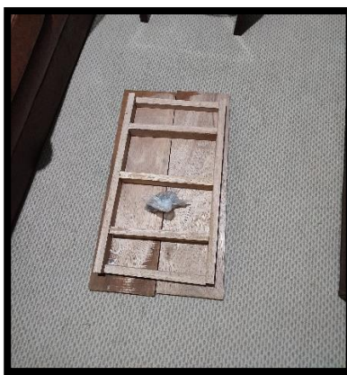
Figura 15. Madera y clavos para la fabricación del molde para adobes
