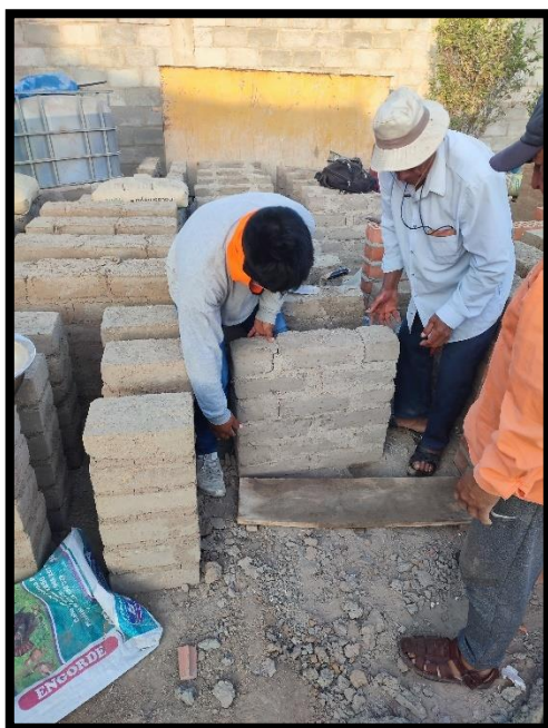
Figura 157. Izaje del espécimen – Ensayo de resistencia a la tracción indirecta
