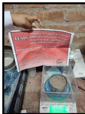
Figura 127. Peso de la muestra después de secarse en el horno
