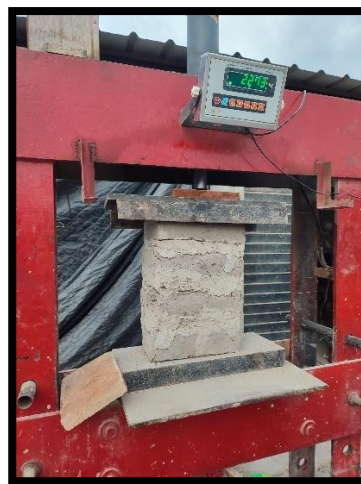
Figura 53. Ejemplo real de pilas para medir la rotura mínima a la compresión
