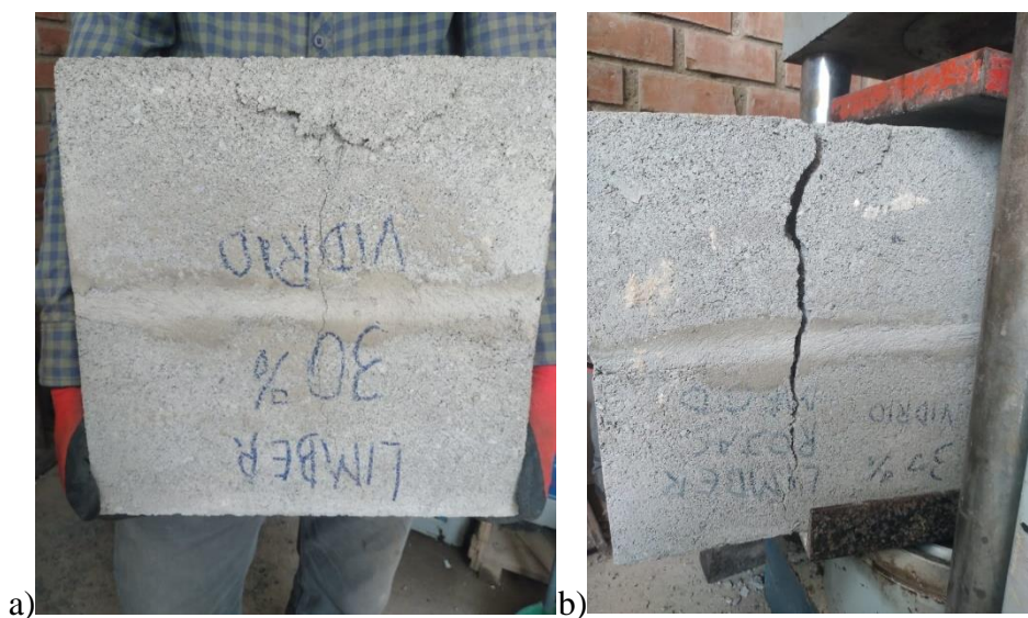
Figura N°55. Falla de pilas con 30 % de vidrio molido
