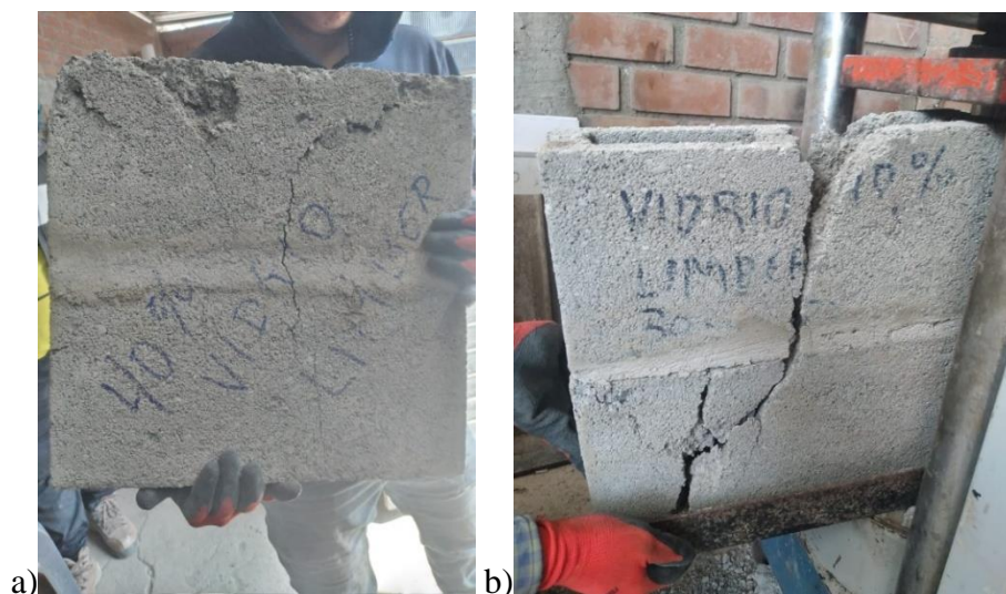
Figura N°57. Falla de pilas con 40 % de vidrio molido
