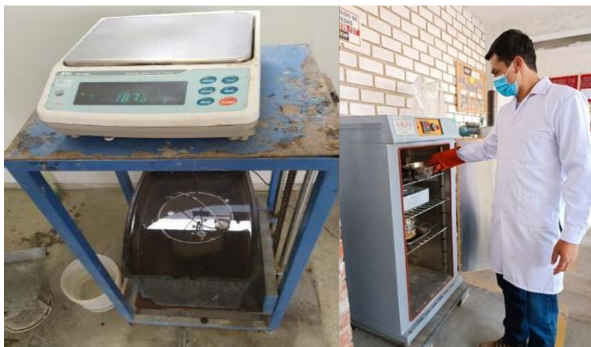
Figura N°13. Ensayo de peso específico del confitillo
