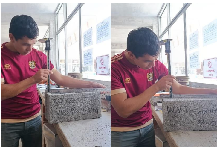
Figura N°42. Ensayo de alabeo de los bloques con 30 % vidrio molido
