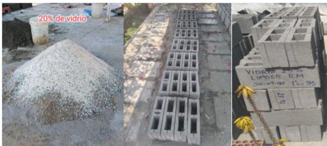
Figura N°23. Mezclado, elaboración y curado de bloques con 20% de vidrio molido
