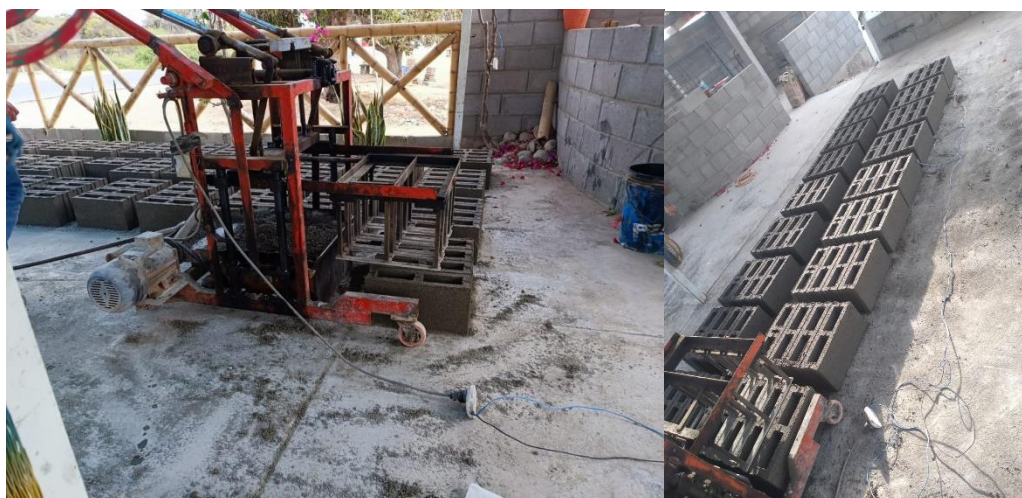
Figura N°19. Colocación de máquina para fabricación de bloques de diseño patrón
