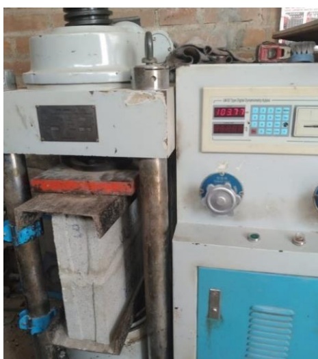
Figura N°56. Ensayo a compresión axial de pilas con 40 % de vidrio molido
