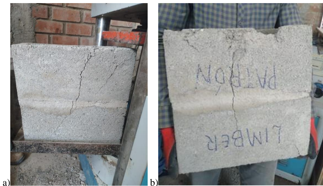
Figura N°51. Falla de pilas patrón
