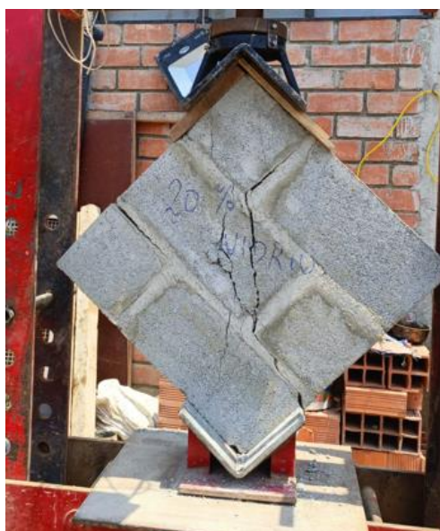
Figura N°61. Ensayo a compresión diagonal de murete con 20 % vidrio molido
