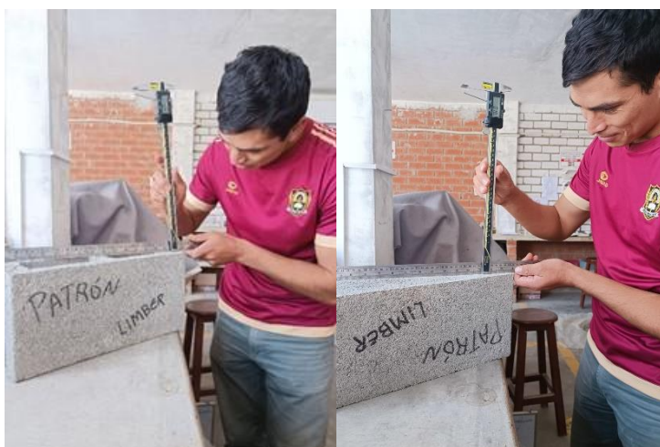
Figura N°40. Ensayo de alabeo de los bloques patrón
