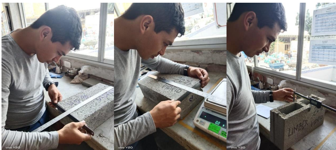
Figura N°45. Ensayo de variación dimensional de bloques de concreto con 20 % de vidrio molido
