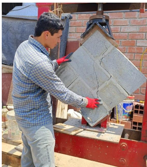
Figura N°60. Ensayo a compresión diagonal de murete patrón
