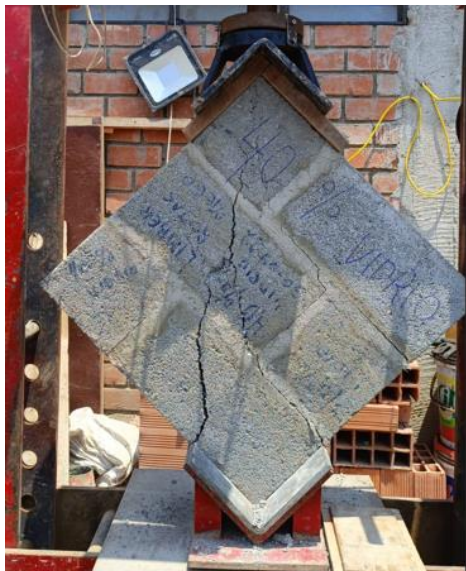
Figura N°63. Ensayo a compresión diagonal de murete con 40 % vidrio molido
