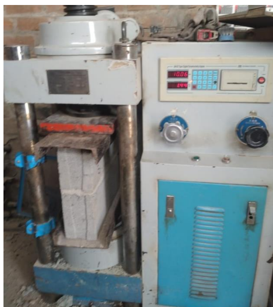
Figura N°50. Ensayo a compresión axial de pilas patrón
