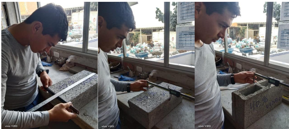
Figura N°47. Ensayo de variación dimensional de bloques de concreto con 40 % de vidrio molido
