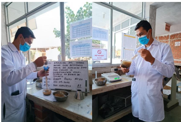
Figura N°12. Grado de absorción de la arena
