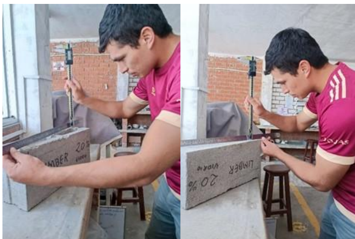
Figura N°41. Ensayo de alabeo de los bloques con 20% vidrio molido
