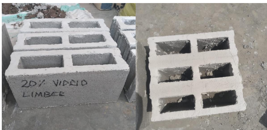
Figura N°24. Refrentado de los bloques con 20 % de vidrio molido
