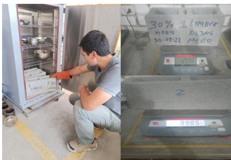
Figura N°37. Condiciones secas de los bloques con 30 % vidrio molido
