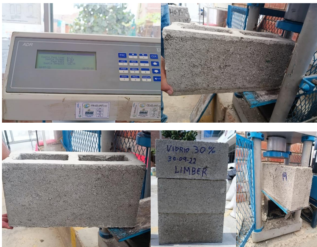
Figura N°28. Ensayo a compresión de bloques con 30 % vidrio molido
