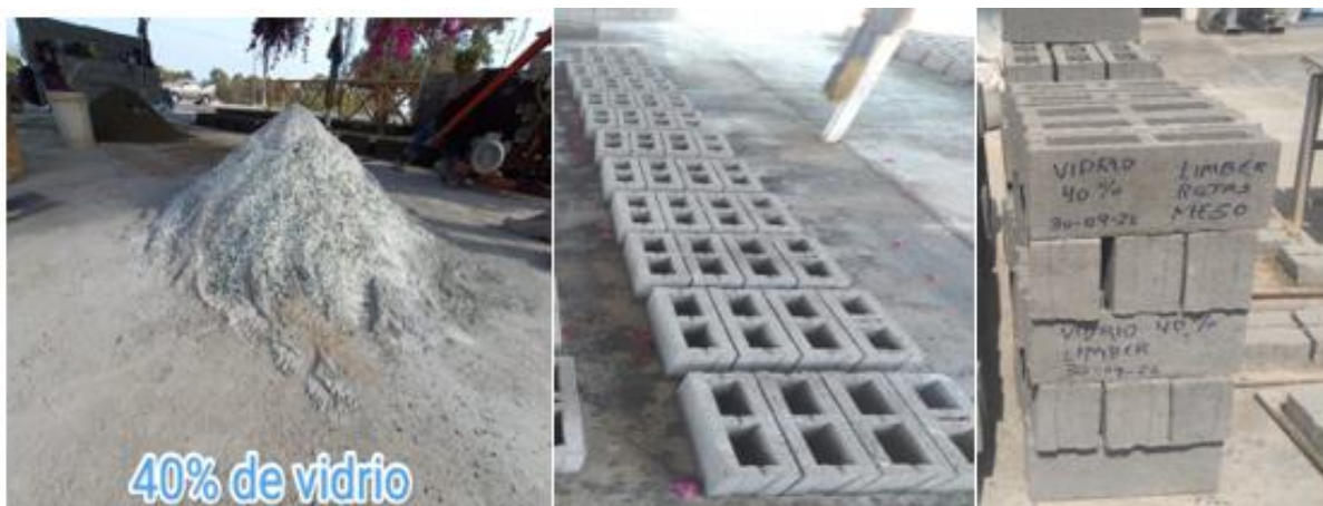
Figura N°29. Mezclado, elaboración y curado de bloques con 40 % vidrio molido
