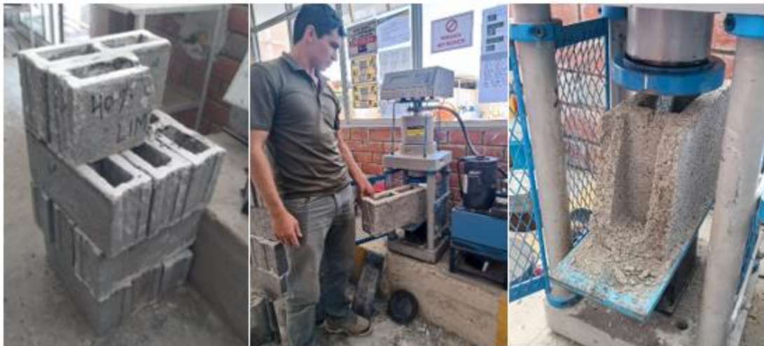
Figura N°68. Ensayo de compresión de los bloques
