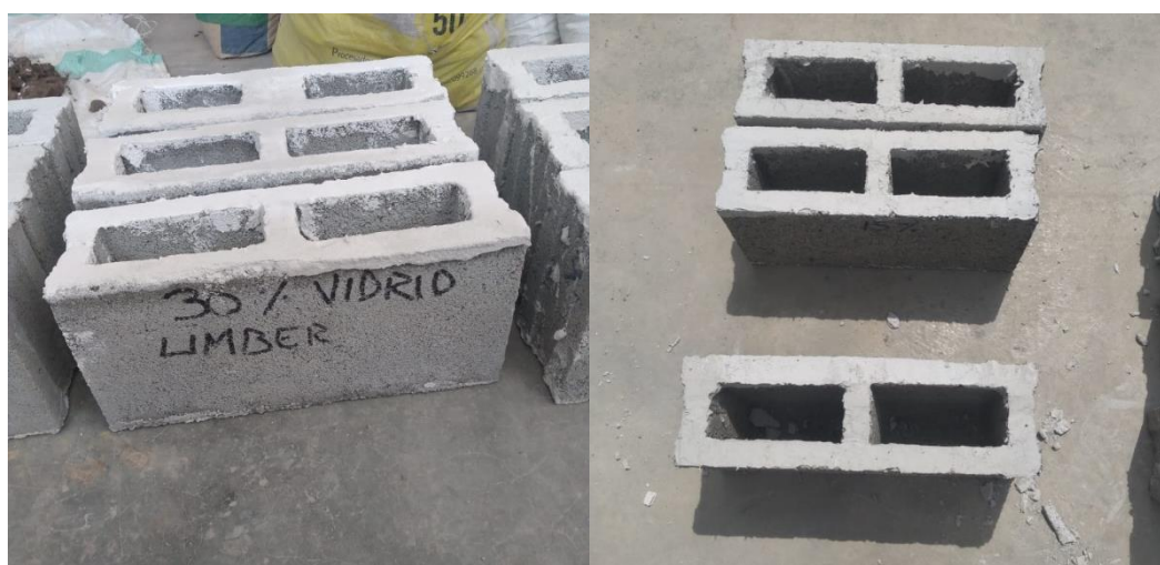
Figura N°27. Refrentado de los bloques de concreto con 30 % de vidrio
