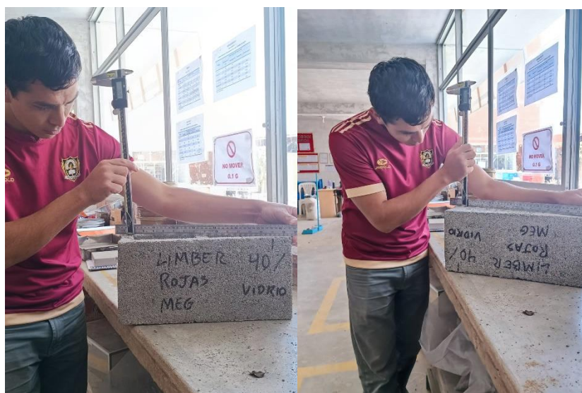
Figura N°43. Ensayo de alabeo de los bloques con 40% de vidrio molido
