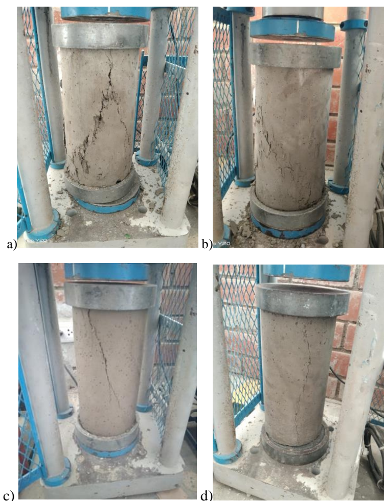
Figura N°18. Ensayo de resistencia a la compresión de probetas
