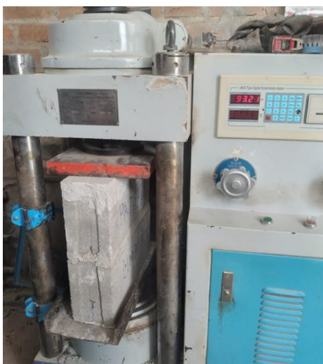
Figura N°52. Ensayo a compresión axial de pilas con 20 % de vidrio molido
