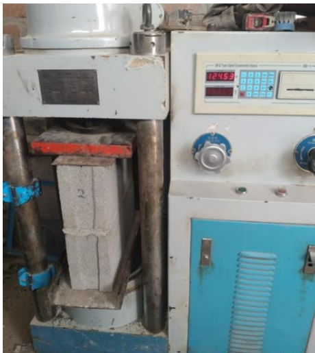
Figura N°54. Ensayo a compresión axial de pilas con 30 % de vidrio molido
