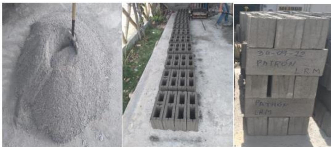
Figura N°20. Mezclado, fabricación y curado de bloques de diseño patrón
