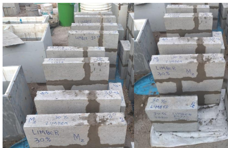
Figura N°58. Elaboración de muretes para todas las muestras
