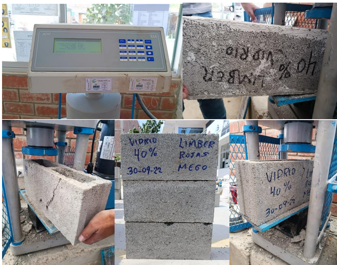
Figura N°31. Ensayo a compresión de bloques con 40 % vidrio molido
