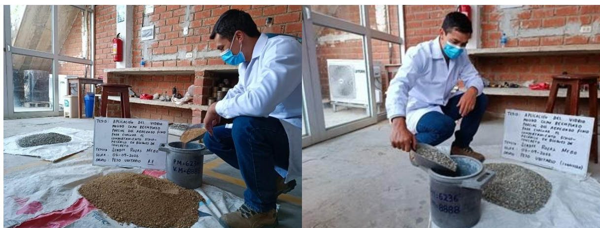
Figura N°14. Ensayo del peso unitario suelto de la arena y confitillo
