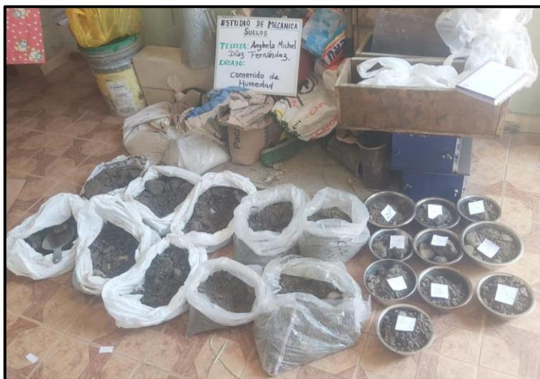
Figura N° 24: Muestras para ensayo de Contenido de Humedad.
