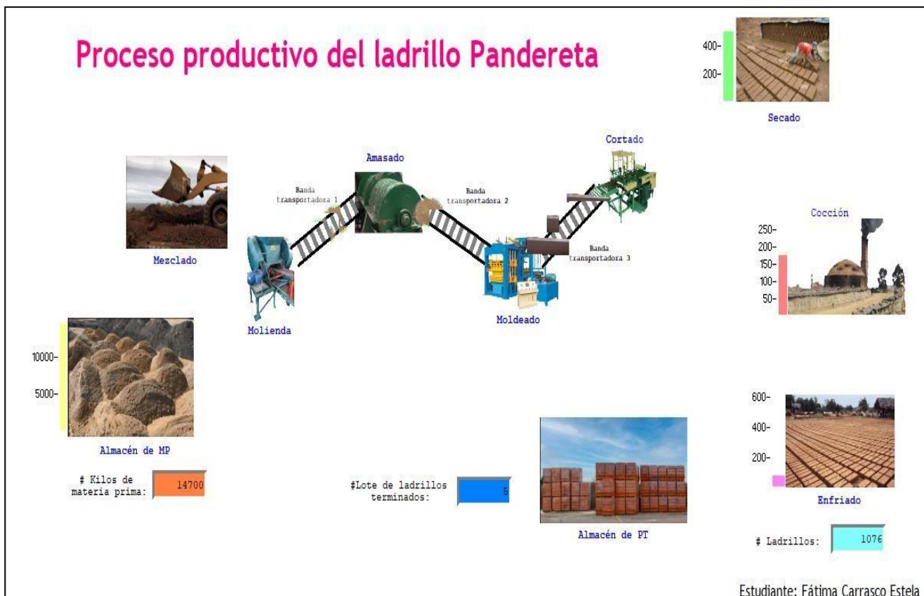
Figura 2. Simulación del Proceso Productivo del ladrillo Pandereta
