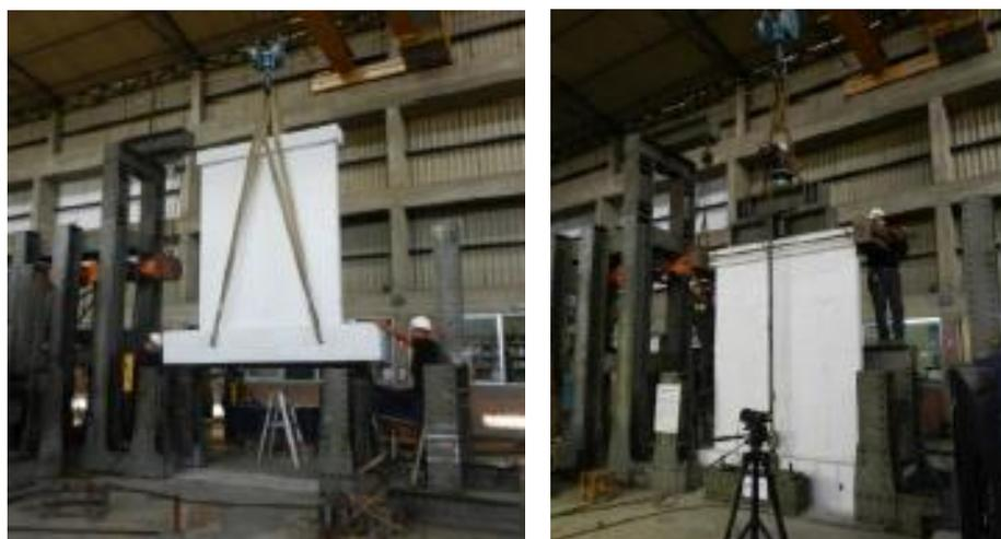
*Ilustración 35: Colocación del muro en posición de ensayo y colocación del actuador hidráulico para aplicación de la fuerza vertical.*
