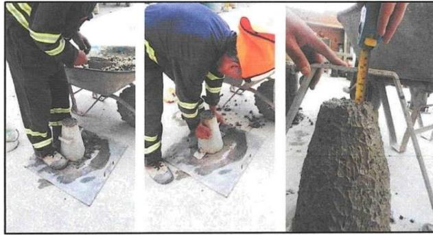
*Ilustración 12: Ensayo de medición del slump utilizando el cono de Abrams.*
