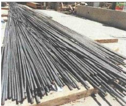
*Ilustración 4: Acero corrugado utilizado en la construcción de los especímenes*
