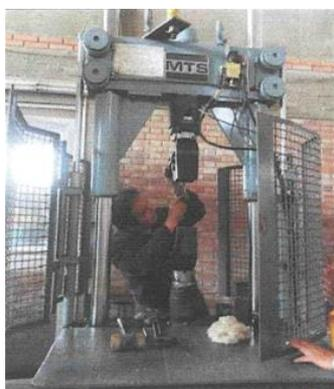
*Ilustración 6: Colocación del espécimen de 3/8'' en la Máquina Universal marca MTS equipada con mordazas de tracción.*
