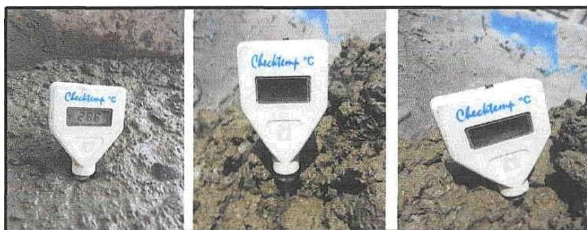
Ilustración 11: Medición de temperatura por cada tanda de mezcla correspondiente a las vigas de cimentación.
