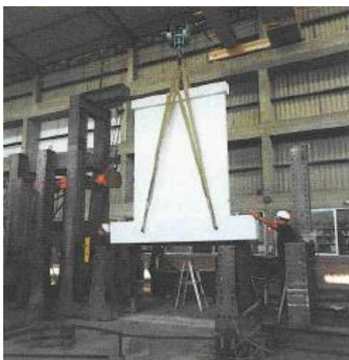
*Ilustración 34: Colocación del muro en posición de ensayo*
