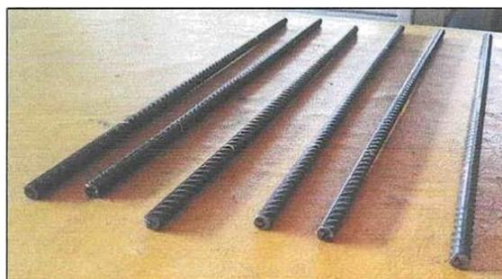
*Ilustración 5: Especímenes previo al ensayo (acero 3/8'')*
