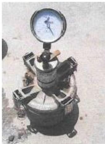
*Ilustración 13: Olla para medir el contenido de aire en concreto*
