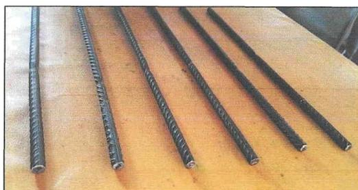
*Ilustración 7: Especímenes ensayados de 3/8''*
