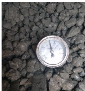
Figura 62: Valor de la temperatura de muestra con 10% de AGR.
