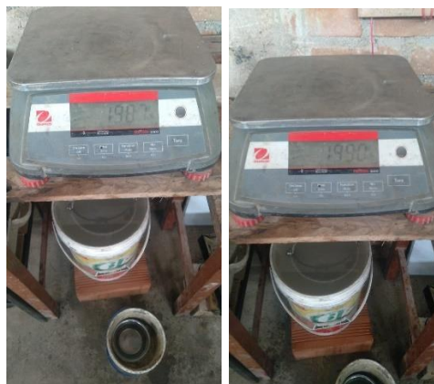
Figura 31: Peso en agua de la muestra de agregado grueso reciclado más recipiente para ambas muestras etiquetadas como muestras secas 1 y 2.
