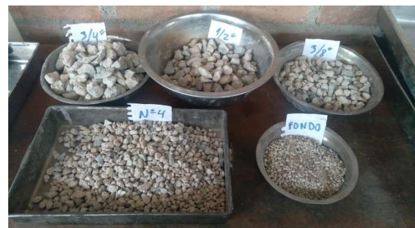
Figura 23: Resultado del proceso de separación de áridos gruesos reciclados por serie de tamices.
