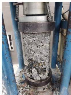
Figura 68: Fractura de lado en las bases.
