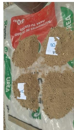
Figura 18: Cuarteo para la selección de muestra obtenida a partir de los áridos finos.
