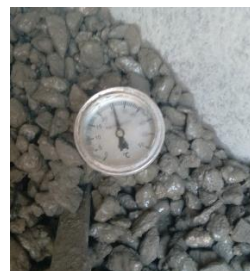
Figura 64: Valor de la temperatura de muestra con 20% de AGR.
