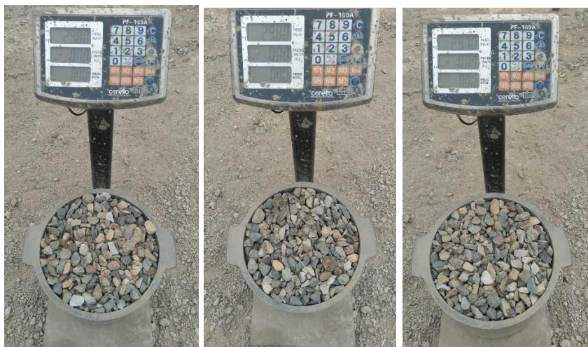
Figura 44: Peso unitario compactado de árido grueso reciclado uliginoso, más el contenedor metálico.
