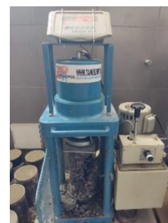
Figura 67: Rotura de una probeta a los 28 días de curado.
