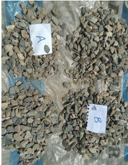
Figura 19: Cuarteo para la selección de muestra obtenida a partir de los áridos gruesos naturales.
