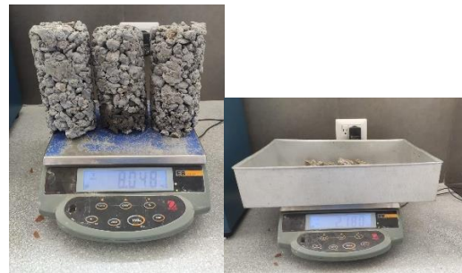
Figura 81: Abrasión de la muestra con reemplazo del 20% de AGR.
