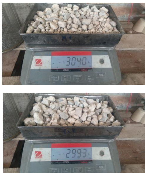
Figura 15: Peso del árido grueso reciclado en estado seco más el peso del contenedor.
