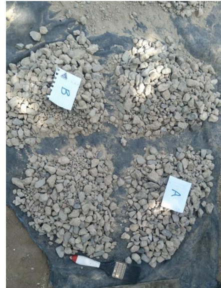
Figura 20: Cuarteo para la selección de muestra obtenida a partir de los áridos gruesos reciclados.
