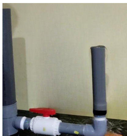
Figura 73: Ensayo de percolación a los especímenes de concreto permeable.
