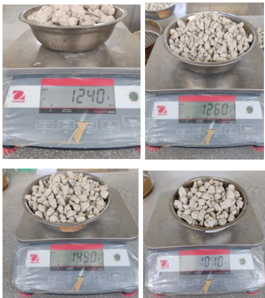
Figura 48: Proceso de lavado del agregado que no pasa el tamiz N°12.
