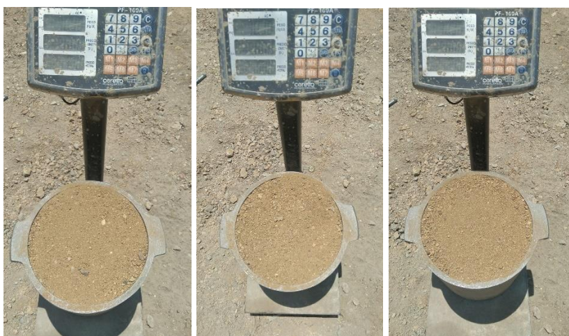
Figura 42: Peso unitario de árido fino uliginoso y suelto, más el contenedor metálico.
