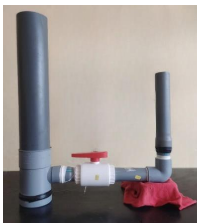
Figura 72: Permeámetro armado para la realización de ensayo de percolación.
