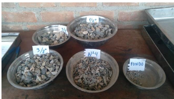
Figura 22: Resultado del proceso de separación de áridos gruesos naturales por serie de tamices.
