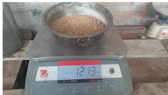
Figura 11: Peso seco de la arena más el peso del contenedor.
