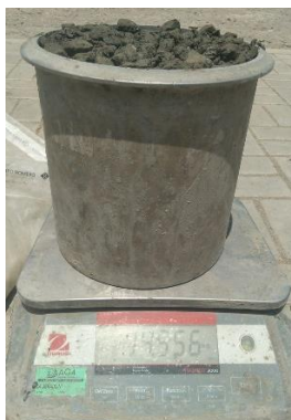
Figura 58: Peso unitario del modelo con reemplazo del 10% de AGR.
