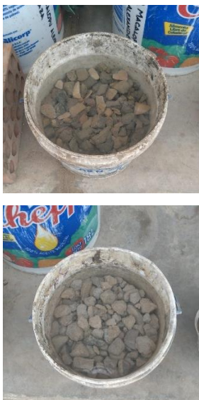
Figura 26: Peso de la muestra de agregado grueso natural en estado saturado superficialmente seco para ambas muestras etiquetadas como muestra 1 y 2.
