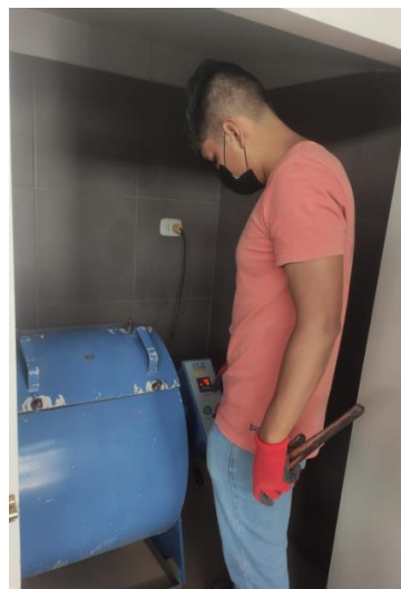
Figura 47: Utilización de la máquina de los Ángeles para ensayos de abrasión del agregado reciclado.
