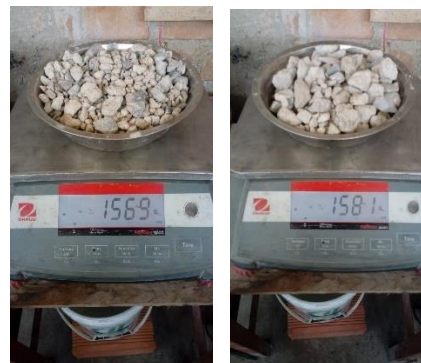
Figura 31: Peso en agua de la muestra de agregado grueso reciclado más recipiente para ambas muestras etiquetadas como muestras secas 1 y 2.
