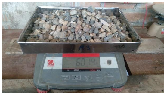
Figura 12: Peso del árido grueso natural en estado húmedo más el peso del contenedor.
