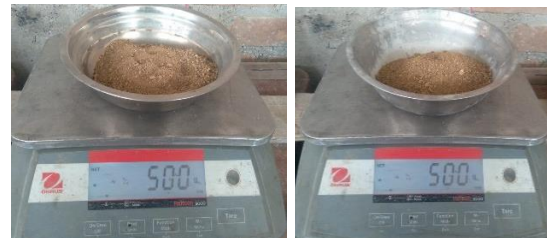
Figura 35: Pesaje del árido fino en condición saturada superficialmente seca.
