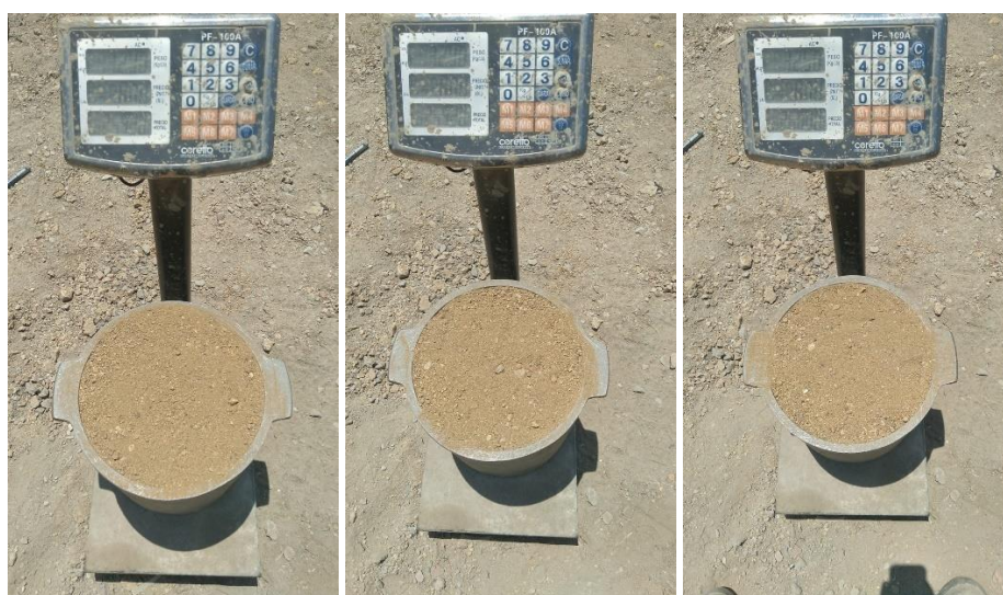
Figura 45: Peso unitario compactado de árido fino uliginoso, más el contenedor metálico.
