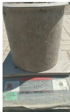
Figura 60: Peso unitario del modelo con reemplazo del 20% de AGR.
