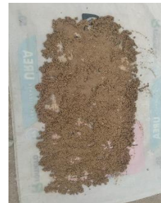
Figura 35: Pesaje del árido fino en condición saturada superficialmente seca.
