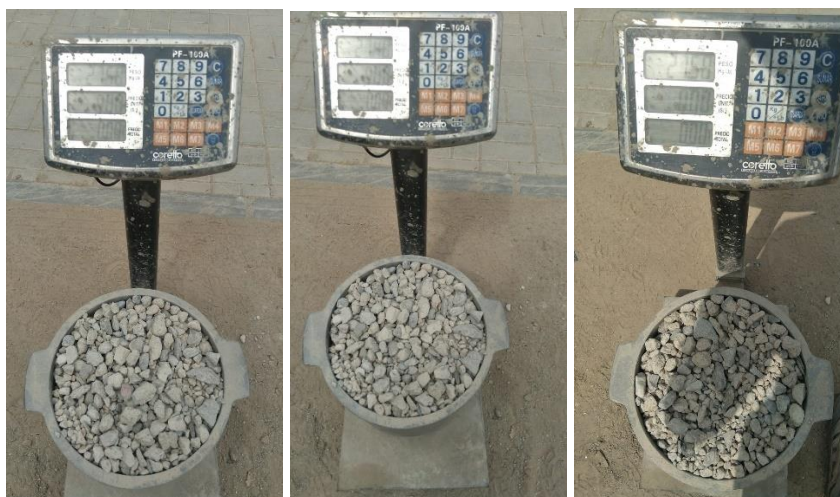
Figura 45: Peso unitario compactado de árido fino uliginoso, más el contenedor metálico.
