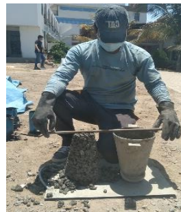
Figura 56: Medición del valor del SLUMP de la muestra con 20% de AGR.
