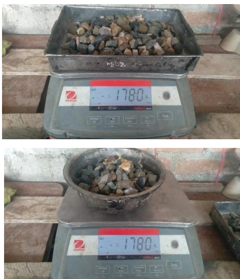
Figura 26: Peso de la muestra de agregado grueso natural en estado saturado superficialmente seco para ambas muestras etiquetadas como muestra 1 y 2.
