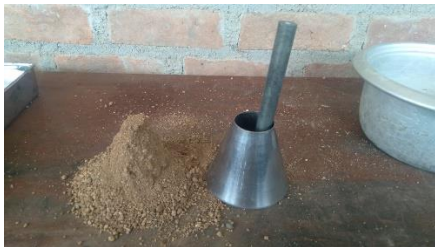
Figura 34: Comprobación de la condición saturada superficialmente seca del árido fino.
