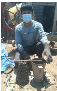
Figura 54: Medición del valor del SLUMP de la muestra con 10% de AGR.
