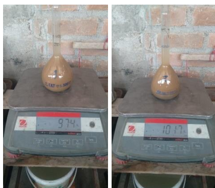
Figura 38: Peso de la muestra de agregado fino en estado saturado superficialmente seco más peso del matraz más peso del agua para ambas muestras etiquetadas como muestra 1 y 2.
