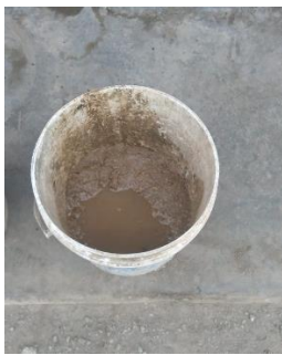
Figura 34: Comprobación de la condición saturada superficialmente seca del árido fino.
