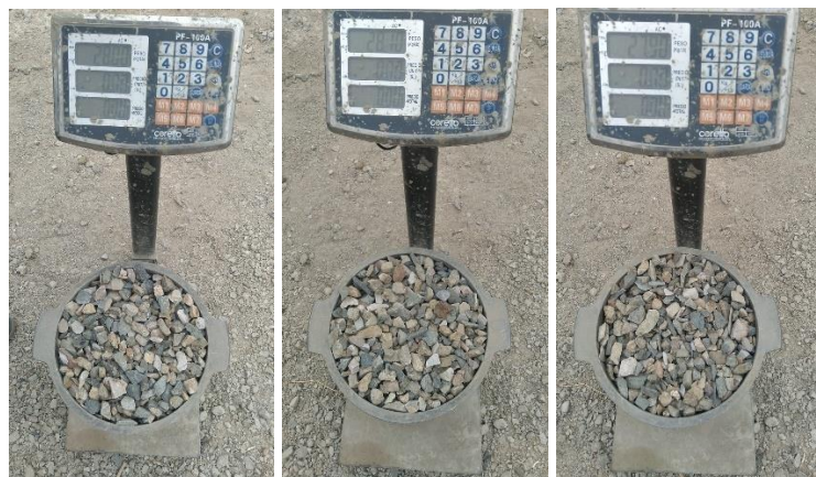
Figura 41: Peso unitario de árido grueso reciclado uliginoso y suelto, más el contenedor metálico.
