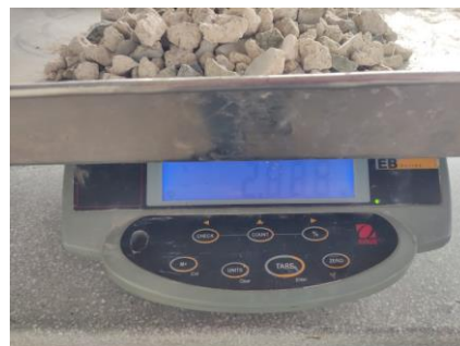
Figura 49: Peso del agregado reciclado posterior al proceso de secado al horno.
