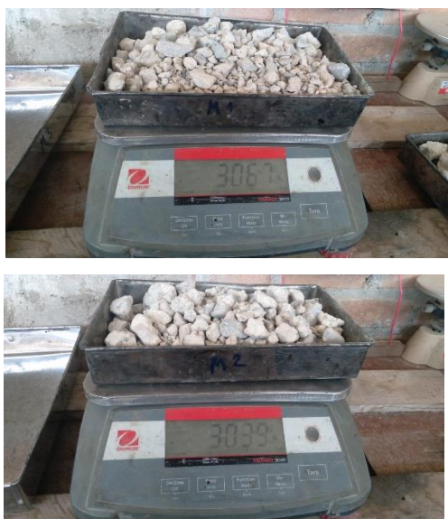
Figura 14: Peso del árido grueso reciclado en estado húmedo más el peso del contenedor.
