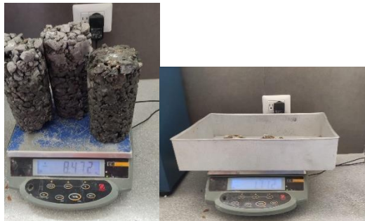
Figura 79: Abrasión de la muestra con reemplazo del 15% de AGR.
