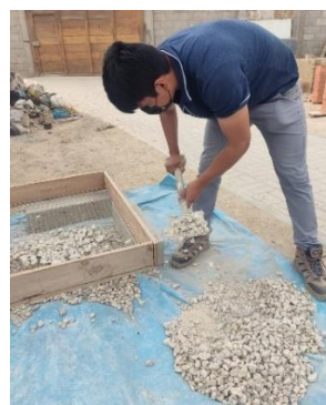
Figura 5: Tamizado de agregado triturado proveniente de residuos de concreto.
