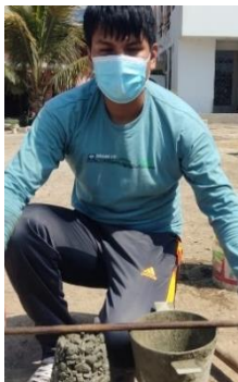
Figura 54: Medición del valor del SLUMP de la muestra con 10% de AGR.
