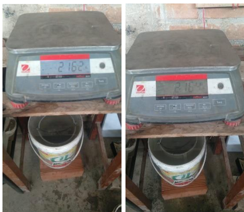
Figura 30: Peso en agua de la muestra de agregado grueso natural más recipiente para ambas muestras etiquetadas como muestras secas 1 y 2.
