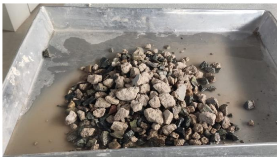
Figura 48: Proceso de lavado del agregado que no pasa el tamiz N°12.
