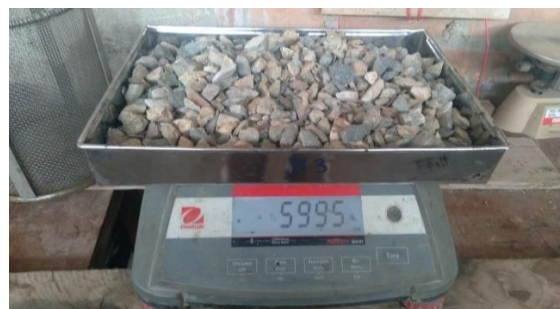
Figura 13: Peso del árido grueso natural en estado seco más el peso del contenedor.
