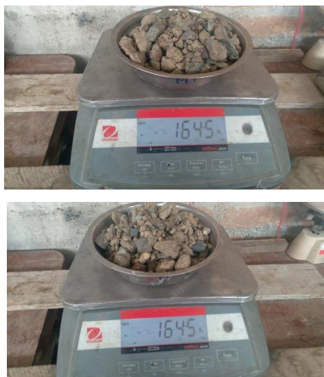
Figura 27: Peso de la muestra de agregado grueso reciclado en estado saturado superficialmente seco para ambas muestras etiquetadas como muestra 1 y 2.
