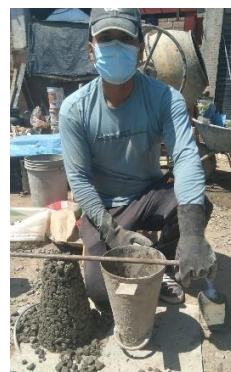
Figura 56: Medición del valor del SLUMP de la muestra con 20% de AGR.
