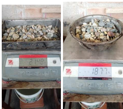
Figura 30: Peso en agua de la muestra de agregado grueso natural más recipiente para ambas muestras etiquetadas como muestras secas 1 y 2.
