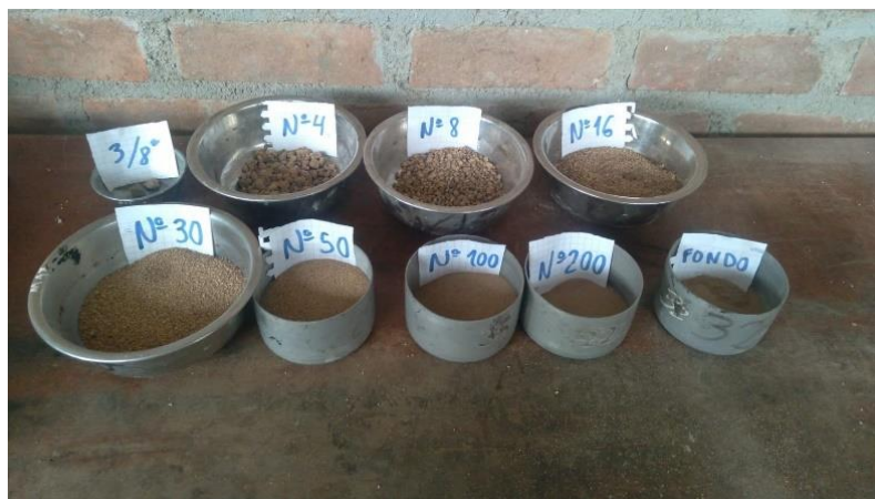
Figura 21: Resultado del proceso de separación de áridos finos naturales por serie de tamices.
