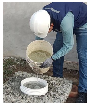
Figura 77: Colocación de agua para ensayo de permeabilidad.
