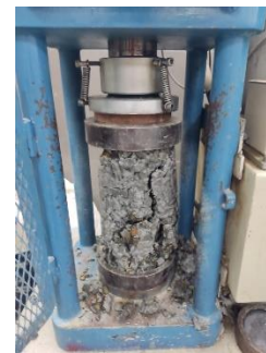
Figura 70: Grietas columnares verticales.
