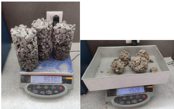
Figura 78: Abrasión de la muestra patrón.
