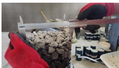
Figura 65: Medición del diámetro de una probeta de concreto permeable.
