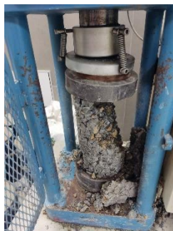
Figura 69: Fractura diagonal sin grietas en la base.
