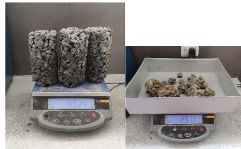
Figura 80: Abrasión de la muestra con reemplazo del 10% de AGR.
