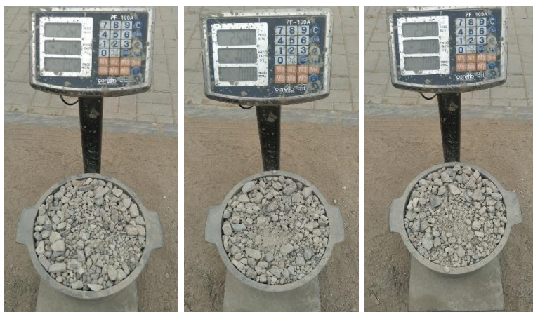
Figura 42: Peso unitario de árido fino uliginoso y suelto, más el contenedor metálico.
