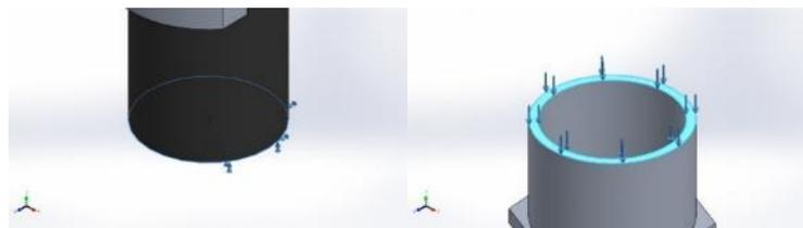
Figura 55: Geometría fija y sentido de la carga
