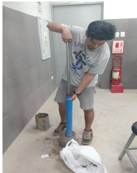
Foto 68: Compactando por capas (5ta capa)
