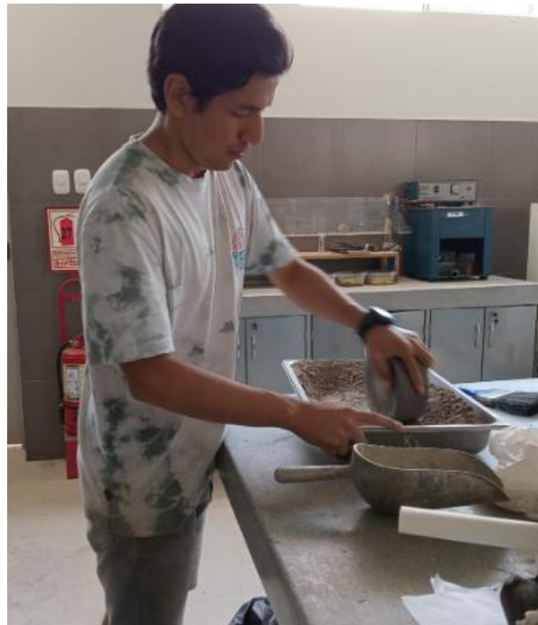
Foto 53: Compactado los trozos de arcilla con disco de acero
