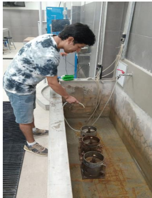
Foto 87: Se llenó de agua la parte superior del molde
