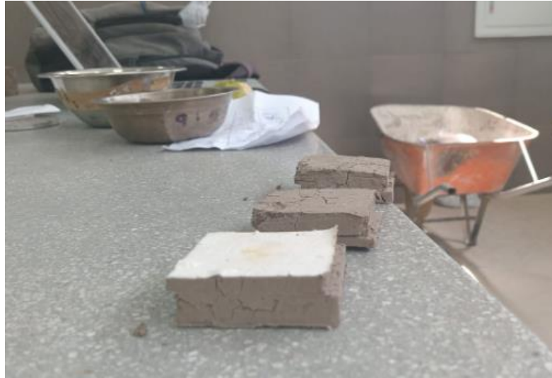
Foto 126: Muestras por esfuerzo cortante y normal
