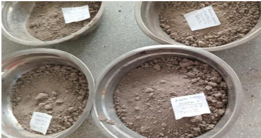
Foto 13: Muestra seca por 24 horas
