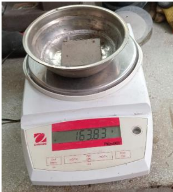
Foto 120: Peso de la muestra saturada - tallador 17
