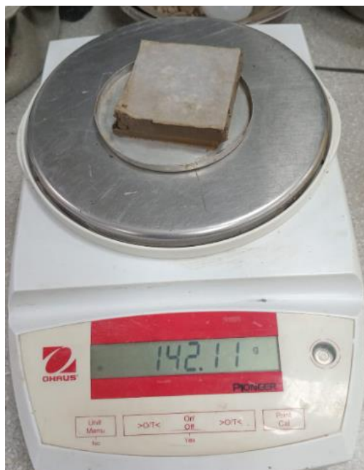
Foto 125: Peso seco de la muestra - tallador 18
