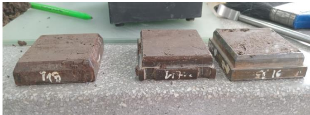
Foto 100: Enrasado de la muestra en los tres talladores
