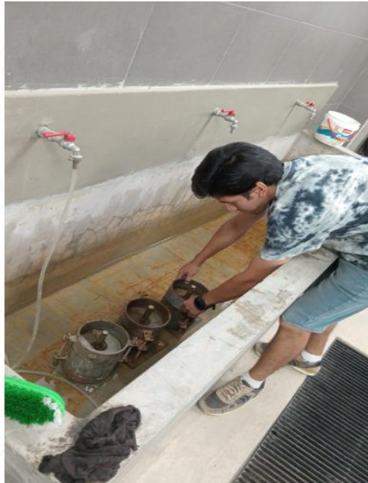
Foto 86: Sumergió al agua los moldes
