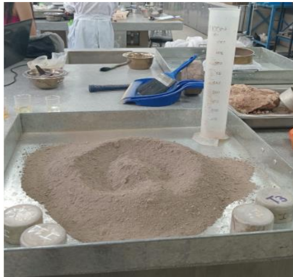
Foto 62: Muestra esparcida en bandeja y el graduador de agua
