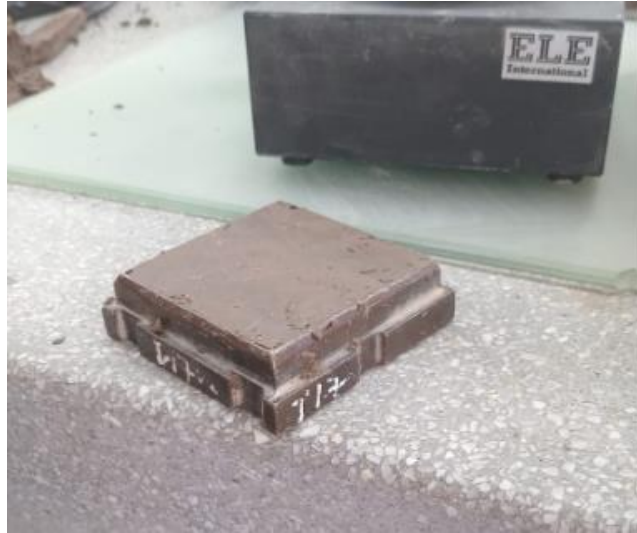
Foto 99: Enrasado de la muestra en el tallador parte superior
