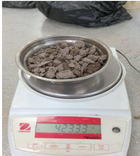
Foto 101: Peso de la muestra húmeda más tara
