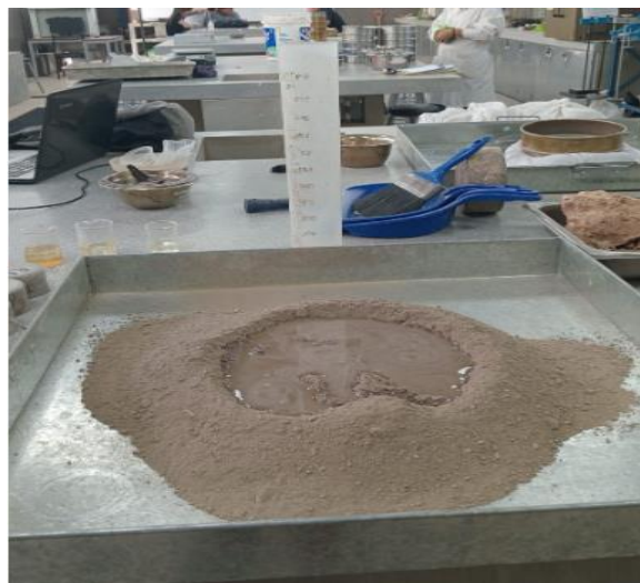
Foto 63: Muestra esparcida en bandeja con agua
