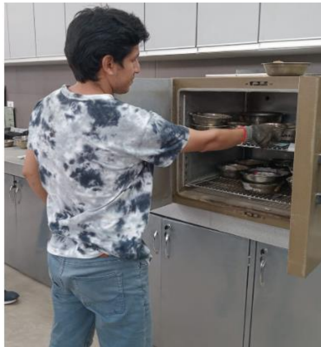
Foto 102: Peso de la muestra húmeda al horno
