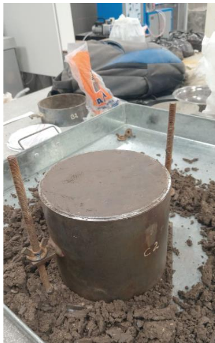
Foto 78: Enrasado de la muestra en el molde
