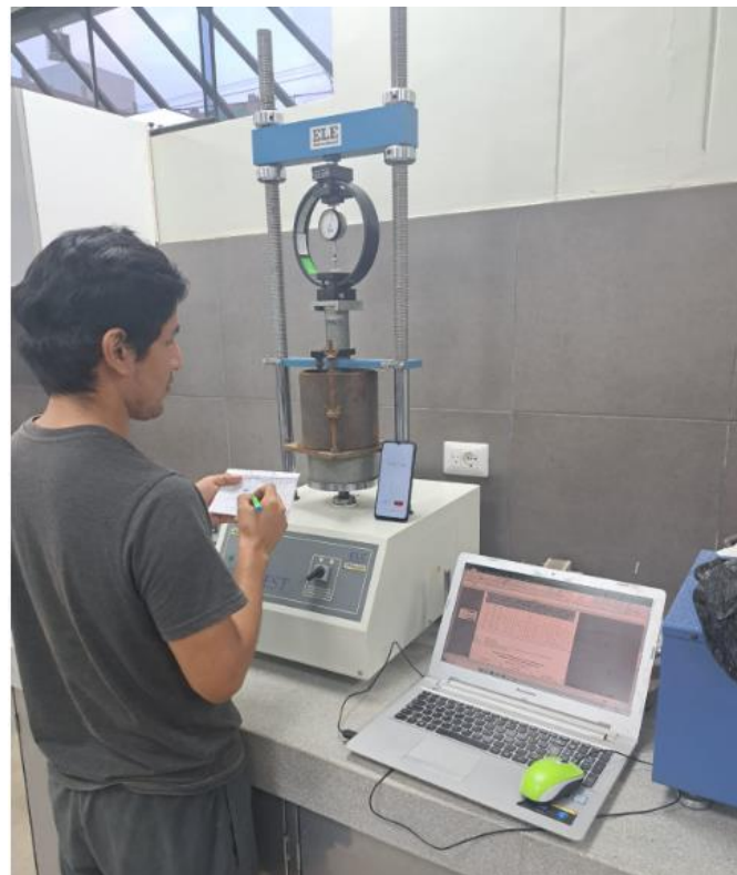
Foto 91: Lectura en la máquina de CBR
