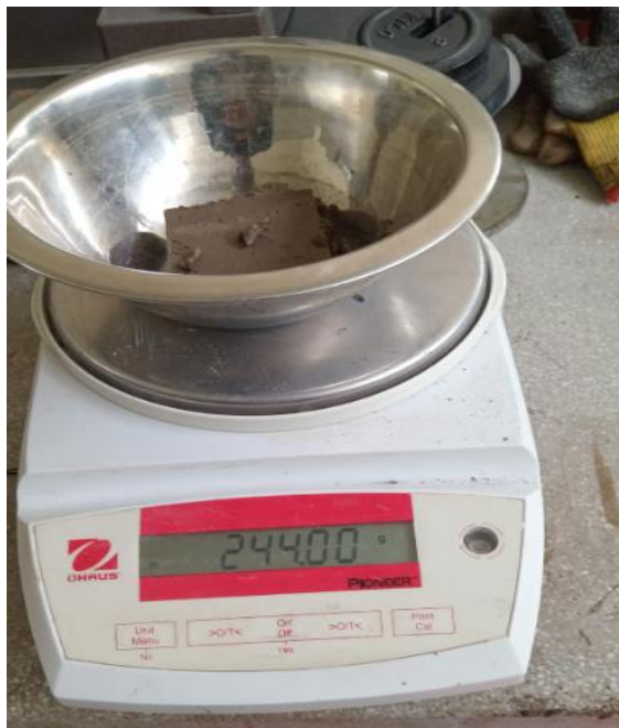
Foto 118: Peso de la muestra saturada - tallador 16
