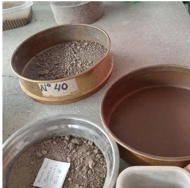
Foto 09: Una parte de la muestra tamiz 40
