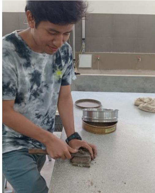
Foto 97: Enrasado de la muestra en el tallador
