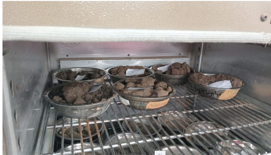
Foto 06: Muestra inalterada natural en el horno
