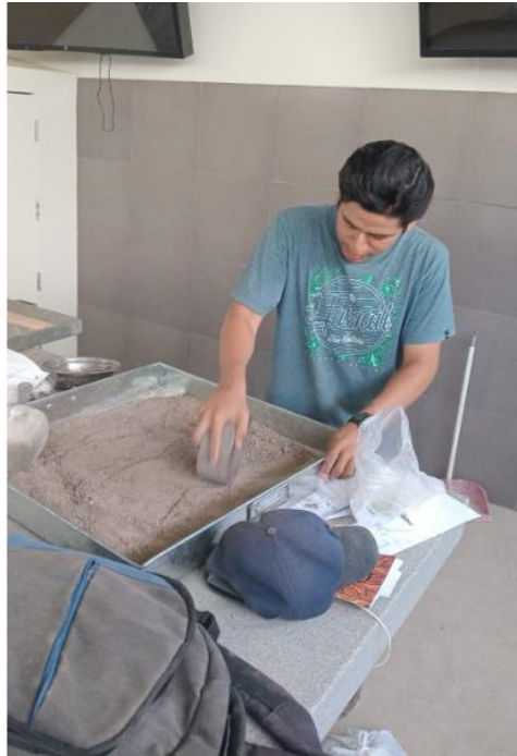
Foto 72: Compactando la muestra para el ensayo CBR
