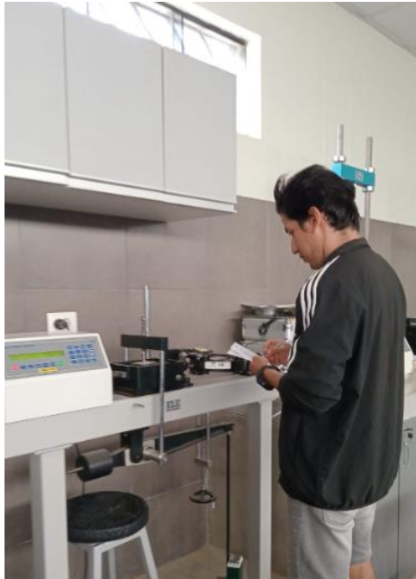
Foto 114: Lectura del dial y del reloj de anillo de corte
