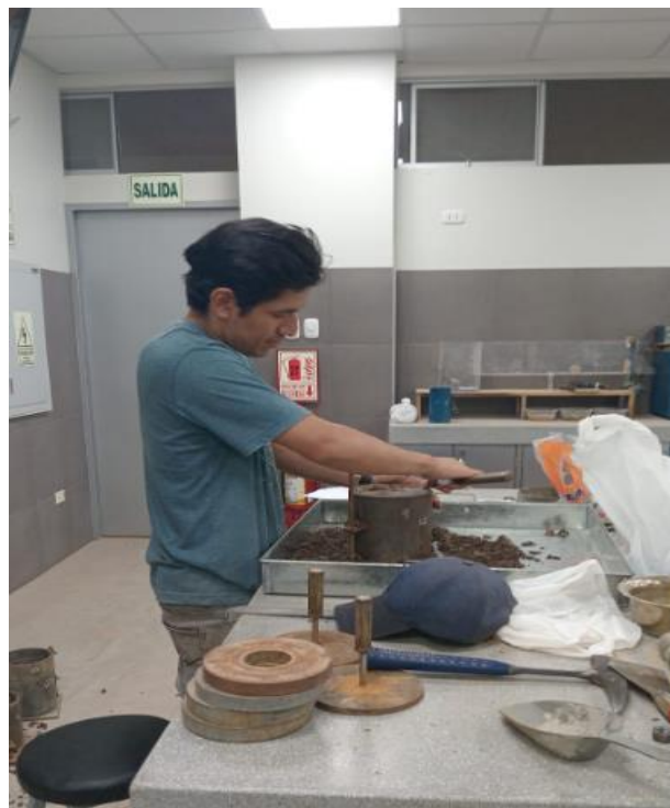
Foto 77: Enrasado de la muestra en el molde
