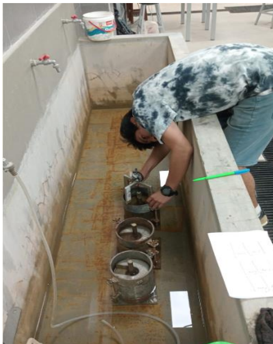
Foto 88: Medición de expansión de los moldes por 24 horas (4días)
