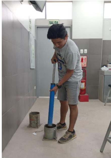
Foto 67: Compactando por capas (1era capa)
