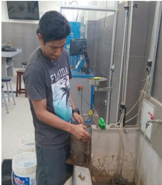
Foto 89: Sacando de la poza de agua la muestra contenida en el molde de CBR
