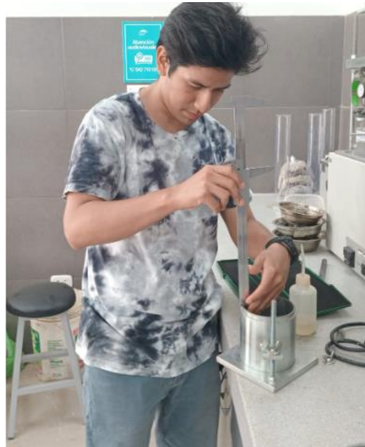
Foto 59: Dimensiones del molde con la herramienta Vernier
