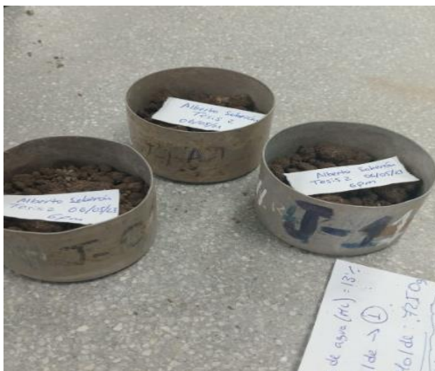
Foto 73: Tres muestras con 13% de humedad
