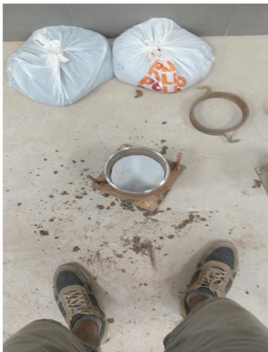
Foto 76: Molde con disco de acero y papel filtro (para compactar)
