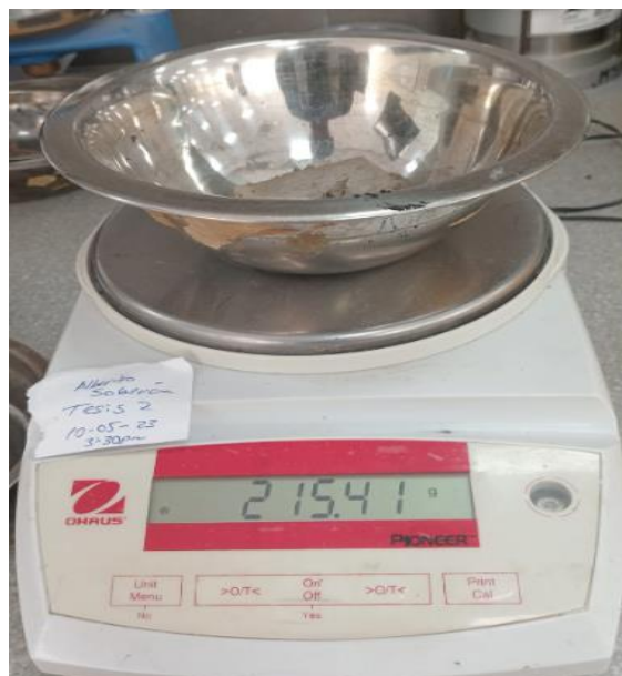
Foto 123: Peso seco de la muestra - tallador 16
