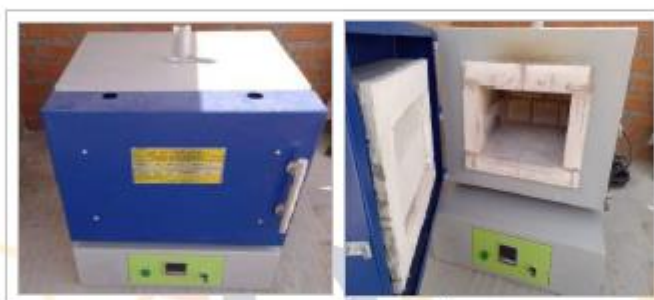
FIGURA N°1: MUFLA USADA EN LA CALCINACIÓN CONTROLADA
