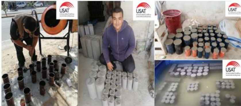
Imagen 16: Proceso de Elaboración de probetas de concreto
