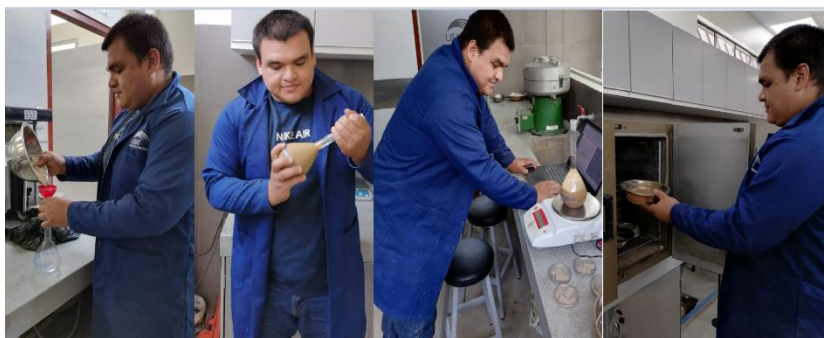
Imagen 13: Proceso del ensayo del peso específico y Absorción del agregado Fino
