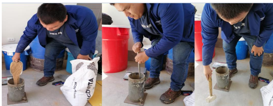
Imagen 14: Proceso del ensayo del Pesos Unitario Suelto y compactado del Agregado Fino y Grueso
