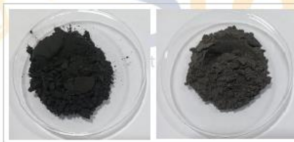
FIGURA N°2: MUESTRA ANTES Y DESPUES DE LA CALCINACIÓN
