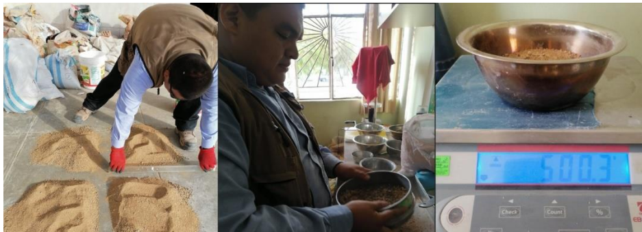
Imagen 11: Proceso del ensayo de Análisis granulométrico del agregado Fino
