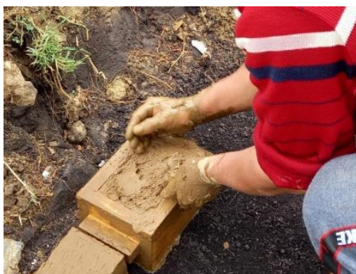
Figura 39. Fabricación de adobes de prueba
