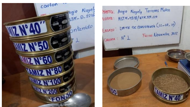
Figura 22. Tamizado de la muestra por la malla N°40
