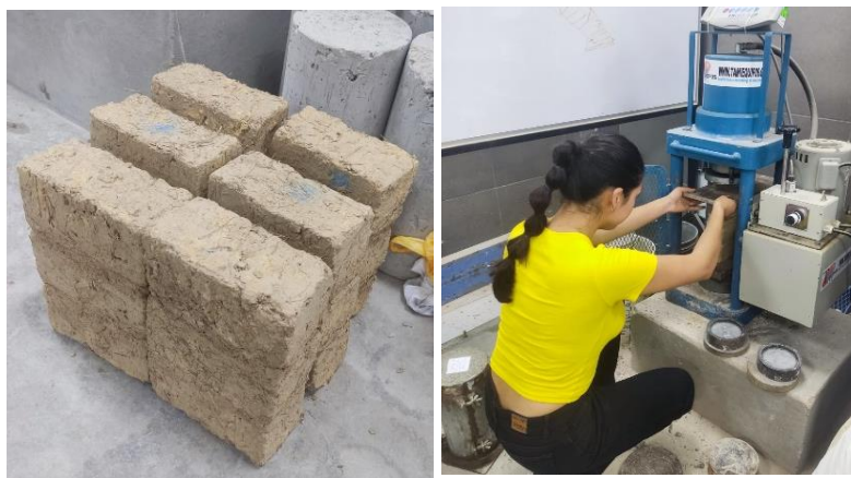
Figura 55. Colocación de pilas en la máquina compresora.
