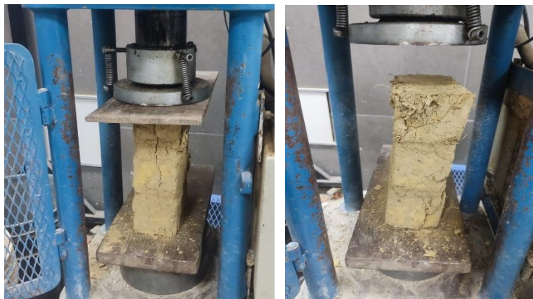
Figura 56. Rotura de pilas sometidas a compresión.
