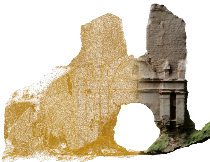
Figura No. 21 Nube de puntos y ortofoto de la fachada de la iglesia San Francisco de Zaña, Cosmopolis, Serquen (Zaña, 2021).
