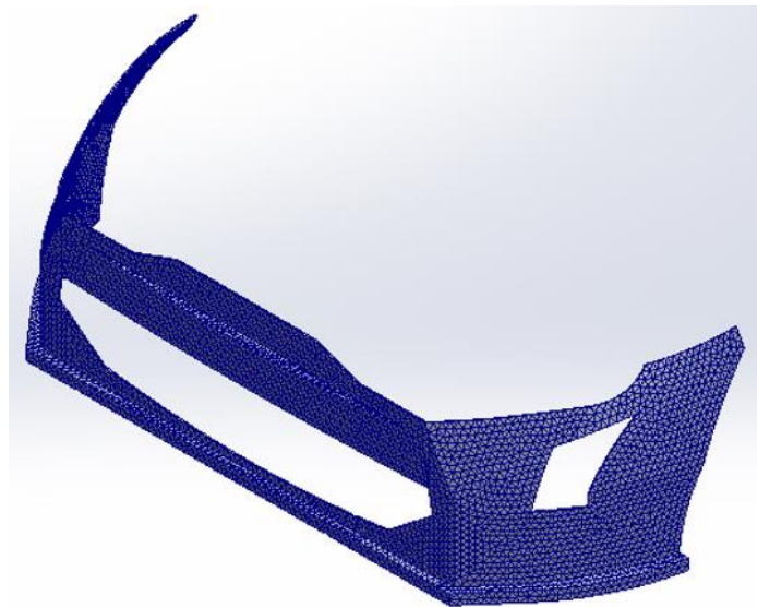
Ilustración 10. Mallado del parachoques (Kenaf/Epoxi) a 4 km/h
