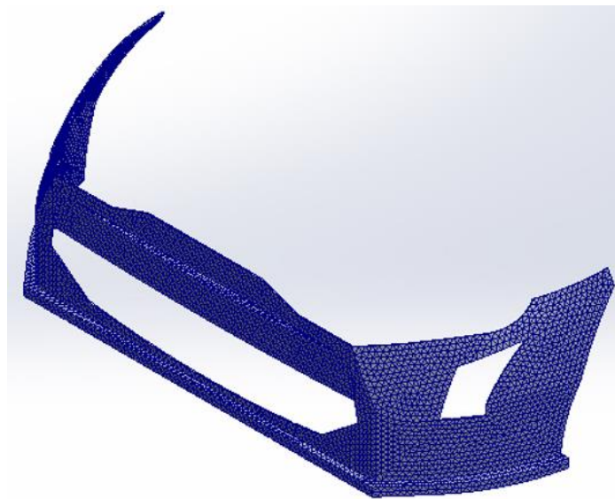
Ilustración 6. Mallado del parachoques (Jute/Epoxi) a 4 km/h
