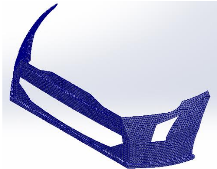
Ilustración 18. Mallado del parachoques (Jute/Epoxi) a 56 km/h
