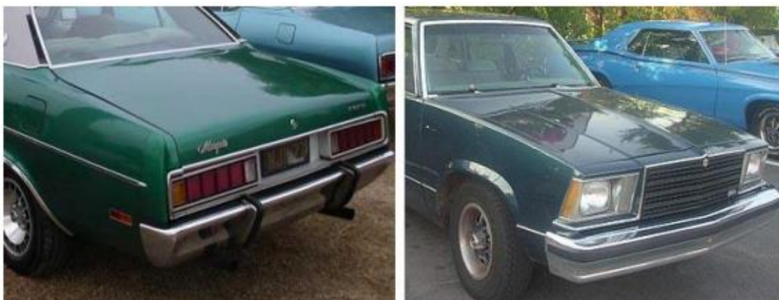
Figura 3. Parachoques americano basado en el estándar FMVSS.
