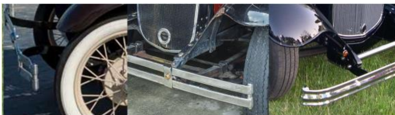
Figura 1. Parachoques contruidos por barra de acero.
