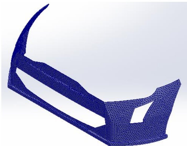
Ilustración 14. Mallado del parachoques (Sisal/Epoxi) a 4 km/h
