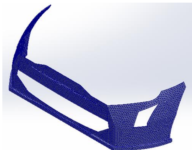
Ilustración 26. Mallado del parachoques (Sisal/Epoxi) a 56 km/h
