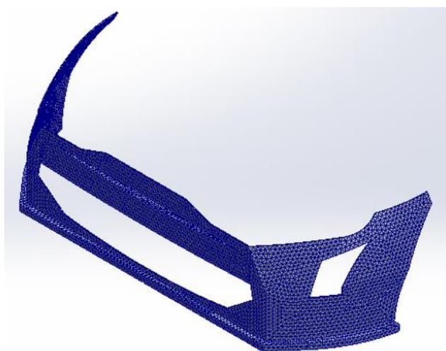
Ilustración 22. Mallado del parachoques (Kenaf/Epoxi) a 56 km/h
