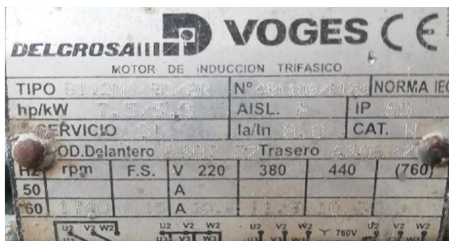
Fig. 66: Datos del motor del ventilador empleado en la mesa de prelimpiado.
