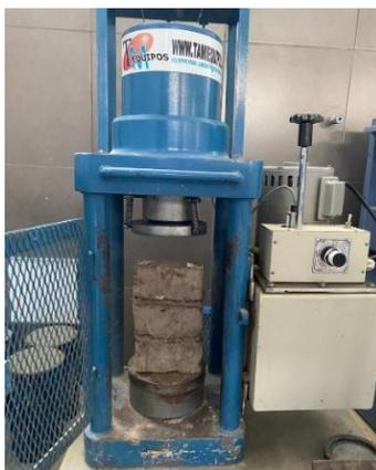
*Fig 38: Ensayo de resistencia del murete a la compresión*
