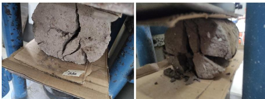
*Fig 16: Falla característica en las unidades cilíndricas de 6"x12"*
