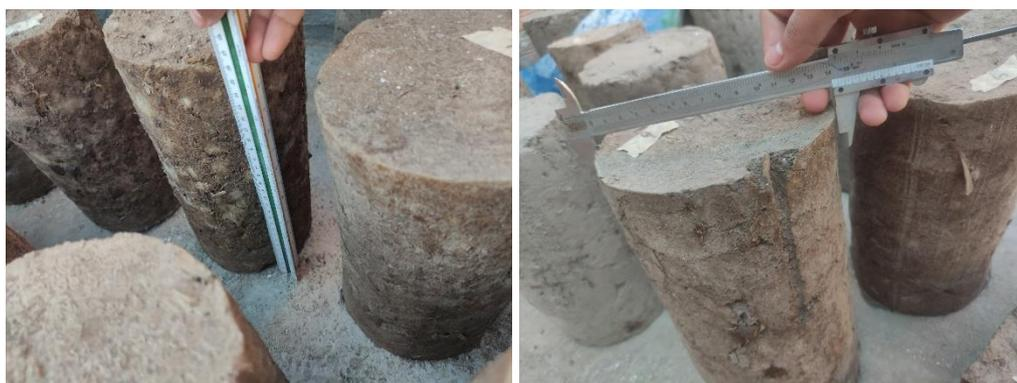
*Fig 24: Medición dimensional de las unidades de tierra reforzada usadas en el ensayo del material tierra a la tracción*
