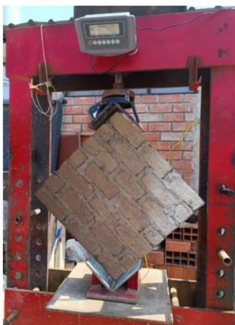
*Fig 22: Ensayo de tracción indirecta del murete*
