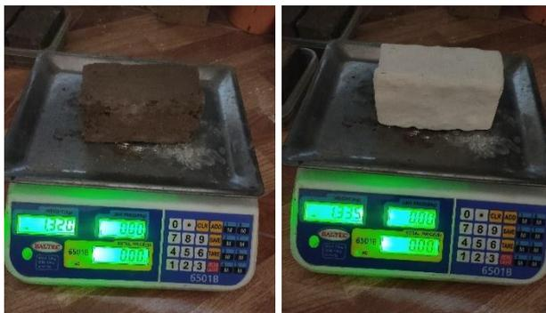
*Fig 33: Pesaje de las unidades de tierra reforzada en estado seco*
