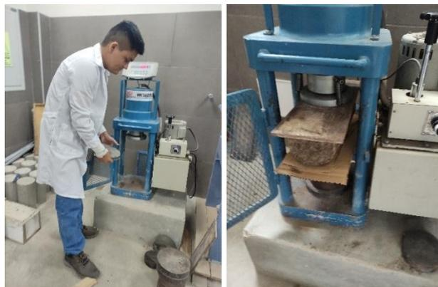
*Fig 28: Preparación de la máquina de compresión de la Universidad Católica Santo Toribio de Mogrovejo para el ensayo del material tierra a tracción*
