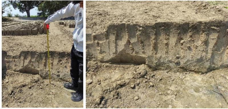
*Fig 8: Obtención de la muestra del suelo*
