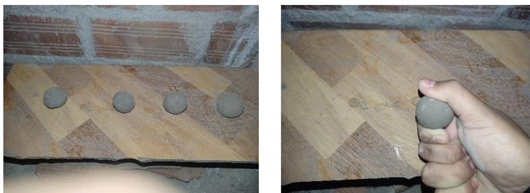
*Fig 11: Prueba "Presencia de arcilla" o "Resistencia seca"*
