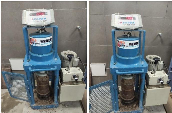
*Fig 26: Compresión de las unidades de tierra reforzada de 0.10 m de arista - Ensayo resistencia del material tierra a la compresión*
