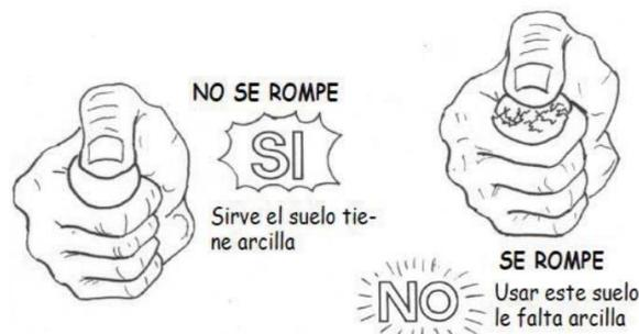
*Fig 3: Prueba “Presencia de arcilla” o “Resistencia seca” – Aplastamiento de bolitas [19]*
