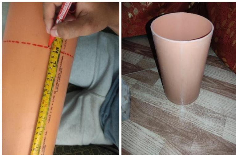
*Fig 21: Molde usado en la elaboración de unidades de tierra reforzada de 6" × 12"*
