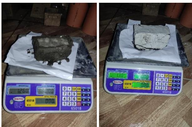
*Fig 35: Pesaje de las unidades de tierra reforzada en condición saturada*
