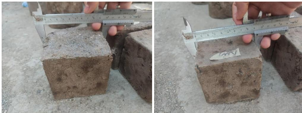
*Fig 23: Medición dimensional de las unidades de tierra reforzada usadas en el ensayo del material tierra a la compresión*
