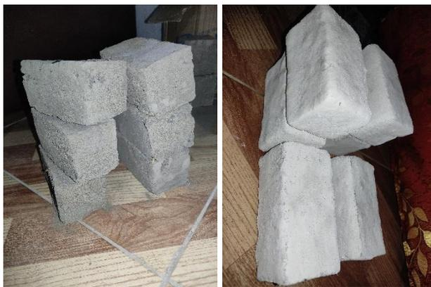
*Fig 18: Unidades de tierra reforzada del grupo control y experimental para ser ensayadas en el ensayo adaptado de absorción*
