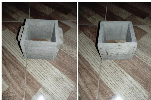
*Fig 20: Molde usado en la elaboración de unidades de tierra reforzada de 0.10m*
