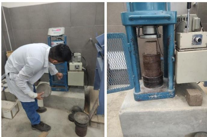
*Fig 25: Preparación de la máquina de compresión de la Universidad Católica Santo Toribio de Mogrovejo para el ensayo del material tierra a compresión*
