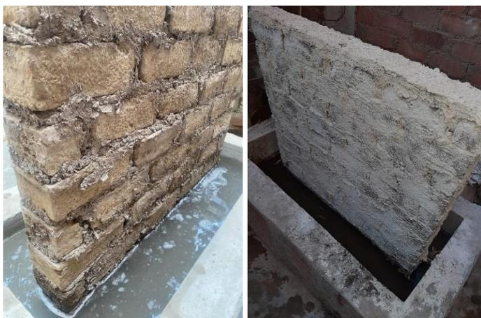
*Fig 23: Inundación simulada del murete*
