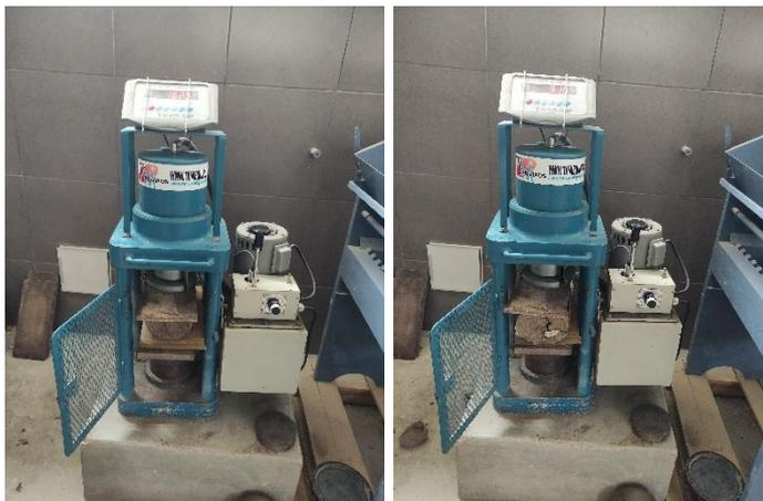
*Fig 29: Compresión de las unidades de tierra reforzada cilíndricas de 6"x12"- Ensayo resistencia del material tierra a la tracción*
