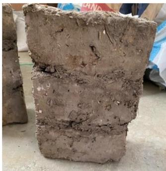
*Fig 20: Murete propuesto para ser ensayado a compresión*
