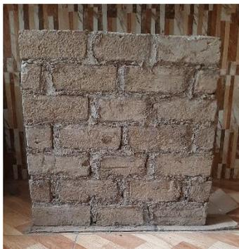
*Fig 21: Murete propuesto para ser ensayado a tracción indirecta*
