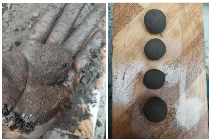
*Fig 14: Prueba "Presencia de arcilla" o "Resistencia seca"*
