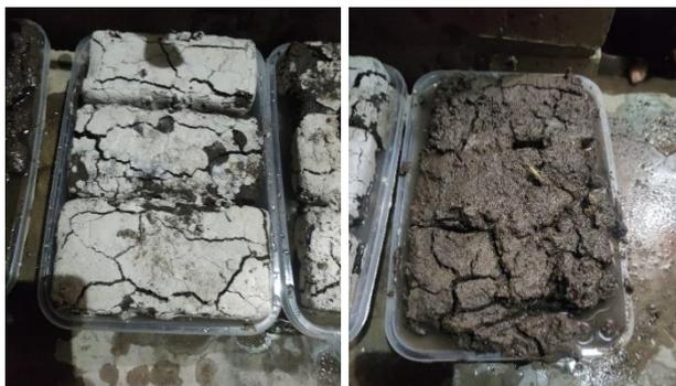
*Fig 36: Deshacimiento de las unidades de tierra reforzada en condición saturada*
