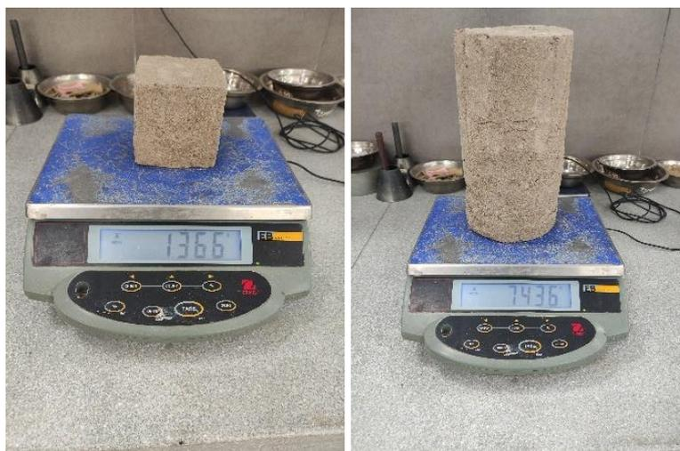
*Fig 13: Pesaje de las unidades de prueba*
