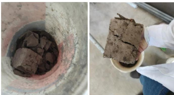
*Fig 27: Unidades de tierra reforzada de 0.10 m de arista del grupo control y experimental tras ser ensayadas*
