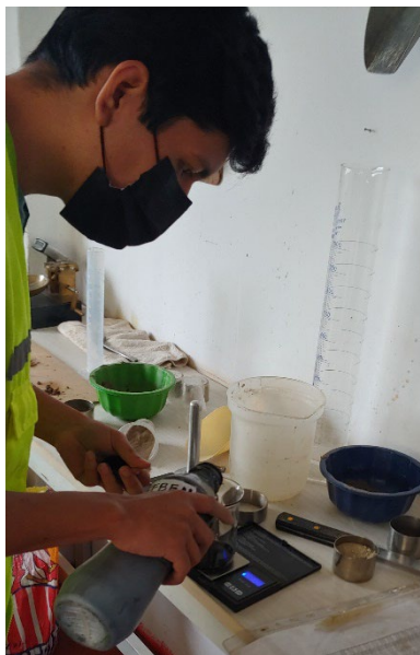
Figura 27. Medición en peso de dosificación AggreBind
