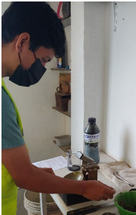
Figura 14. Ensayo de Límite de Atterberg más aditivo AggreBind (2, 4 y 6 lt/m 3 )
