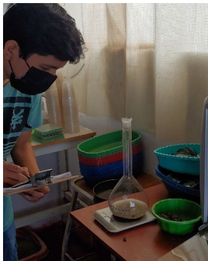
Figura 20. Muestra de Suelo vertido en la matriz
