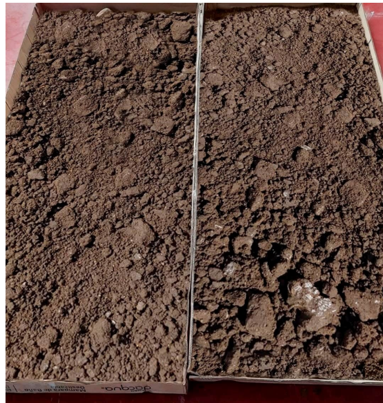
Figura 13. Secado de la muestra sobre un área limpia
