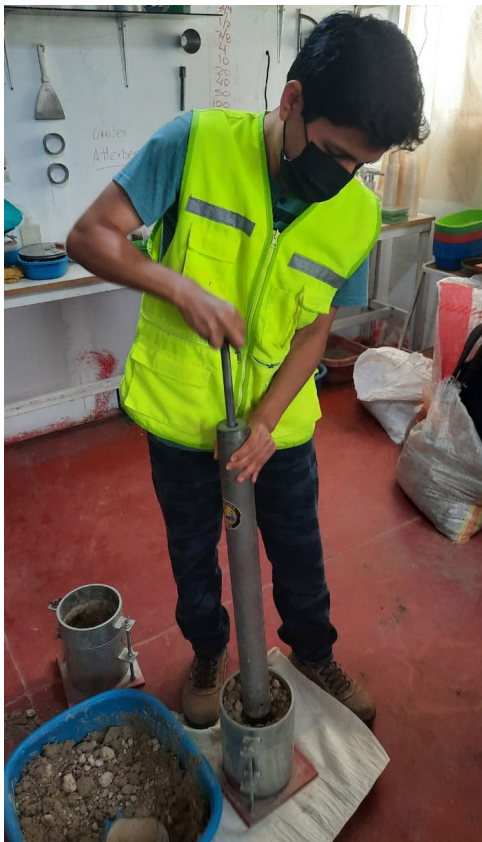
Figura 17. Compactación de la muestra de suelo
