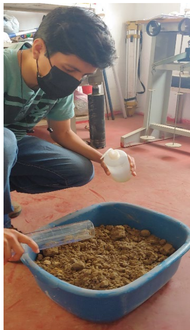
Figura 22. Elaboración de los especímenes de prueba para ensayo CBR
