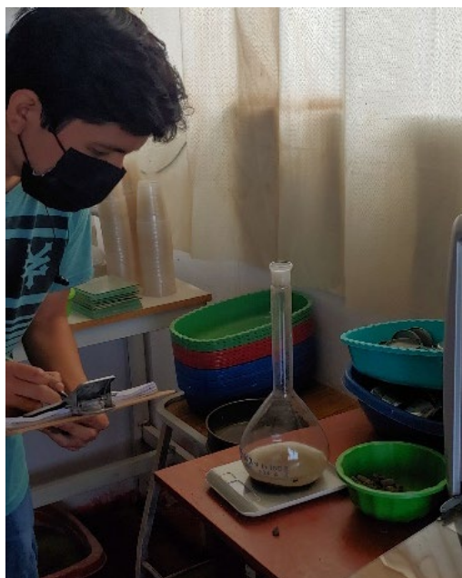
Figura 16. Muestra de Suelo vertido en la matriz
