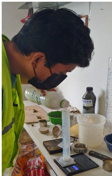
Figura 19. Determinación en peso de la cantidad de aditivo MaxxSeal 200 (2, 4 y 6lt/m 2 )
