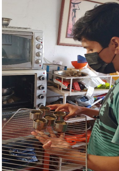
Figura 16. Muestra de cada calicata llevadas al horno
