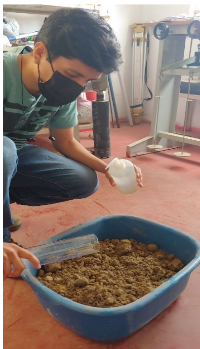
Figura 20. Preparación de los especímenes de prueba para ensayo CBR
