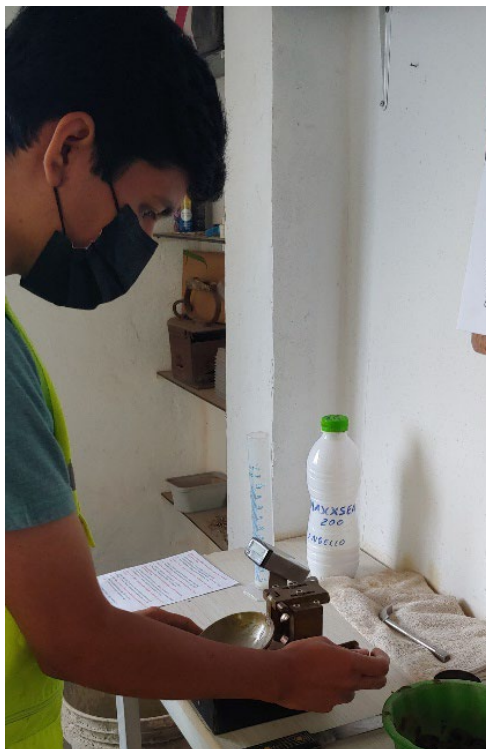
Figura 15. Ensayo de Límite de Atterberg más aditivo MaxxSeal 200 (2, 4 y 6 lt/m 2 )
