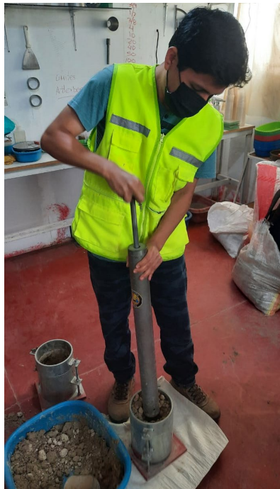
Figura 21. Compactación de la muestra de suelo
