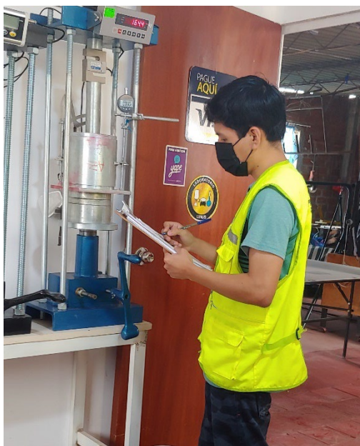
Figura 23. Penetración del espécimen de prueba más aditivo AggreBind (2, 4 y 6lt/m 3 )
