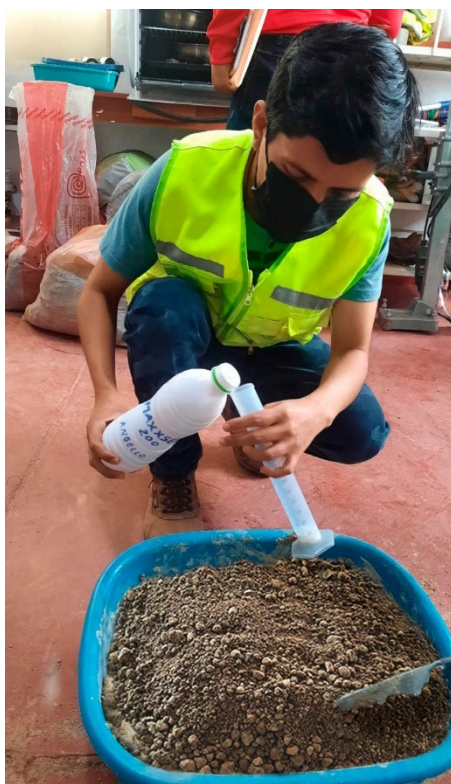
Figura 24. Mezcla de la muestra más aditivo MaxxSeal 200 (2, 4 y 6lt/m 2 )
