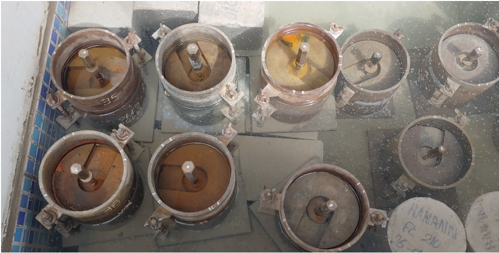
Figura 21. Moldes de ensayo sumergido en la poza con agua
