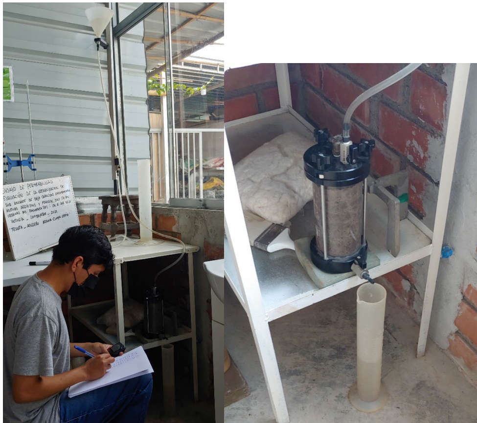
Figura 25. Medición del espécimen de prueba en el ensayo de permeabilidad
