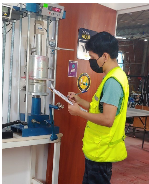
Figura 28. Penetración del espécimen de prueba más estabilizante AggreBind
