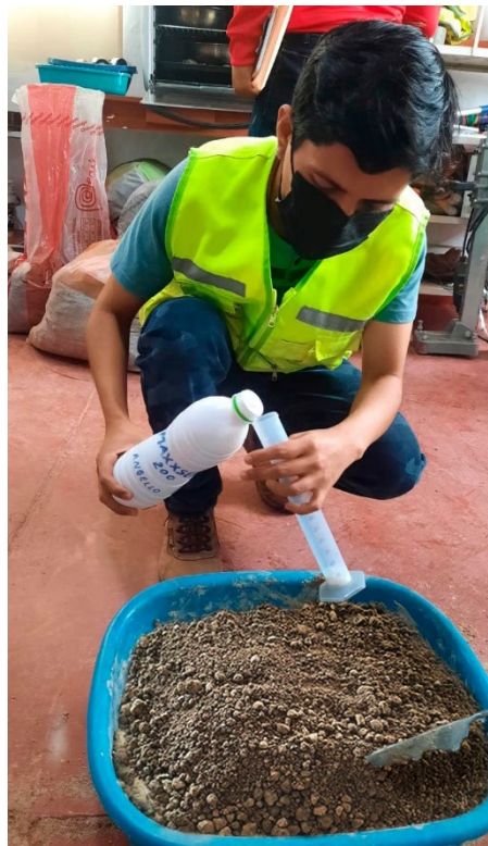
Figura 31. Mezcla de la muestra más estabilizante MaxxSeal 200
