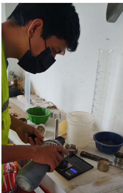
Figura 18. Determinación en peso de la cantidad de aditivo AggreBind (2, 4 y 6lt/m 3 )
