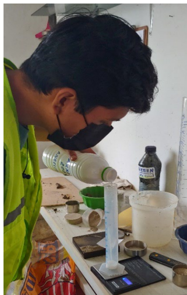
Figura 30. Medición en peso de dosificación MaxxSeal 200
