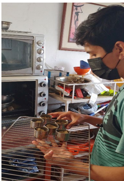
Figura 10. Muestra de cada calicata llevadas al horno
