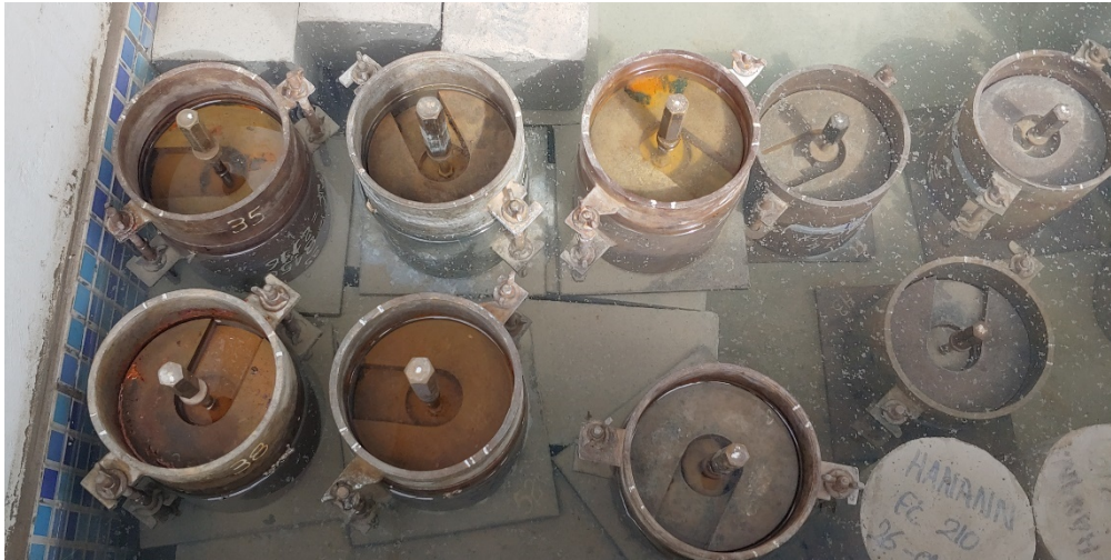
Figura 23. Moldes de ensayo sumergido en la poza con agua
