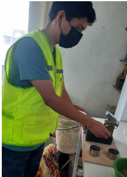
Figura 18. Ensayo de Límite Líquido en la Copa Casagrande
