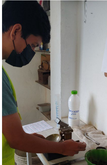
Figura 29. Ensayo de Límite de Atterberg más estabilizante MaxxSeal 200
