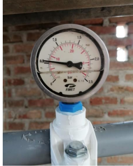
Anexo 1. Manómetros indicando presiones en el tubo de Venturi.
