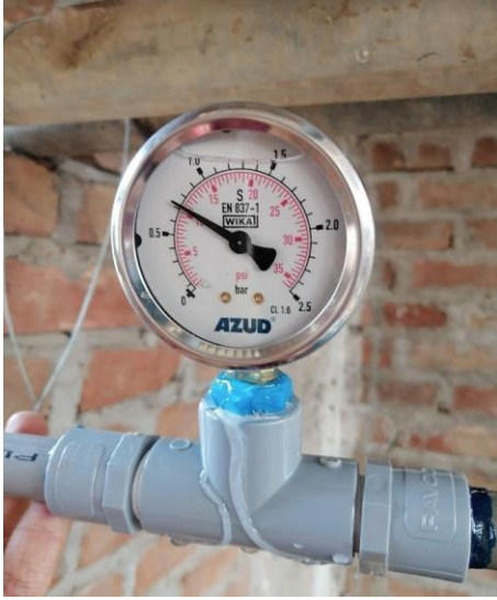
Anexo 1. Manómetros indicando presiones en el tubo de Venturi.
