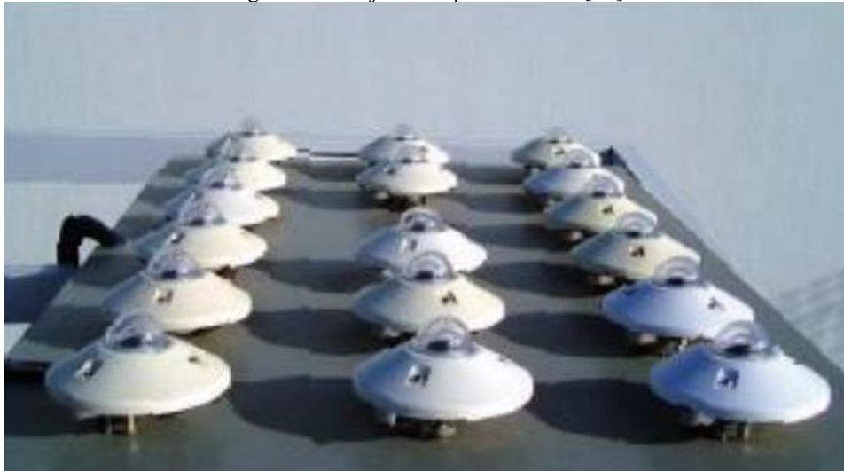
Figura 12. Conjunto de piranómetros [38].
