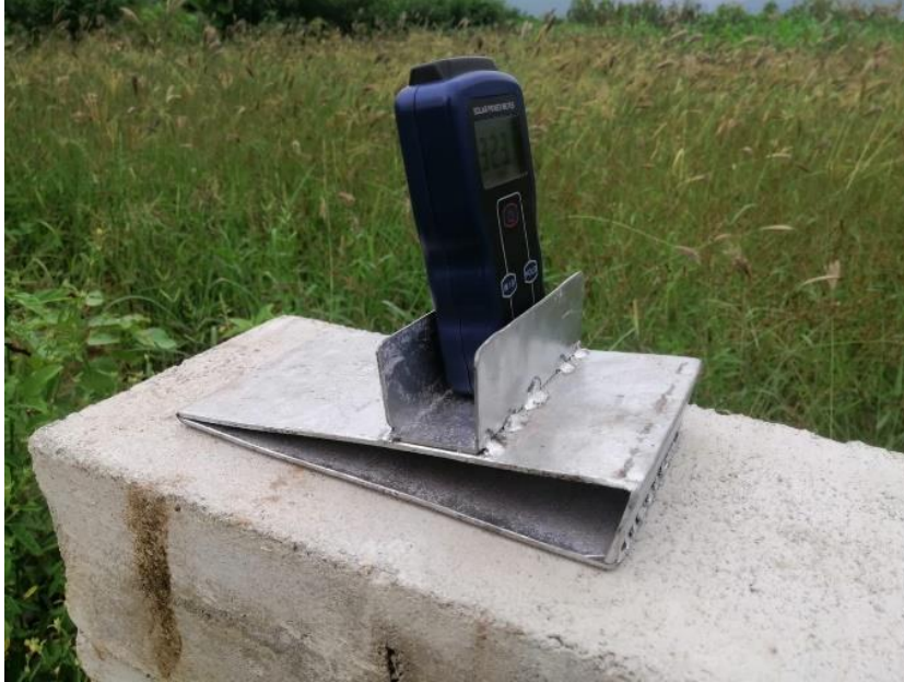
Figura 55. Medidor SM206 – SOLAR en una superficie inclinada de 8°.
