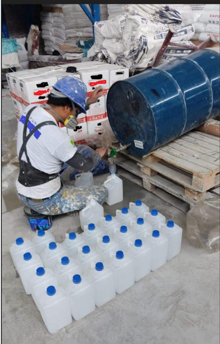
Foto 2 Actualmente se trasega con un equipo agravedad y de trasmision cerrada
