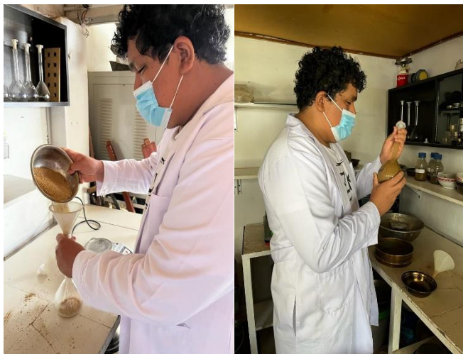
Ilustración 16: Colocación del agregado fino y eliminando vacíos de este.
