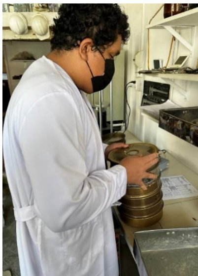
Ilustración 9: Proceso de tamizado
