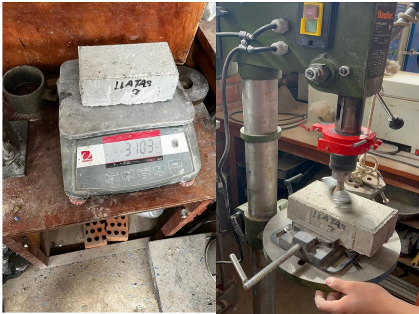
Ilustración 25: Proceso de la prueba de Resistencia al Desgaste por Abrasión.
