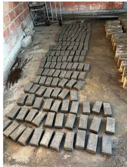
Ilustración 40: Curado de Adoquines
