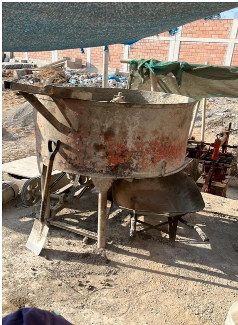
Ilustración 35: Mezcladora de Concreto de Bandeja Plana Eléctrica
