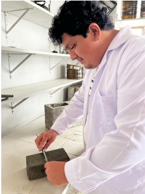
Ilustración 45: Medición de la muestra para ensayar.
