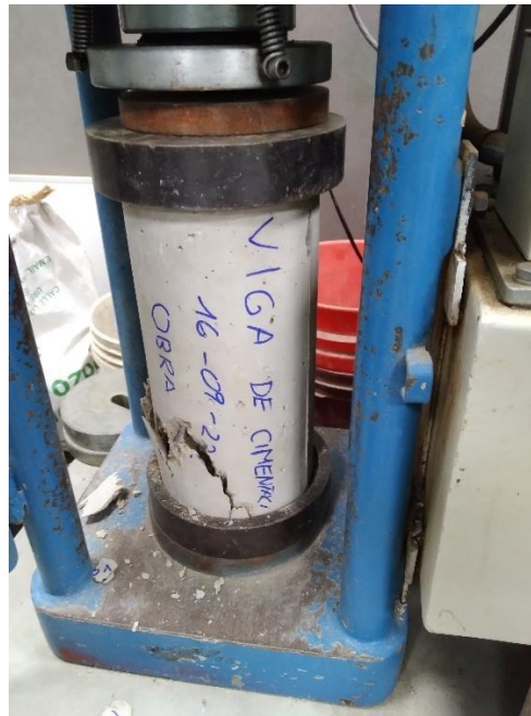
Ilustración 49: Análisis de tipo de rotura de probeta
