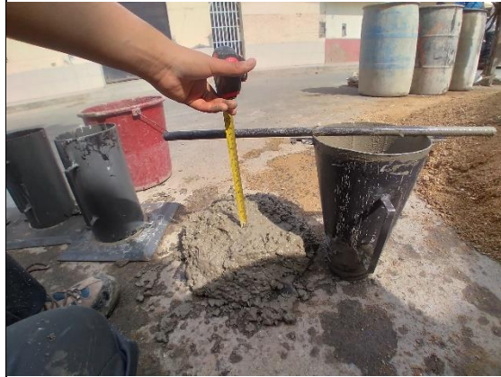
Ensayo de Asentamiento
