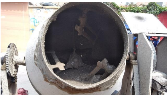
Trompo utilizado en obra
