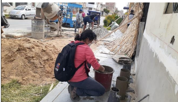
Realización de probetas y asentamiento
