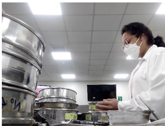
Ilustración 11: Realización de tamizado para análisis granulométrico
