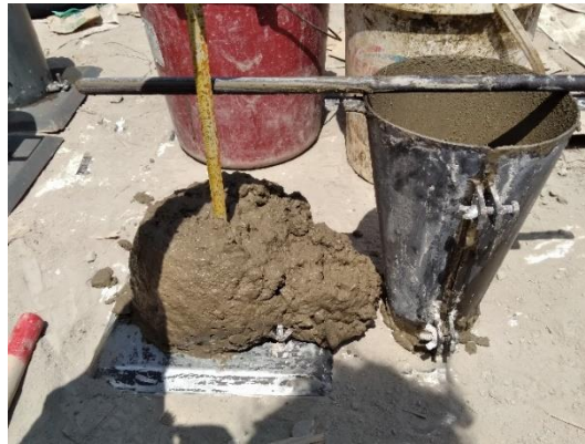
Ilustración 42: Asentamiento de la obra N°06.
