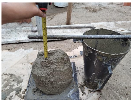
Ilustración 39: Asentamiento de la obra N°03.
