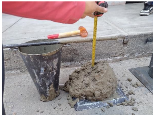
Ilustración 43: Asentamiento de la obra N°07.
