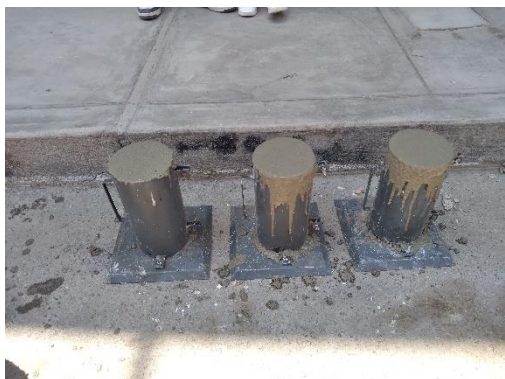
Realización de probetas y asentamiento
